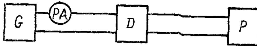
*G*—генератор тока; *РА*—измеритель тока; *D*—прибор, у которого измеряют выходное сопротивление; *P*—измеритель сопротивления
