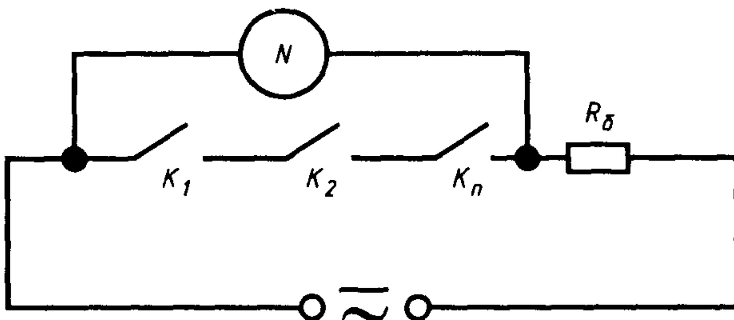
$N$  — индикатор;  $R_\delta$  — балластный резистор;  $K_1, K_2, \dots, K_n$  — контакты выключателя проверяемых резисторов
