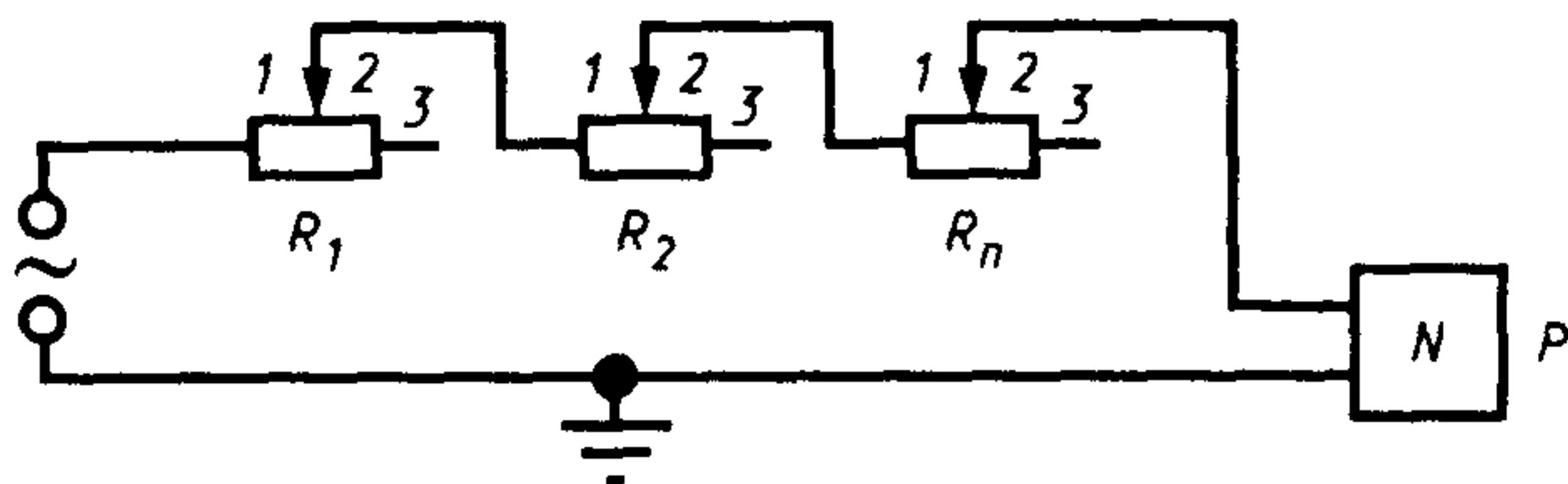
$R_1, R_2, \dots, R_n$  — проверяемые резисторы;  $P$  — осциллограф; 1, 2, 3 — выводы проверяемых резисторов
