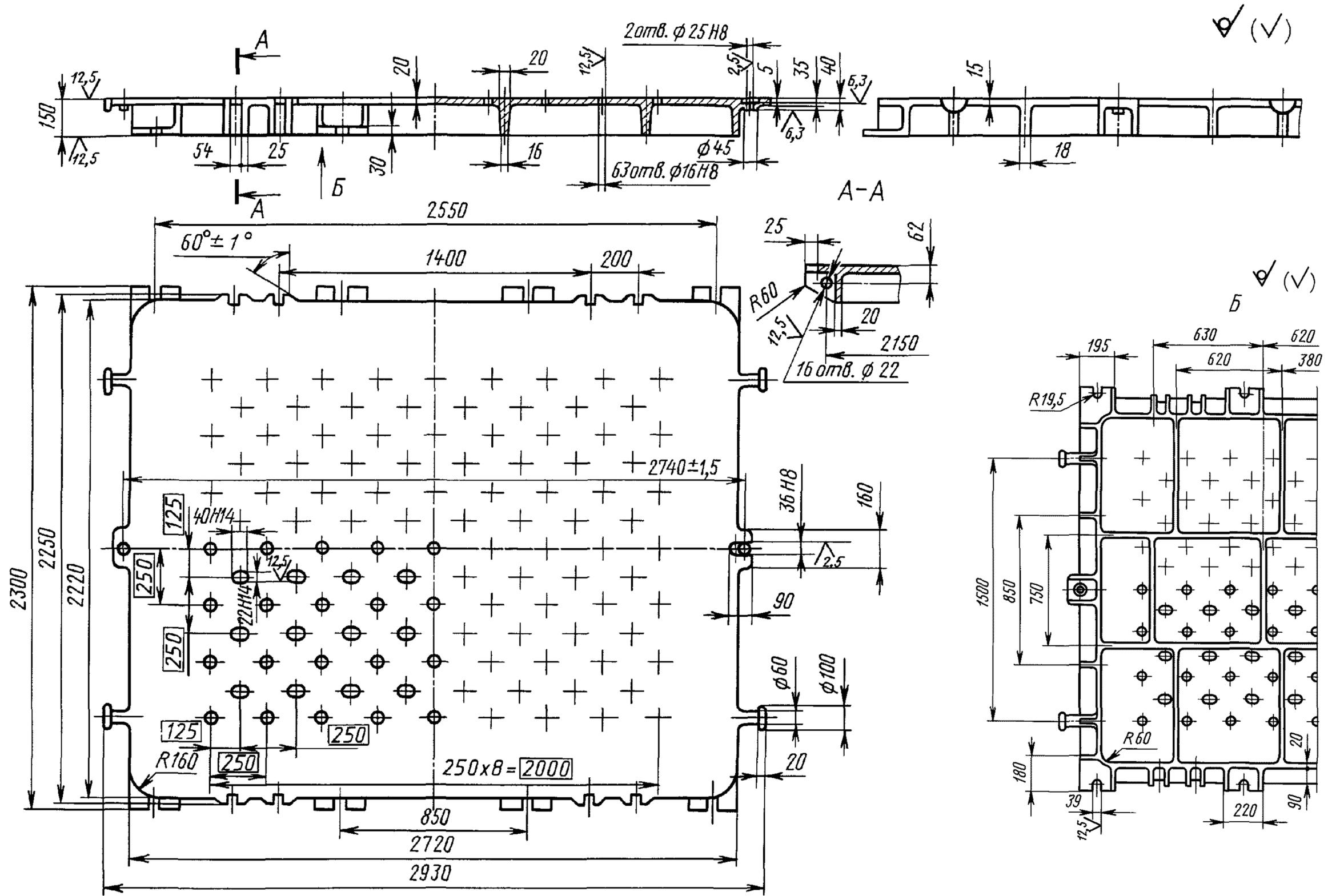
1. Овальные отверстия в координатной модельной плите (пример 2) предназначены для крепления моделей болтовым креплением по ГОСТ 22475.
