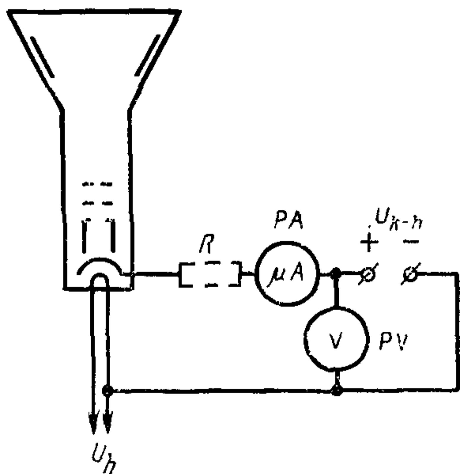
$U_{k-h}$  — источник напряжения катод-подогреватель;  $U_h$  — источник напряжения накала;  $PV$  — вольтметр;  $PA$  — микроамперметр;  $R$  — защитный резистор
