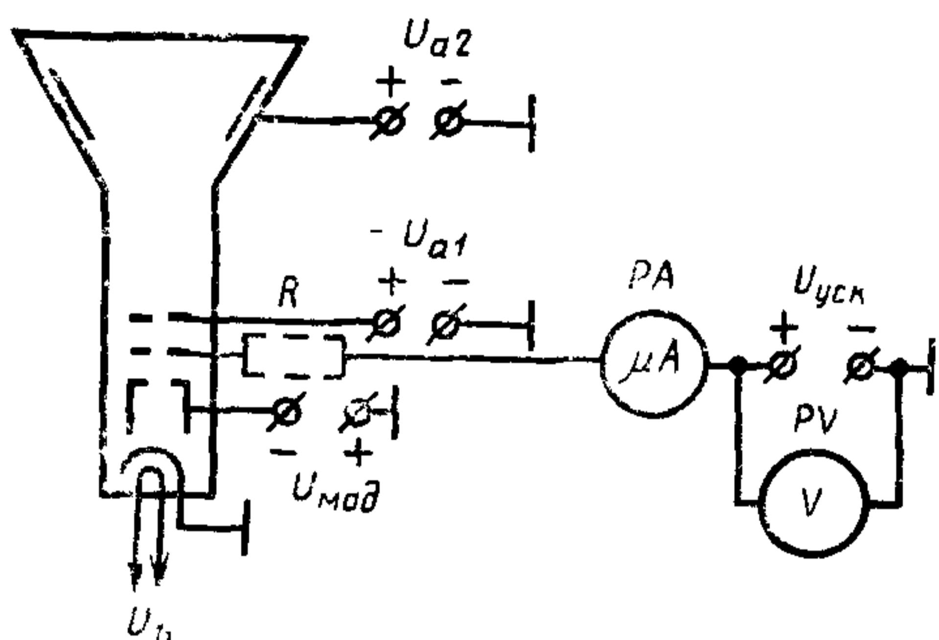
$U_{a2}$  — источник напряжения второго анода;
