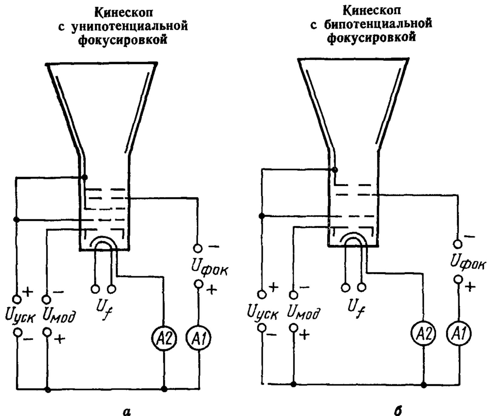
$A1, A2$ —измерительные приборы постоянного тока;  $U_f$ —напряжение накала (постоянное и переменное);  $U_{\text{мод}}$ —постоянное напряжение модулятора;  $U_{\text{уск}}$ —постоянное напряжение ускоряющего электрода и соединенных с ним электродов;  $U_{\text{фок}}$ —постоянное напряжение фокусирующего электрода
