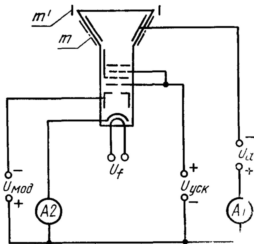
$A1$ ,  $A2$  — измерительные приборы постоянного тока,  $U_f$  — напряжение накала (постоянное или переменное),  $U_{\text{мод}}$  — постоянное напряжение модулятора,  $U_{\text{уск}}$  — постоянное напряжение ускоряющего электрода и соединенных с ним электродов,  $U_a$  — постоянное напряжение анода,  $m'$  — внешнее проводящее покрытие кинескопа,  $m$  — металлическое взрывозащитное устройство
