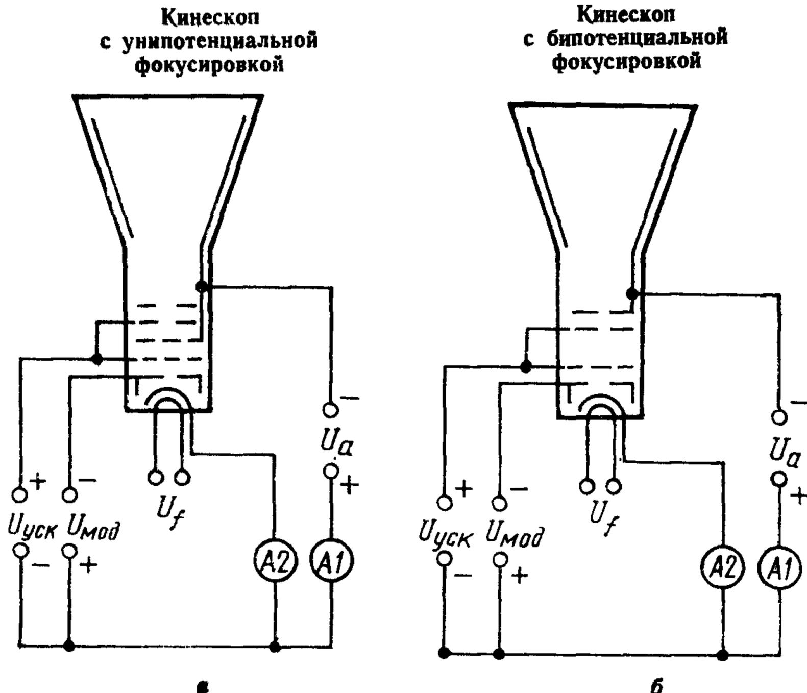
**A1, A2**—измерительные приборы постоянного тока;  $U_f$ —напряжение накала (постоянное и переменное);  $U_{\text{мод}}$ —постоянное напряжение модулятора;  $U_{\text{уск}}$ —постоянное напряжение ускоряющего электрода и соединенных с ним электродов;  $U_a$ —постоянное напряжение анода
