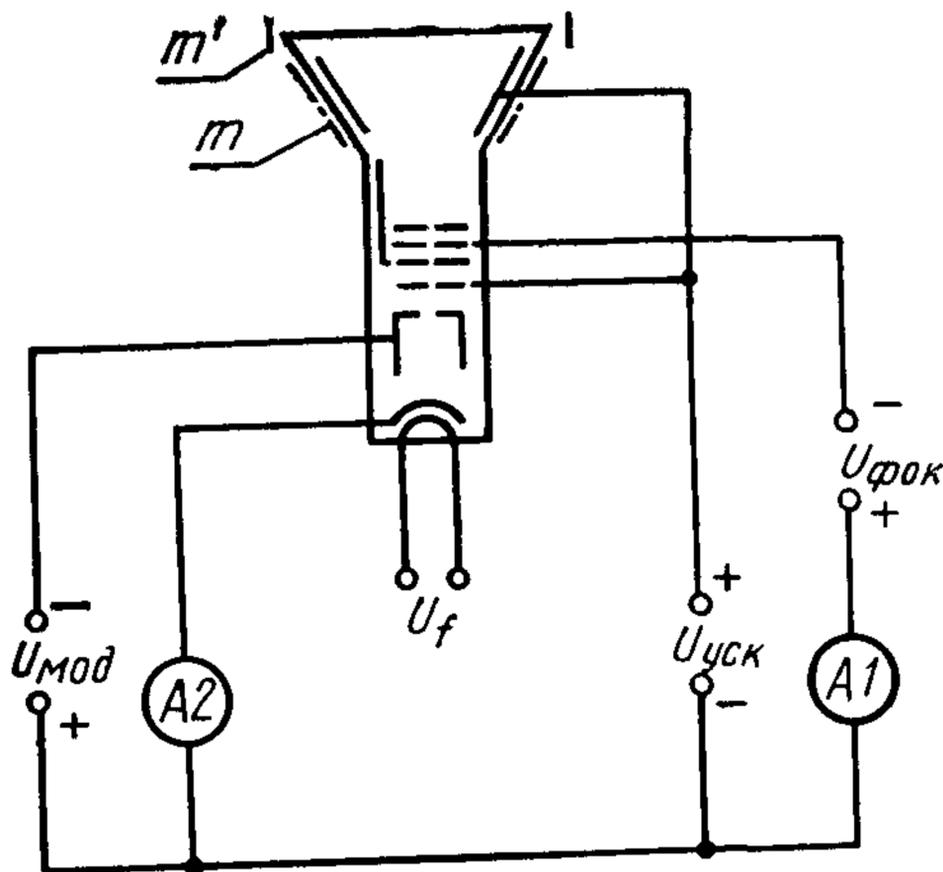
$A1, A2$  — измерительные приборы постоянного тока,  $U_f$  — напряжение накала (постоянное и переменное),  $U_{\text{мод}}$  — постоянное напряжение модулятора,  $U_{\text{уск}}$  — постоянное напряжение ускоряющего электрода и соединенных с ним электродов,  $U_{\text{фок}}$  — постоянное напряжение фокусирующего электрода,  $m$  — внешнее проводящее покрытие кинескопа,  $m'$  — металлическое взрывозащитное устройство
