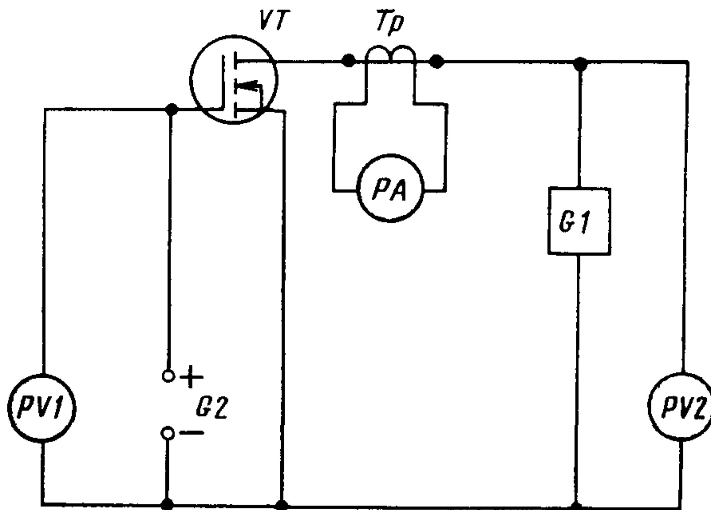
*VT*—измеряемый транзистор; *Tr*—импульсный трансформатор тока; *PA*—импульсный измеритель тока стока; *G1*—источник импульсного напряжения тока стока; *PV1*—вольтметр постоянного тока; *G2*—источник постоянного напряжения затвора; *PV2*—импульсный вольтметр
