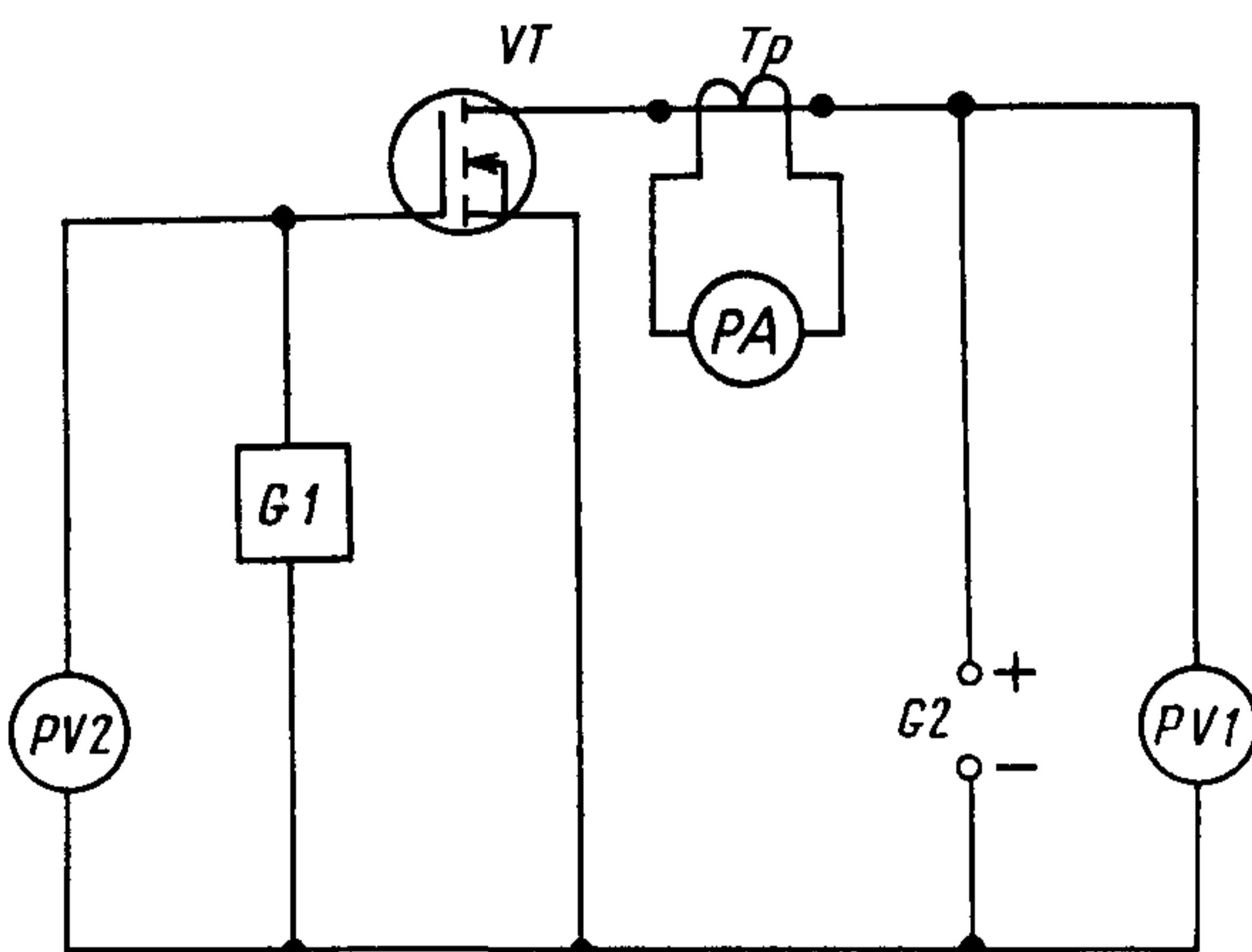
*VT*—измеряемый транзистор; *Tr*—импульсный трансформатор тока; *PA*—импульсный измеритель тока стока; *G1*—источник импульсного напряжения затвора; *PV2*—импульсный вольтметр; *G2*—источник постоянного напряжения стока; *PV1*—вольтметр постоянного тока
