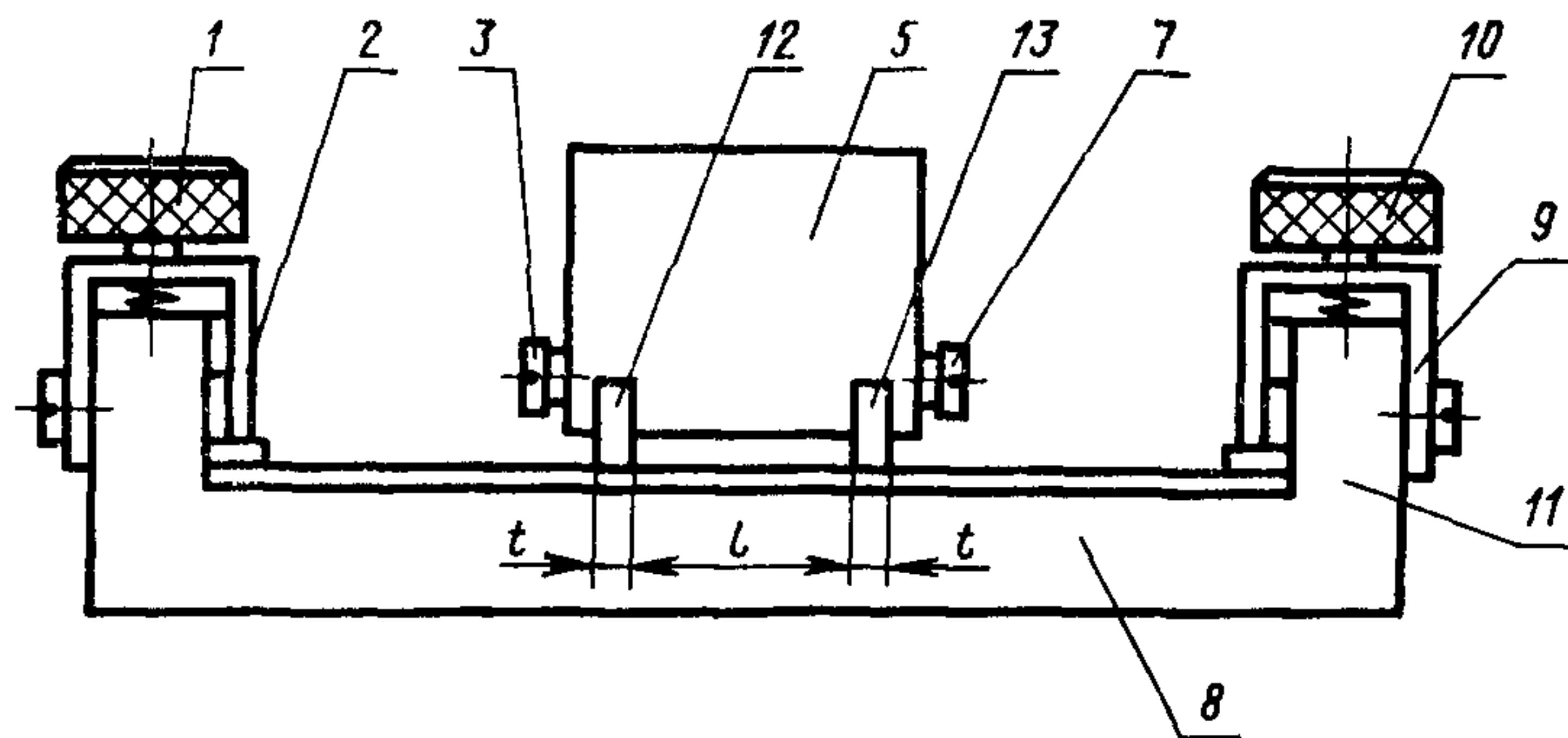
1, 10—винты токовых электродов; 2, 9—токовые электроды; 3, 7—винты электродов напряжения; 4, 6—металлические жесткие электроды напряжения; 5—корпус электродов напряжения; 8—образец; 11—основание электродного устройства; 12, 13—электроды напряжения из резины, обернутой фольгой
