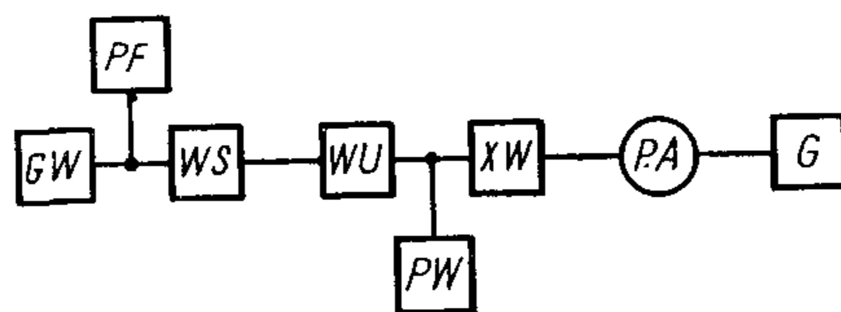
*GW*—генератор СВЧ сигнала; *PF*—частотометр; *WS*—ферритовый вентиль; *WU*—переменный аттенюатор; *PW*—измеритель мощности; *XW*—измерительная диодная камера; *G*—источник тока смещения; *PA*—микроамперметр.
