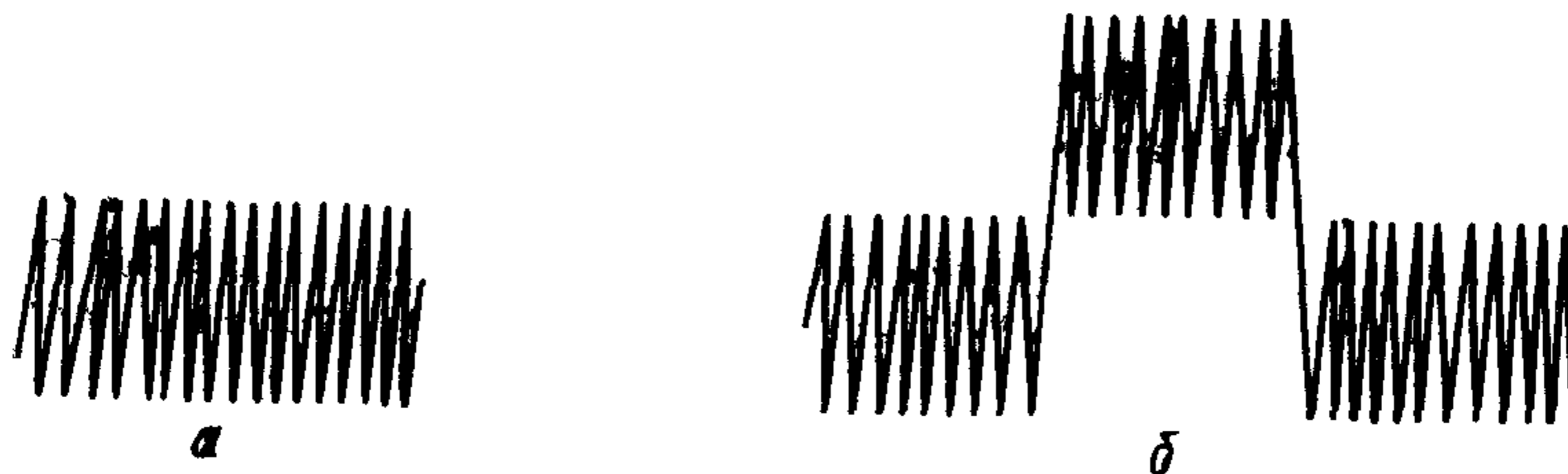
Схематическое изображение полосы шумов на экране осциллографа при измерении тангенциальной чувствительности: a —шумы в отсутствии сигнала, b —шумы при наличии сигнала в положении, при котором производится отсчет по шкале аттенюатора АП
