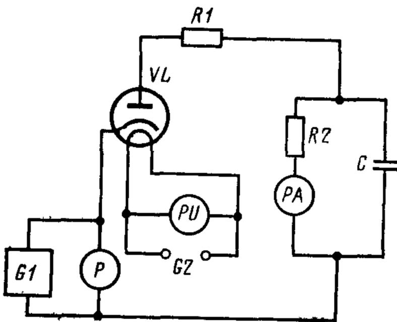
$C$ —конденсатор;  $G1$ —генератор отрицательных импульсов;  $G2$ —источник постоянного или переменного тока;  $PU$ —вольтметр постоянного или переменного тока,  $P$ —измерительное устройство;  $R1$ ,  $R2$ —резисторы,  $VL$ —испытуемый кенотрон;  $PA$ —миллиамперметр постоянного тока
