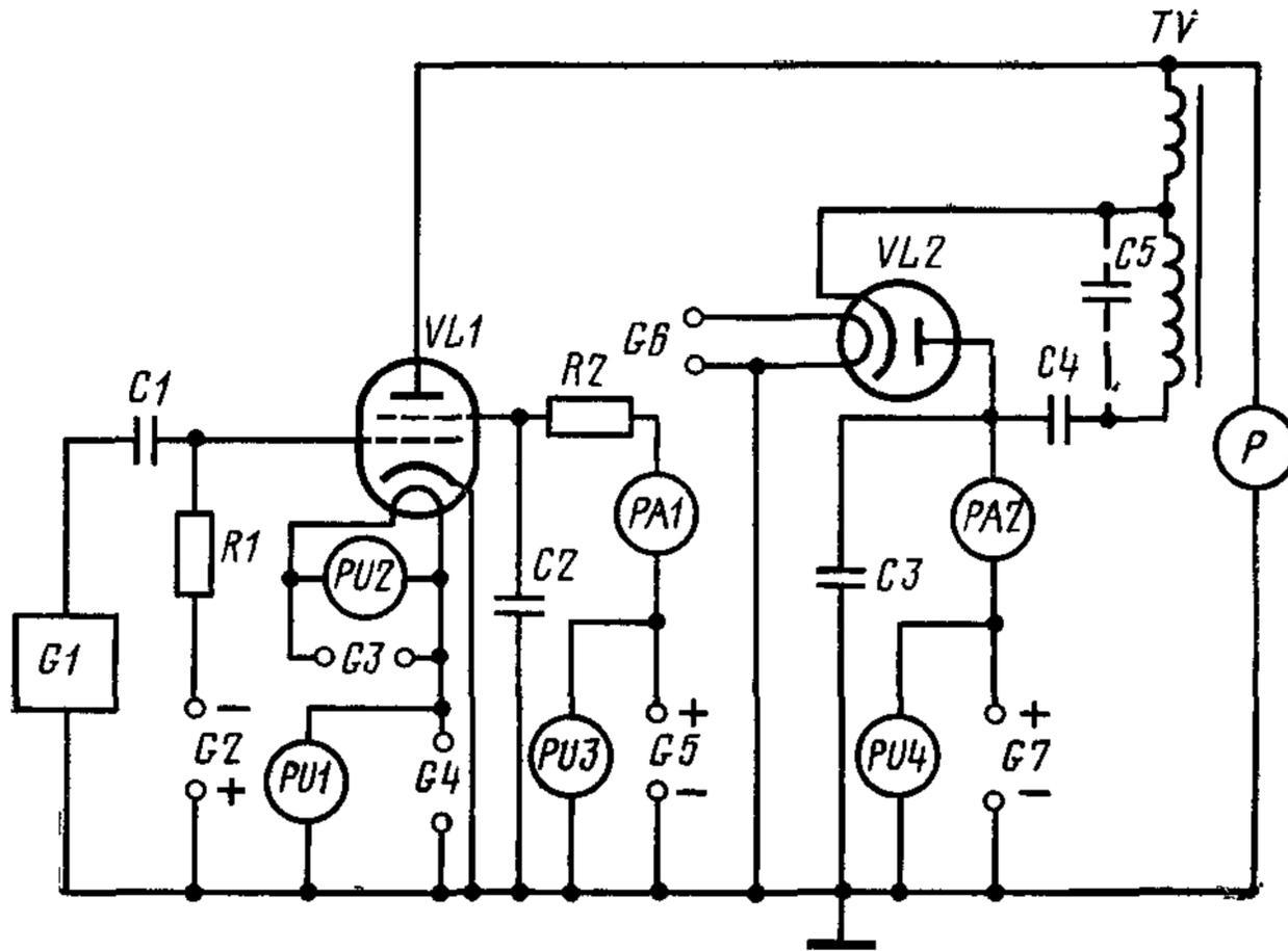
*C1—C5*—конденсаторы; *G1*—генератор отрицательных импульсов; *G2, G4, G5, G7*—источники постоянного тока; *G3, G6*—источники постоянного или переменного тока; *PA1, PA2*—миллиамперметры постоянного тока, *PU1, PU3, PU4*—вольтметры постоянного тока; *PU2*—вольтметр постоянного или переменного тока; *P*—устройство для измерения амплитуды напряжения анода в импульсе; *R1, R2*—резисторы; *TV*—импульсный трансформатор; *VL1*—испытуемая лампа; *VL2*—демпферный диод
