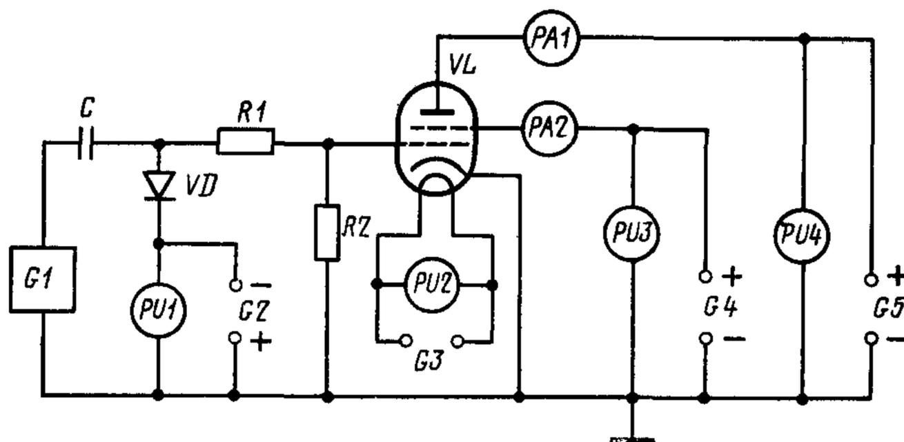
*C*—конденсатор, *G1*—генератор импульсов; *G2*, *G4*, *G5*—источники постоянного тока, *G3*—источник постоянного или переменного тока; *PA1*, *PA2*—миллиамперметры постоянного тока; *PU1*, *PU3*, *PU4*—вольтметры постоянного тока; *PU2*—вольтметр постоянного или переменного тока; *R1*, *R2*—резисторы, *VD*—полупроводниковый диод; *VL*—испытуемая лампа
