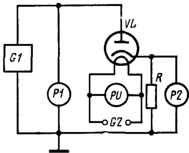
$G1$  — генератор прямоугольных импульсов;  $G2$  — источник постоянного или переменного тока;  $P1$ ,  $P2$  — устройства для измерения импульсного напряжения;  $PU$  — вольтметр постоянного или переменного тока;  $R$  — резистор;  $VL$  — испытываемая лампа
