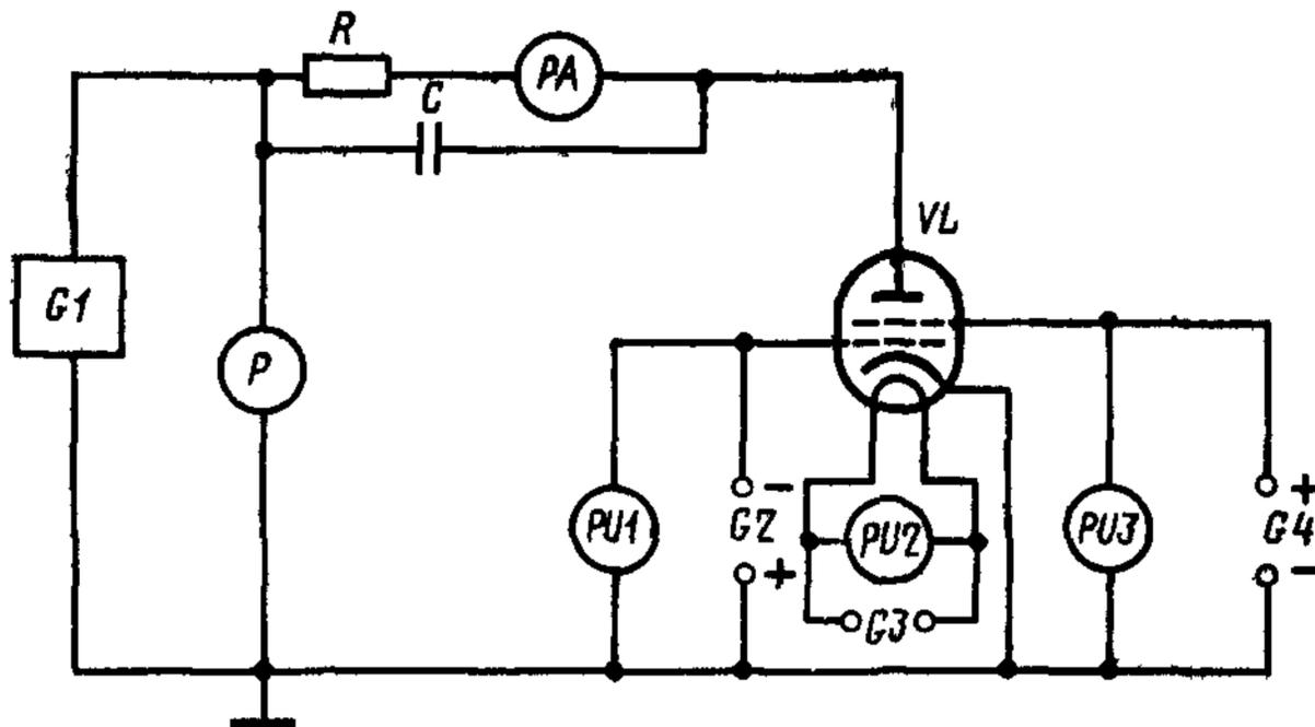
*C*—конденсатор; *G1*—генератор импульсов; *G2*, *G4*—источники постоянного тока; *G3*—источник постоянного или переменного тока; *PA*—микроамперметр постоянного тока; *P*—устройство для измерения импульсного напряжения; *PU1*, *PU3*—вольтметры постоянного тока; *PU2*—вольтметр постоянного или переменного тока; *R*—резистор; *VL*—испытуемая лампа
