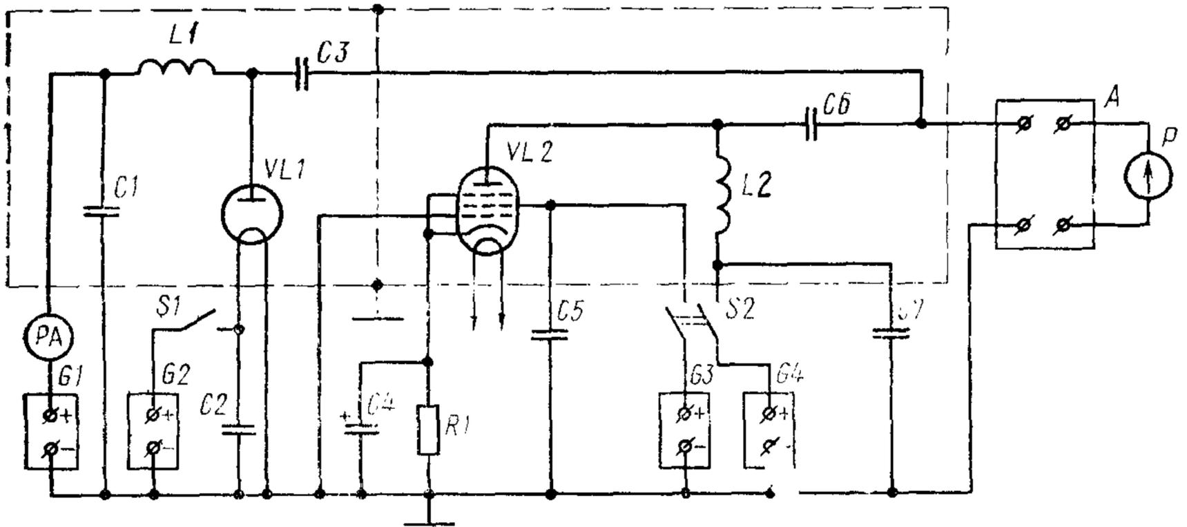
*PA* — миллиамперметр постоянного тока; *G1, G2, G3, G4* — стабилизированные регулируемые источники питания; *C1, C2, C4, C5, C7* — развязывающие конденсаторы; *C3, C6* — разделительные конденсаторы; *L1, L2* — дроссели; *S1, S2* — выключатели; *VL1* — шумовой диод; *VL2* — испытываемая лампа; *R1* — резистор; *A* — избирательный усилитель; *P* — индикатор
