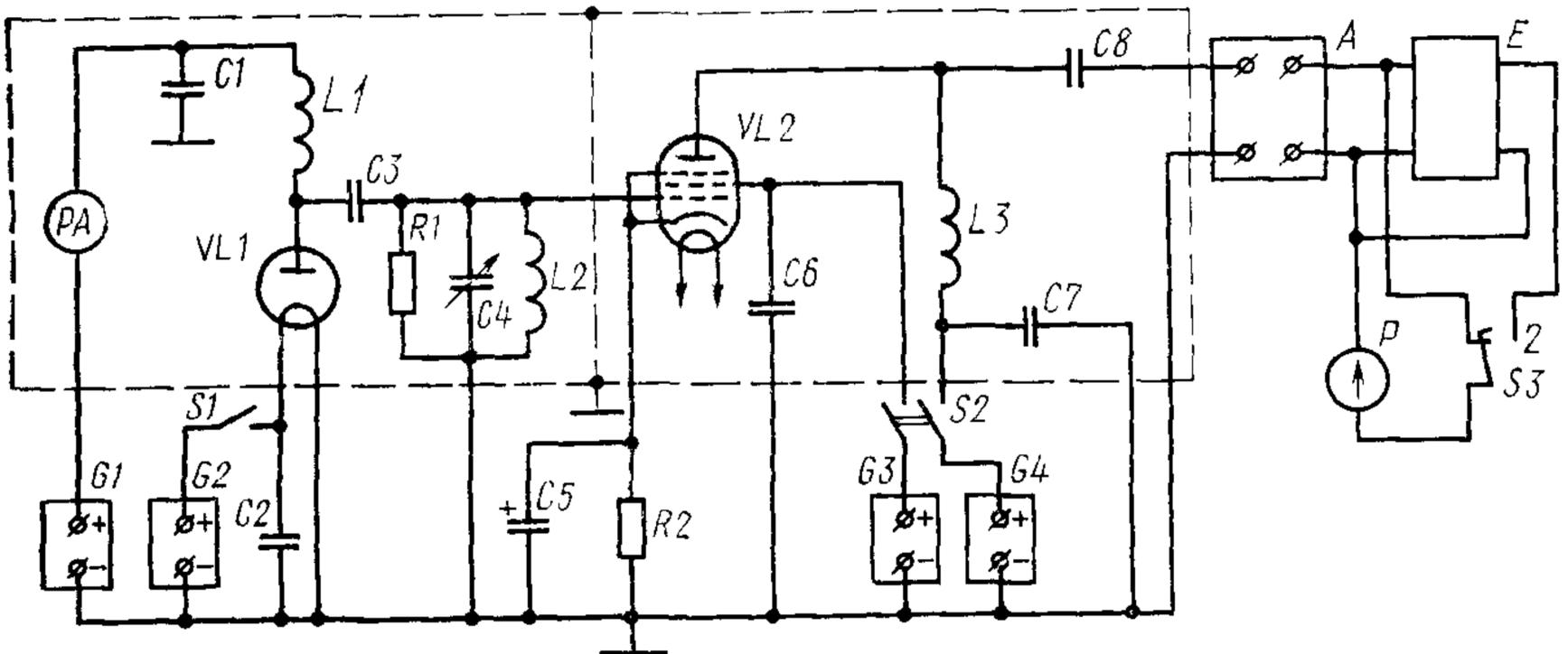
*PA* — миллиамперметр постоянного тока; *G1, G2, G3, G4* — стабилизированные источники питания; *C1, C2, C5, C6, C7* — развязывающие конденсаторы; *C3, C8* — разделительные конденсаторы; *C4* — конденсатор переменной емкости; *VL1* — шумовой диод; *VL2* — испытываемая лампа; *R1, R2* — резисторы; *L1, L2, L3* — дроссели; *A* — избирательный усилитель; *E* — аттенюатор; *P* — индикатор; *S1, S2, S3* — выключатели
