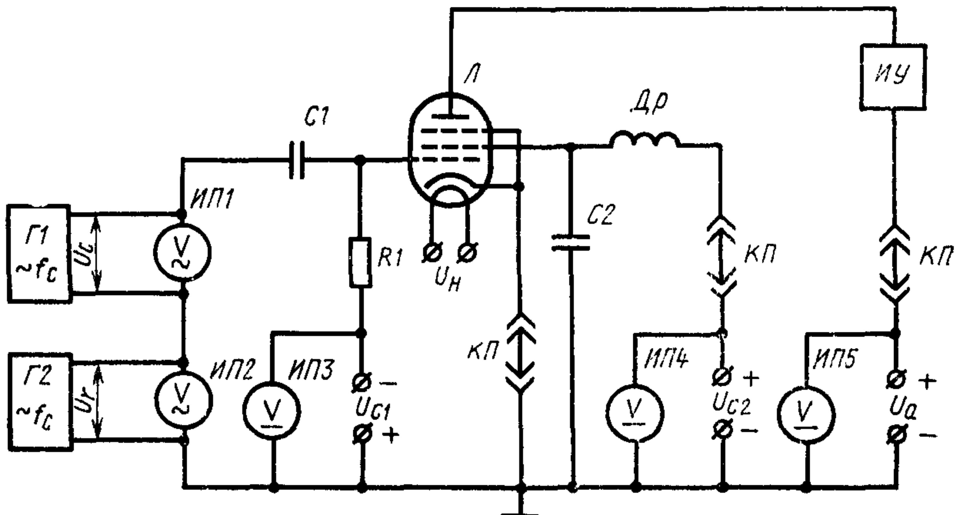
$G_1, G_2$ —генераторы гармонических сигналов; ИП1, ИП2—селективные вольтметры переменного тока с характеристиками, позволяющими измерять эффективное значение напряжения соответствующей частоты; ИП3, ИП4, ИП5—вольтметры постоянного тока;  $R_1$ —резистор;  $C_1, C_2$ —конденсаторы;  $Др$ —высокочастотный дроссель; КП—разрывы цепей электродов для включения приборов; ИУ—измерительное устройство; Л—испытываемая лампа.
