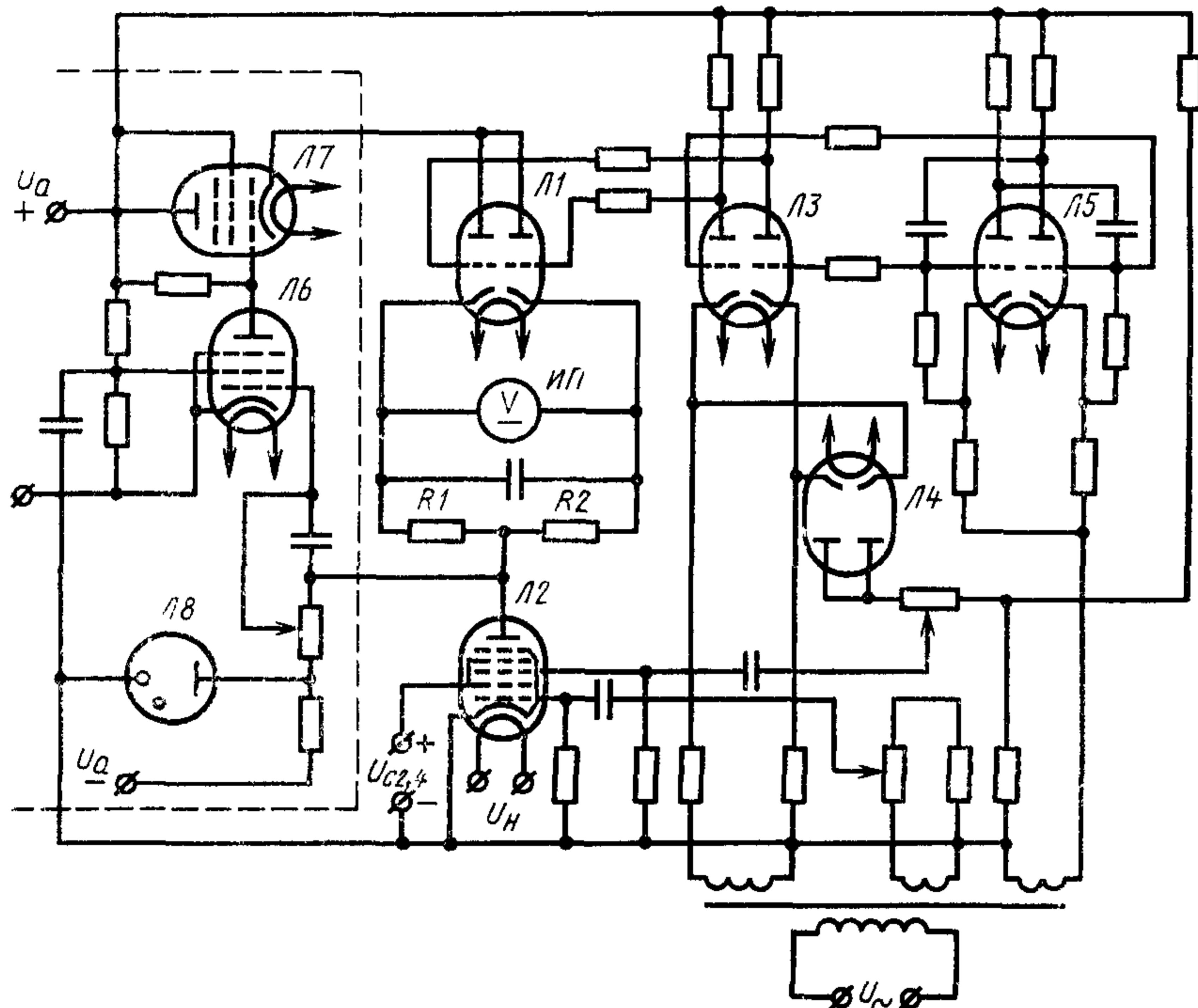
В устройстве использованы электронные реле для переключателя фазы напряжения сигнальной сетки и производится непосредственный отсчет разности постоянных составляющих тока анода испытуемой лампы.
