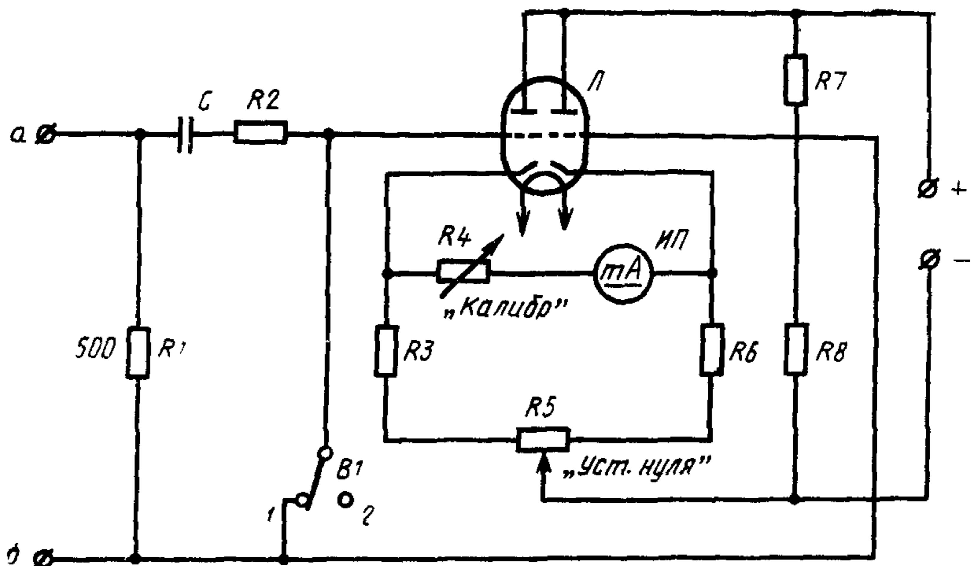
Устройство представляет собой запоминающий ламповый милливольтметр с входным сопротивлением 500 Ом, подключаемый к клеммам  $a$ ,  $b$  (черт. 3), переключатель  $B_1$  должен быть сблокирован с переключателем  $B$  (черт. 3).
