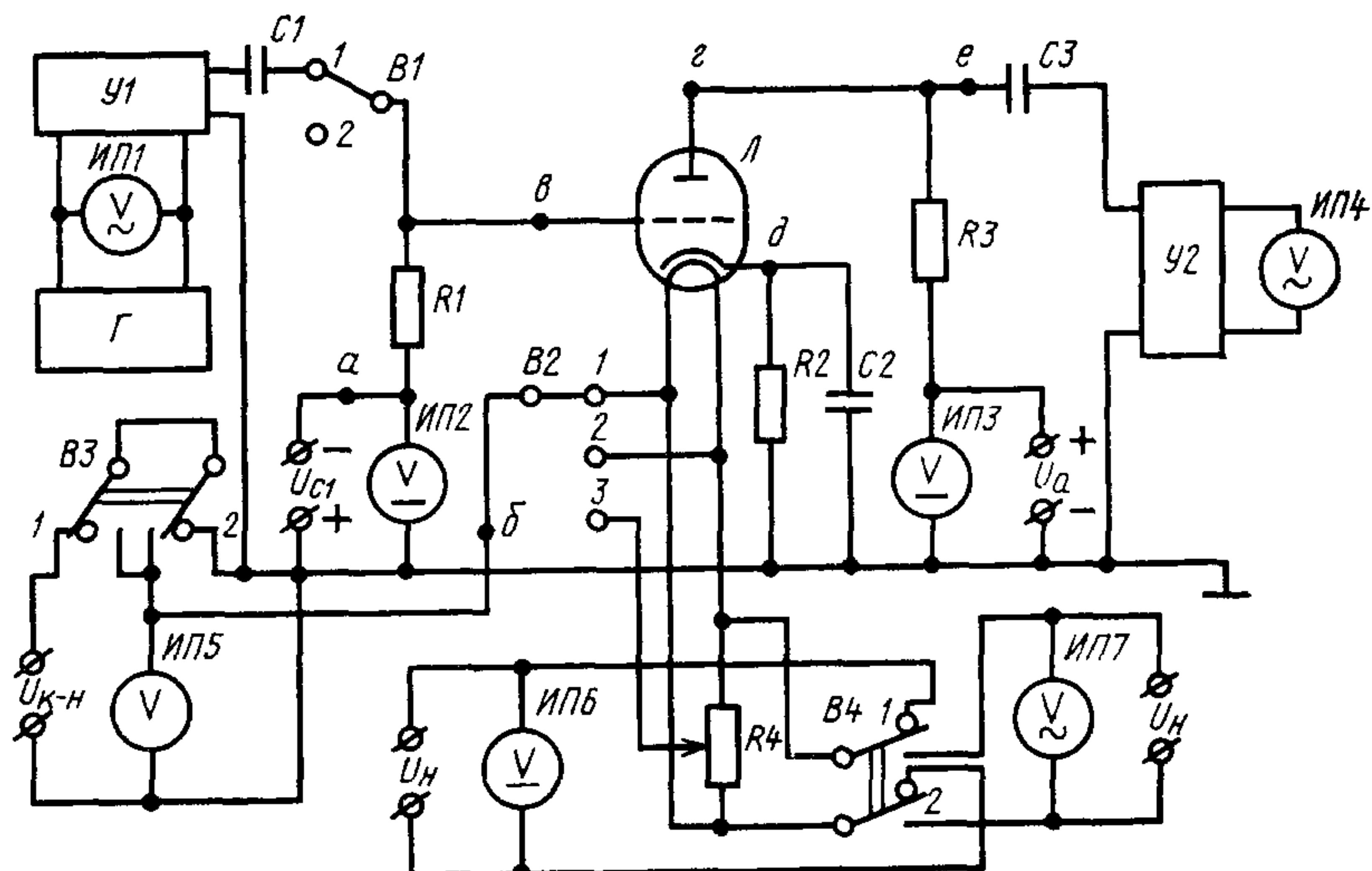
$G$  — генератор,  $ИП1, ИП4, ИП7$  — вольтметры переменного тока;  $ИП2, ИП3, ИП6$  — вольтметры постоянного тока;  $ИП5$  — вольтметр;  $У1$  — делитель напряжения;  $У2$  — фильтр;  $C1, C2, C3$  — конденсаторы;  $R1 — R4$  — резисторы;  $B1 — B4$  — переключатели;  $a, б, в, г, д$  — вспомогательные обозначения точек схемы;  $L$  — испытуемая лампа.
