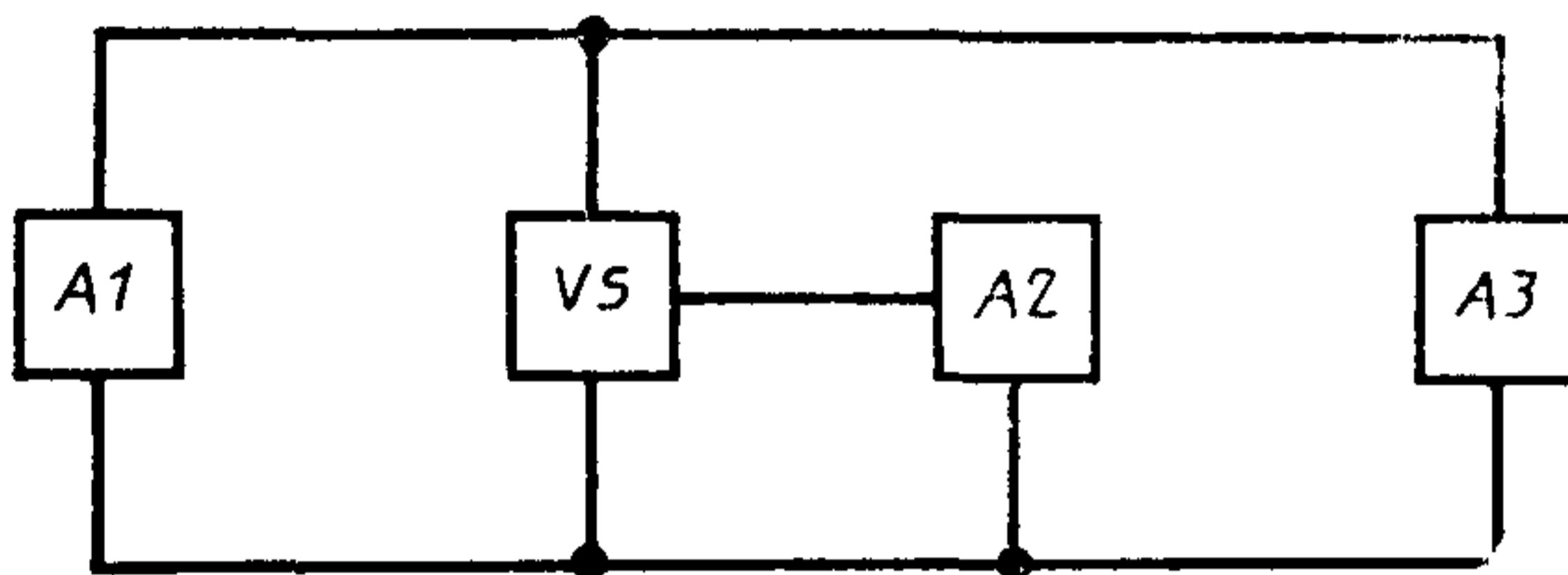
*A<sub>1</sub>*—устройство задания режима в цепи основных выводов тиристора; *VS*—испытуемый тиристор; *A<sub>2</sub>*—устройство задания режима в цепи управления (для диодных тиристоров отсутствует); *A<sub>3</sub>*—измерительное устройство для измерения напряжения в открытом состоянии
