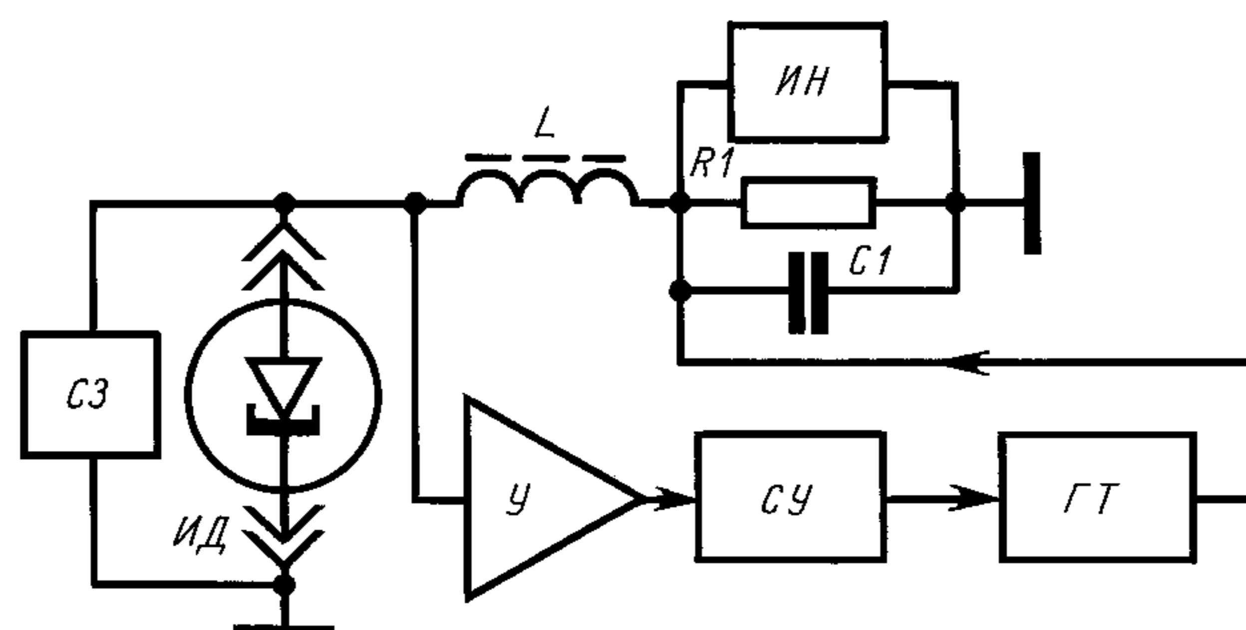
*СЗ* — схема защиты; *ИД* — измеряемый диод; *У* — усилитель; *СУ* — схема управления; *ГТ* — генератор тока; *ИН* — измеритель напряжения; *L* — индуктивность; *R1* — резистор; *C1* — конденсатор
