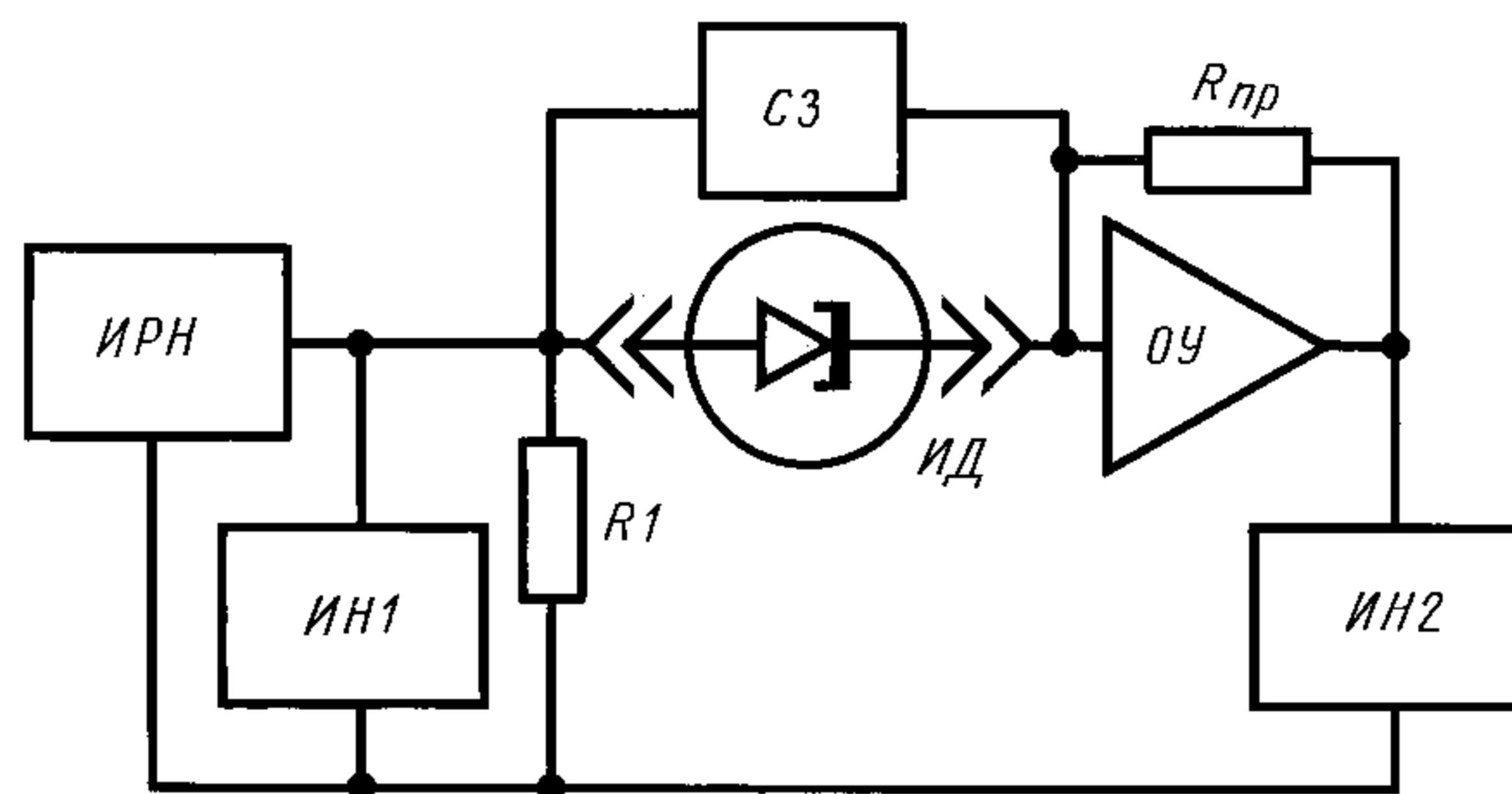
*ИРН* — источник регулируемого напряжения; *СЗ* — схема защиты; *ИД* — измеряемый диод; *R1* — резистор, обеспечивающий условие устойчивого смещения в рабочую точку; *R<sub>пр</sub>* — прецизионный резистор; *ИН1*, *ИН2* — измерители напряжения; *ОУ* — операционный усилитель
