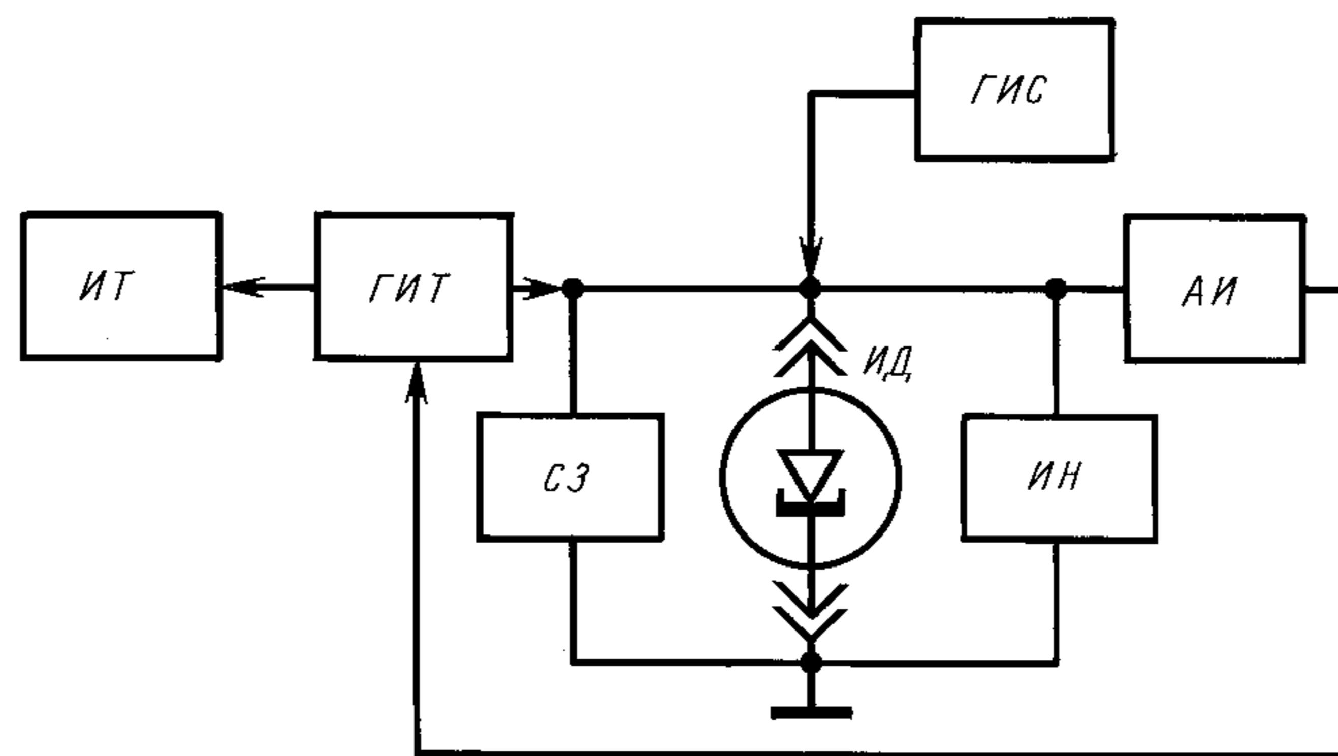
*ГИТ* — генератор измеряемого тока; *СЗ* — схема защиты; *ИД* — измеряемый диод; *ГИС* — генератор импульсов сброса; *АИ* — анализатор импульсов; *ИН* — измеритель напряжения; *ИТ* — индикатор тока
