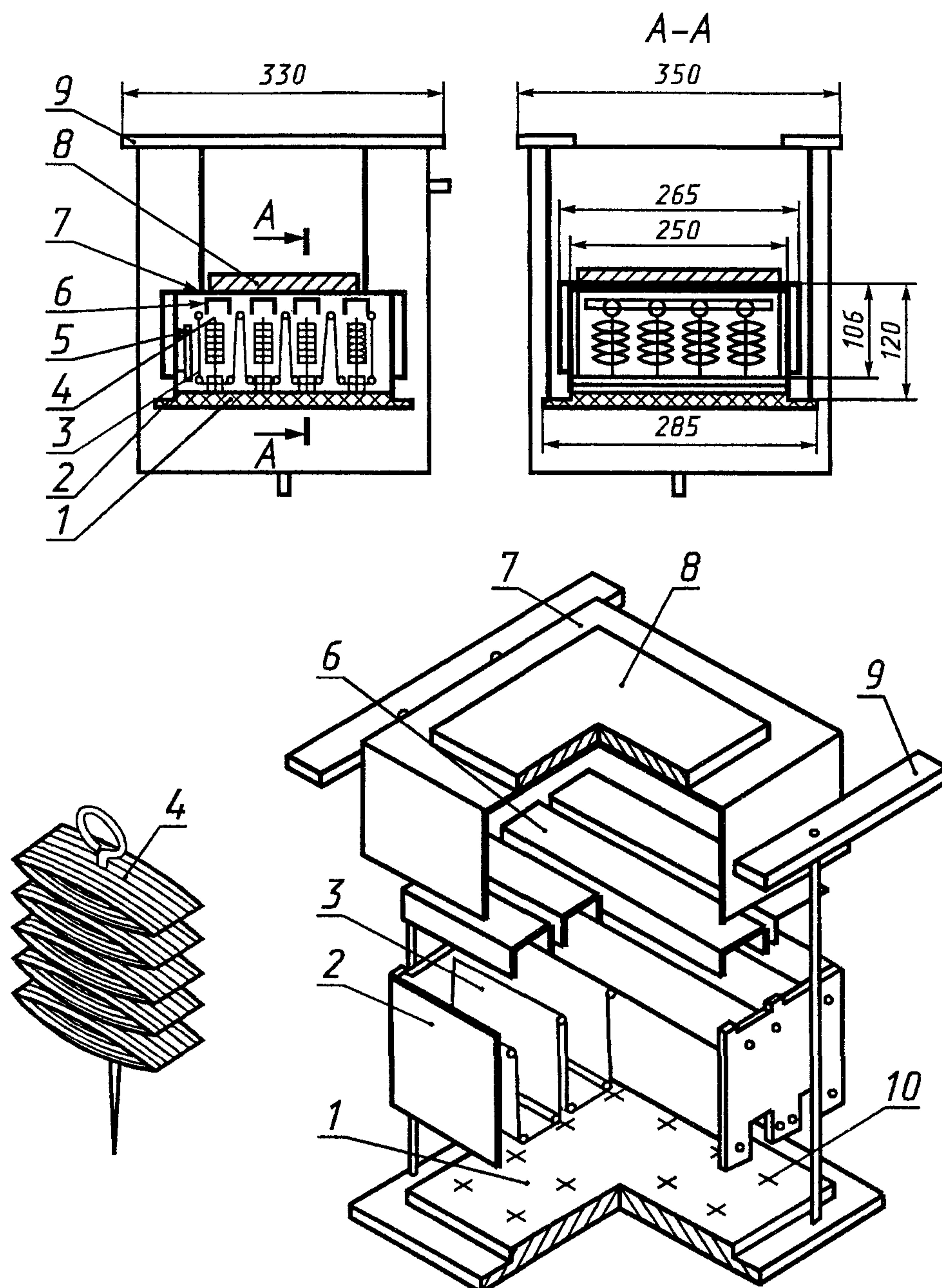
1 — основание; 2 — каркас; 3 — батист; 4 — игла с образцом; 5 — контрольный термометр; 6 — крышка; 7 — колпак; 8 — груз; 9 — ручка-опора; 10 — отверстие под иглу
