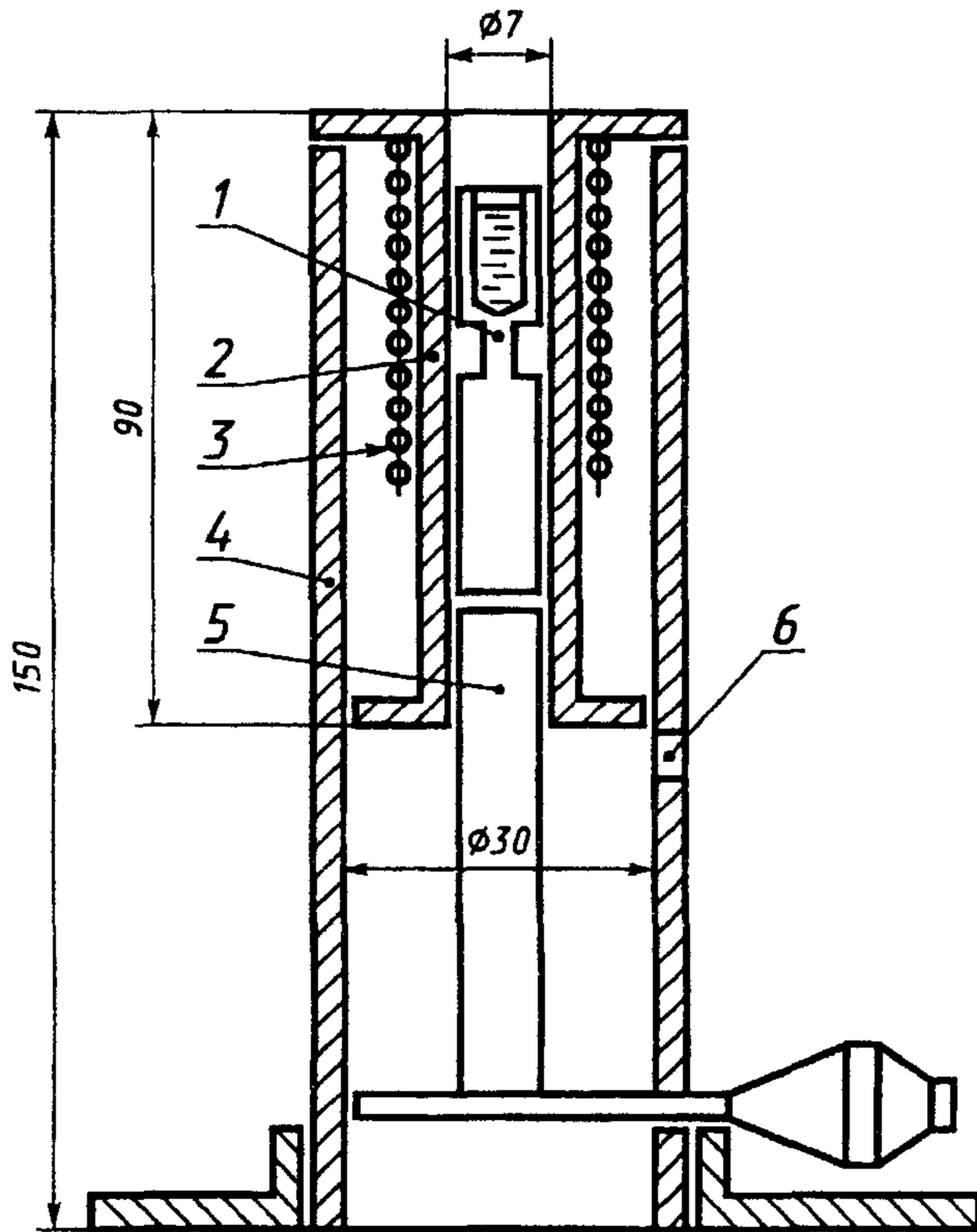
1 — электрод с пробой; 2 — кварцевая трубка; 3 — нагреватель на 300 Вт; 4 — корпус печи; 5 — толкатель;
