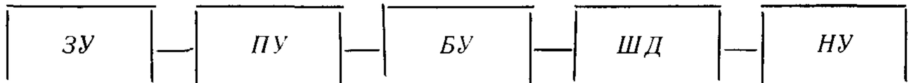
*ЗУ—задающее устройство, ПУ—программное устройство; БУ—блок управления двигателем, ШД—шаговый двигатель, НУ—нагрузочное устройство*
