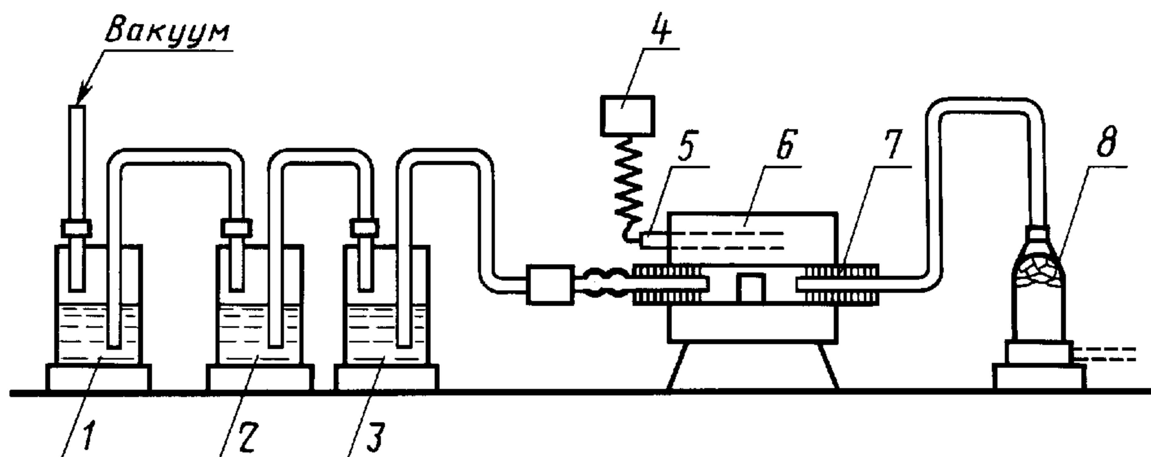
1—3 — склянки Дрокселя поглотительные; 4 — терморегулятор; 5 — термопара; 6 — печь трубчатая, электрическая, типа Ј СУОЛ 0,25.2,5/14К; 7 — лодочки фарфоровые; 8 — склянка Тищенко СПТ, в нижней части — безводный хлористый кальций, в верхней — кусочки гидроокиси натрия
