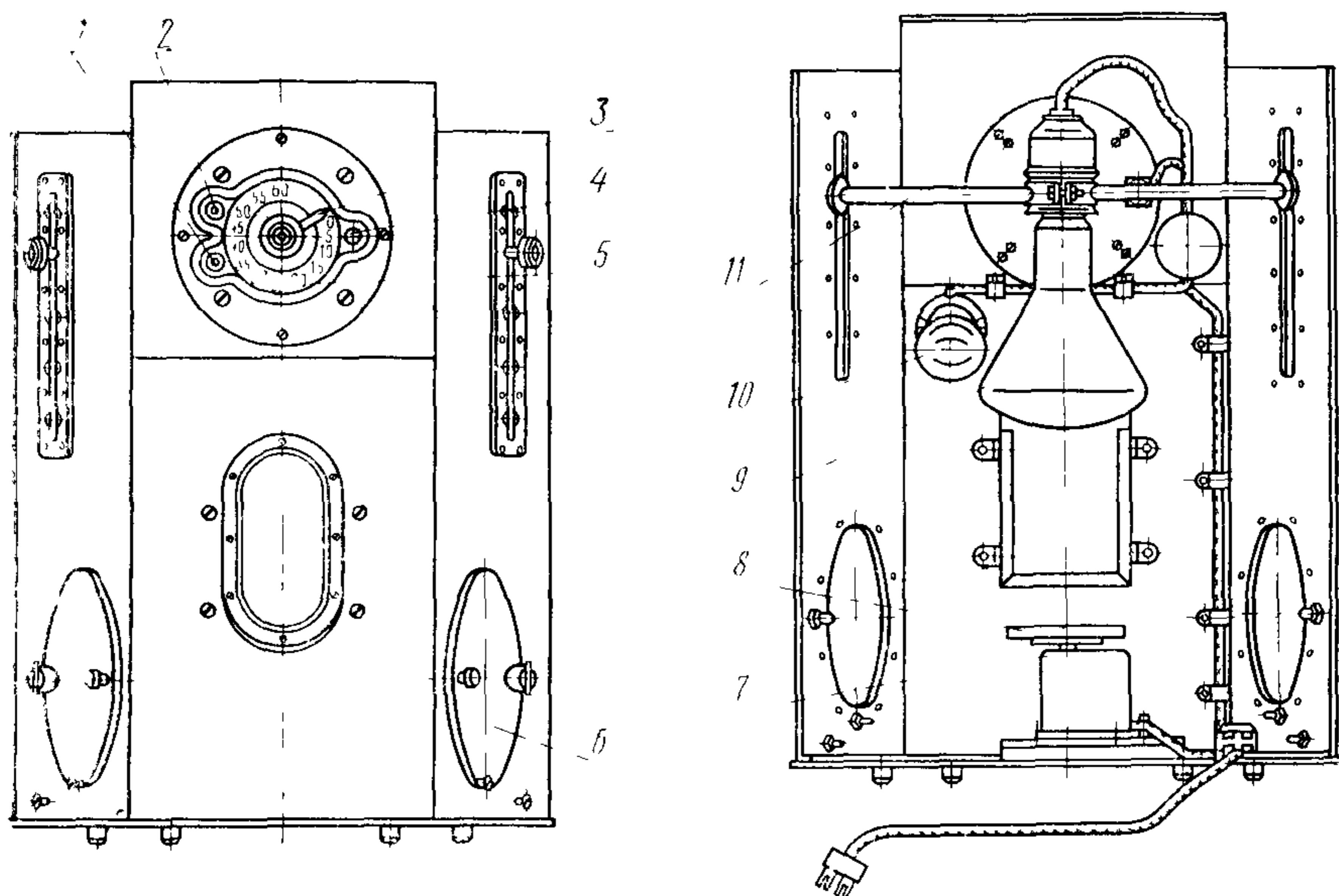
1—тумблер для включения осветительной электролампы; 2—тумблер для включения электрозвонка; 3—минутная стрелка; 4—кнопка для включения двигателей стоп-часов, стенда и инфракрасной лампы; 5—электрические сигнальные стоп-часы; 6—заслонки; 7—синхронный двигатель; 8—диск; 9—инфракрасная лампа; 10—осветительная электролампа; 11—держатель
