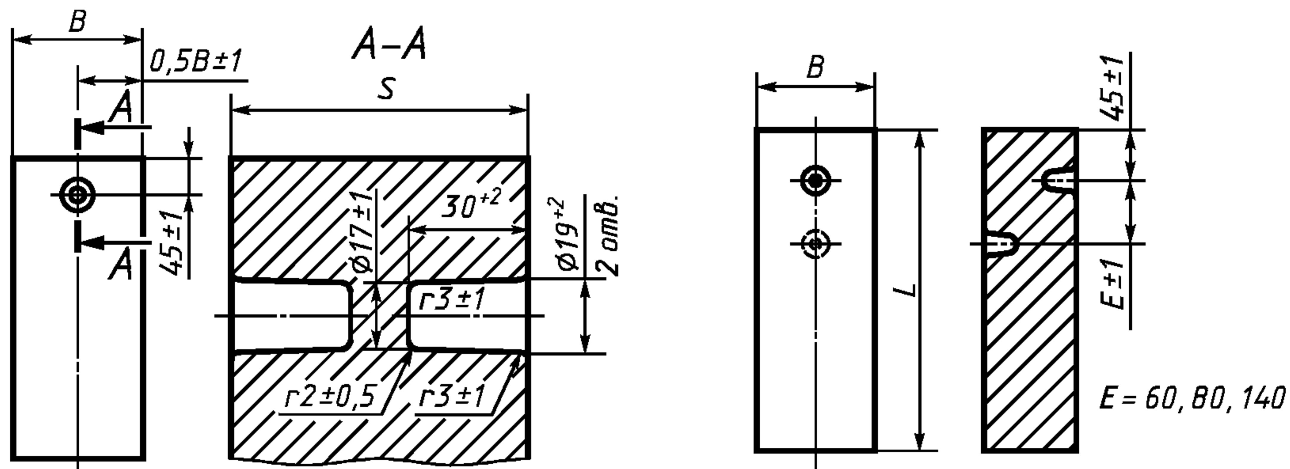
Рисунок 3 — Расположение отверстий для штырей
