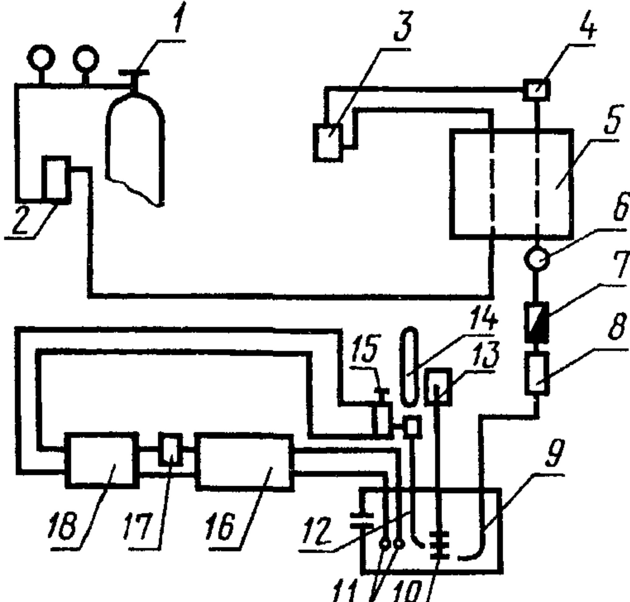
Примечание. Вместо бюретки 14, магнитного клапана 15 можно использовать автоматическую бюретку — дозатор Б-701. Электролитическую ячейку 9 вместимостью 200 см<sup>3</sup> можно заменить сосудом с пористым фильтром № 2 или 3 вместимостью 100 см<sup>3</sup>.
