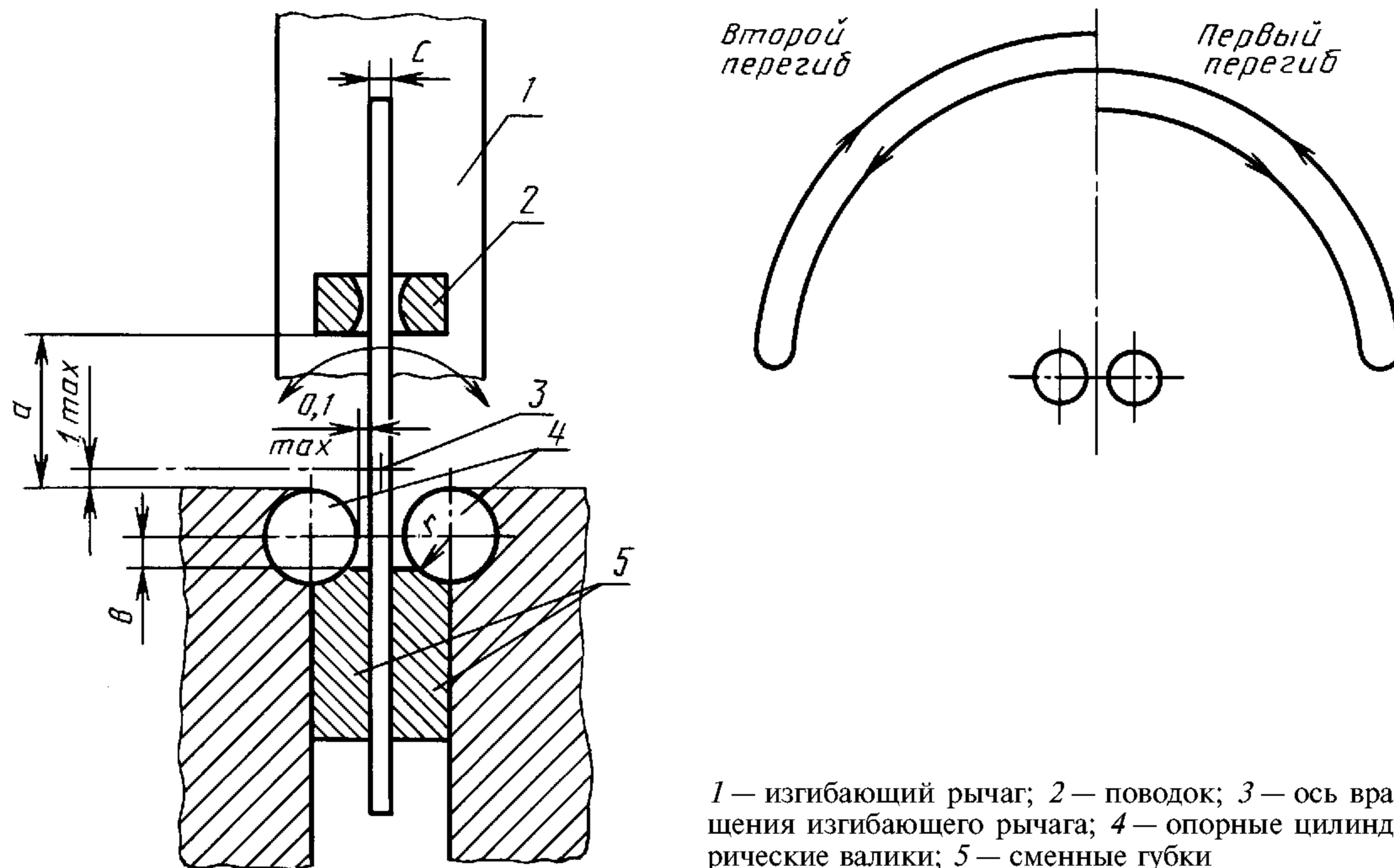
1 — изгибающий рычаг; 2 — поводок; 3 — ось вращения изгибающего рычага; 4 — опорные цилиндрические валики; 5 — сменные губки
