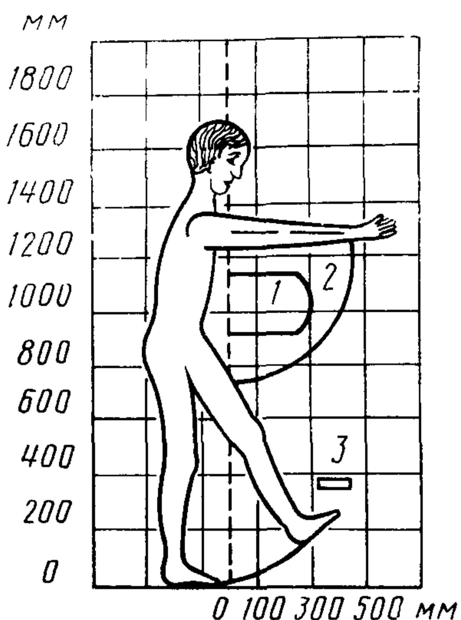
1 — зона размещения очень часто используемых и наиболее важных органов управления (оптимальная зона моторного поля), 2 — зона для размещения часто используемых органов управления (зона легкой досягаемости моторного поля), 3 — органы управления (педаль)
