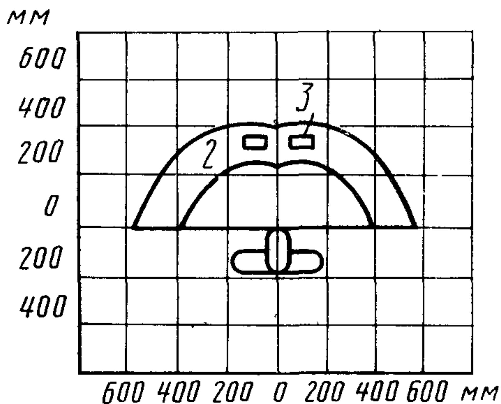
1 — зона размещения очень часто используемых и наиболее важных органов управления (оптимальная зона моторного поля), 2 — зона для размещения часто используемых органов управления (зона легкой досягаемости моторного поля), 3 — органы управления (педали)
