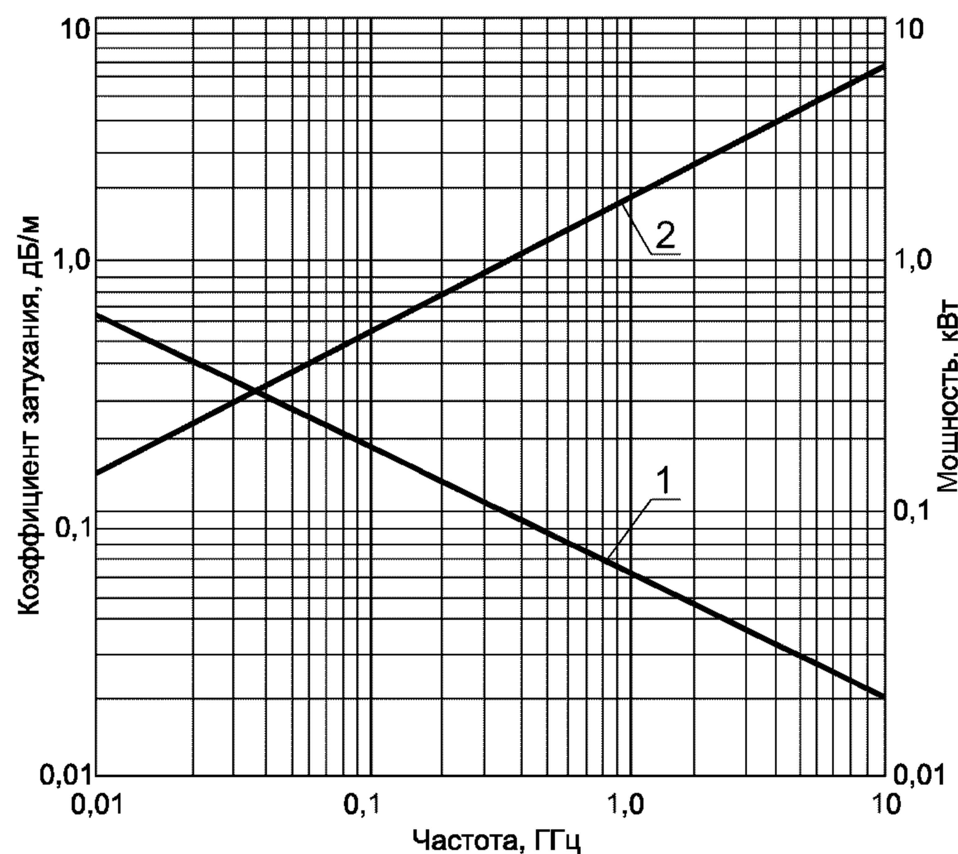
1 — допустимая мощность  $P$  на входе при температуре 40 °C и коэффициент стоячей волны напряжения, равном 1; 2 — коэффициент затухания при температуре 20 °C
