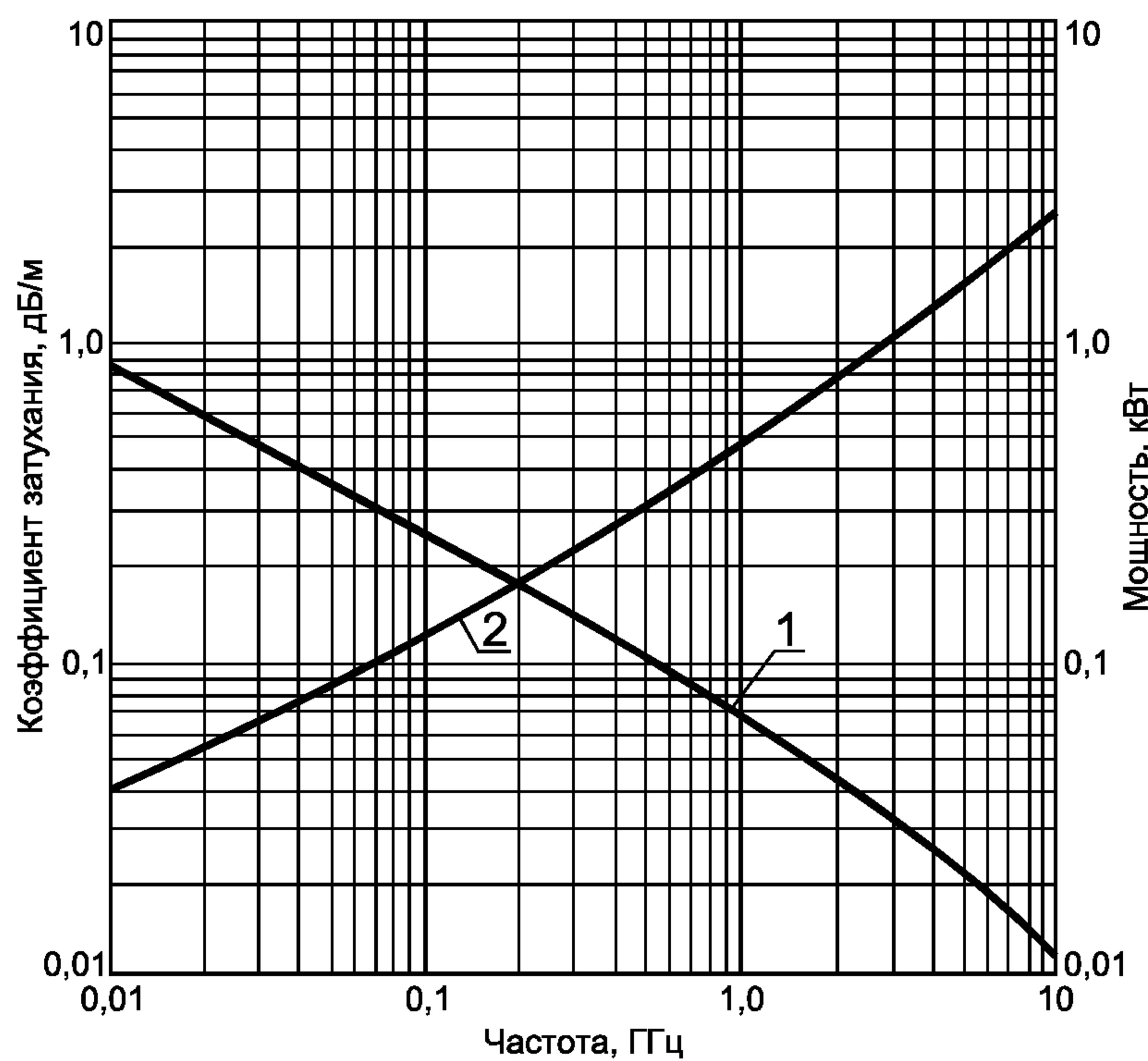
1 — допустимая мощность  $P$  на входе при температуре 40 °C и коэффициенте стоячей волны напряжения, равном 1;
