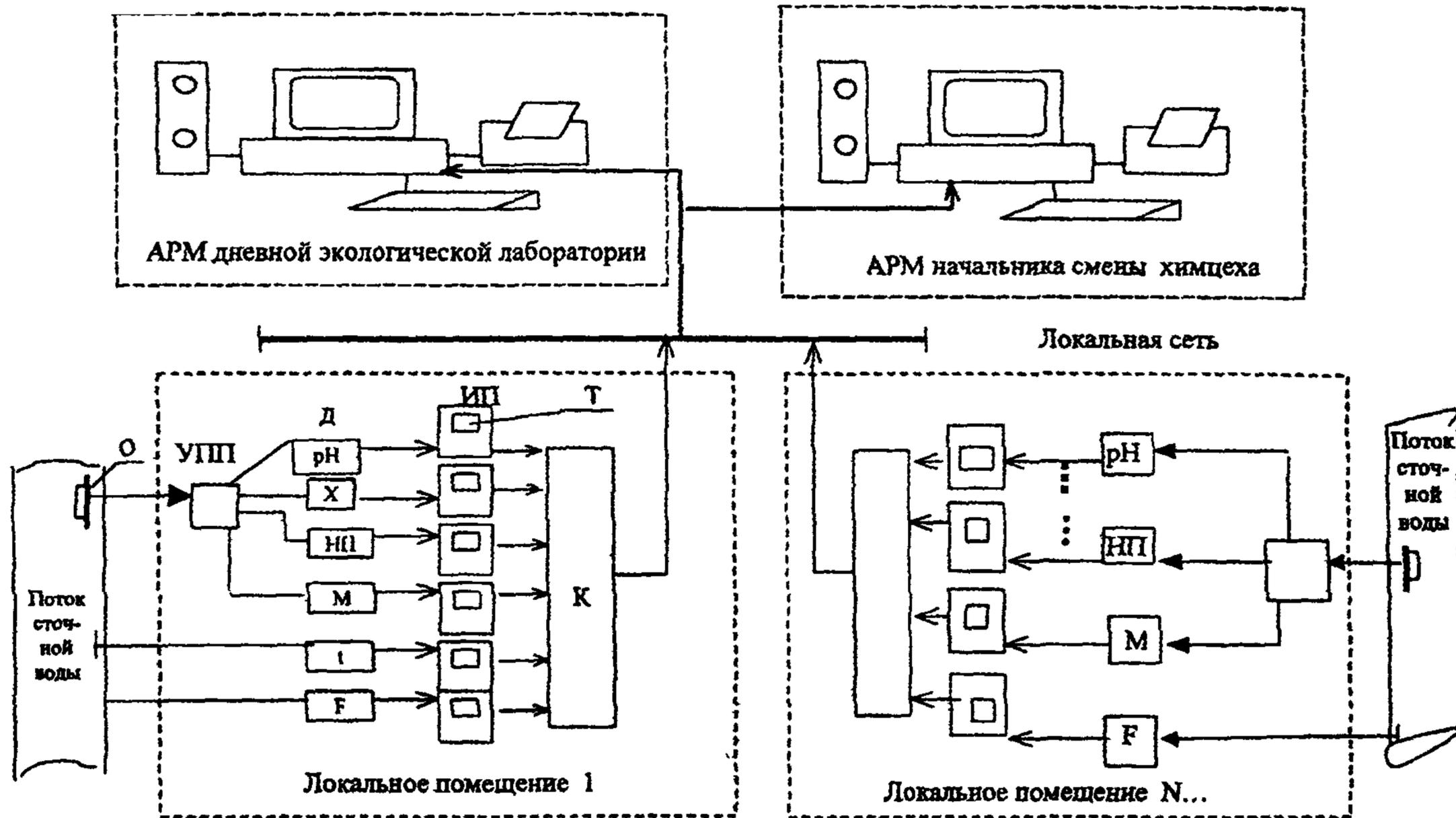
О – отборник пробы; УПП – устройство подготовки и подачи пробы к датчикам анализаторов; ИП – измерительный преобразователь; Т – табло текущих значений контролируемых показателей; К – контроллер; Д – датчик анализатора (рН) – рН-метр; НИ – нефтемер; М – мутномер; Х – УЭП; t – термопара, F – расходомер.
