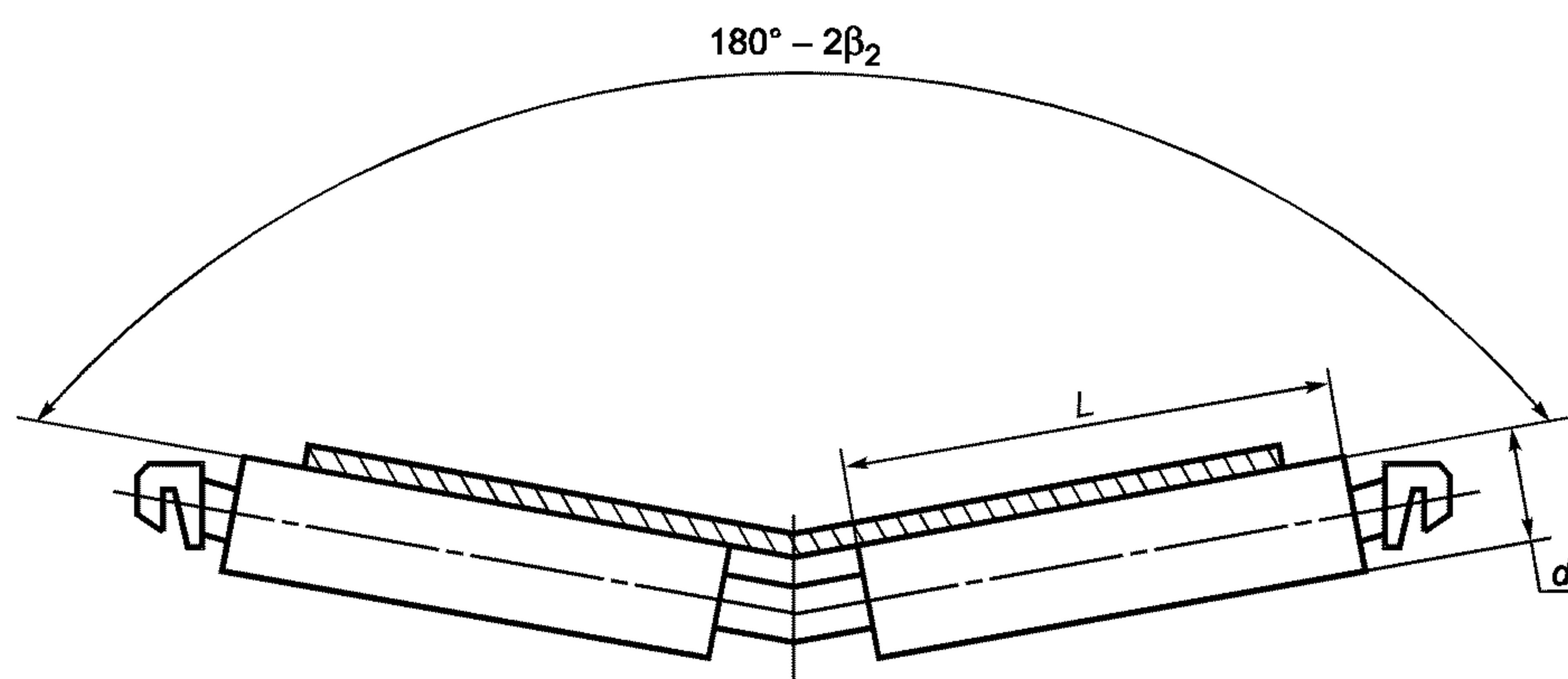
Рисунок 4 — Двухроликовая гирляндная опора
