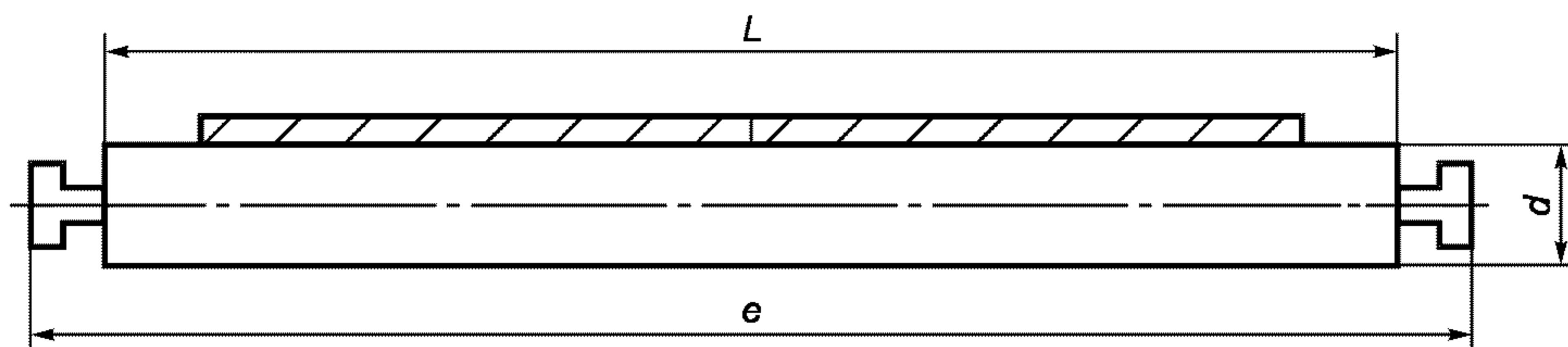
Рисунок 5 — Однороликовая опора
