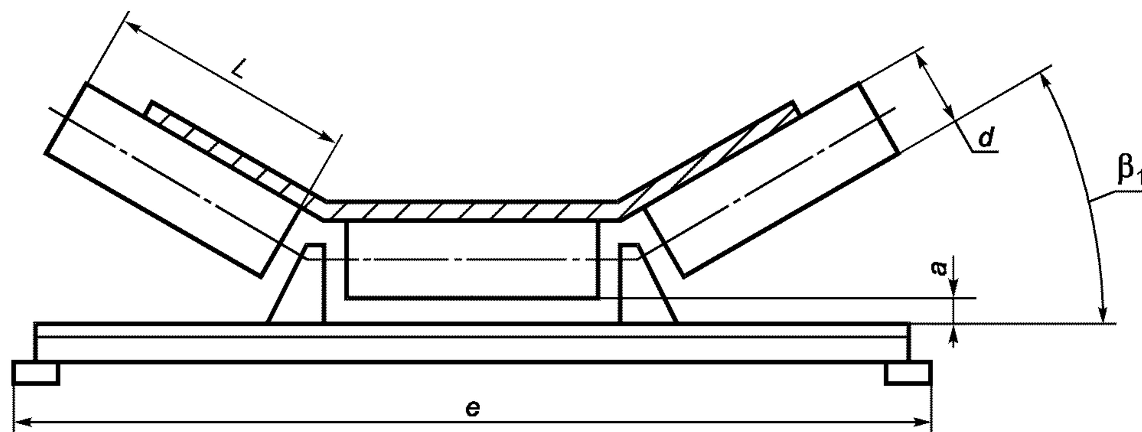
Рисунок 1 — Жесткая трехроликовая опора
