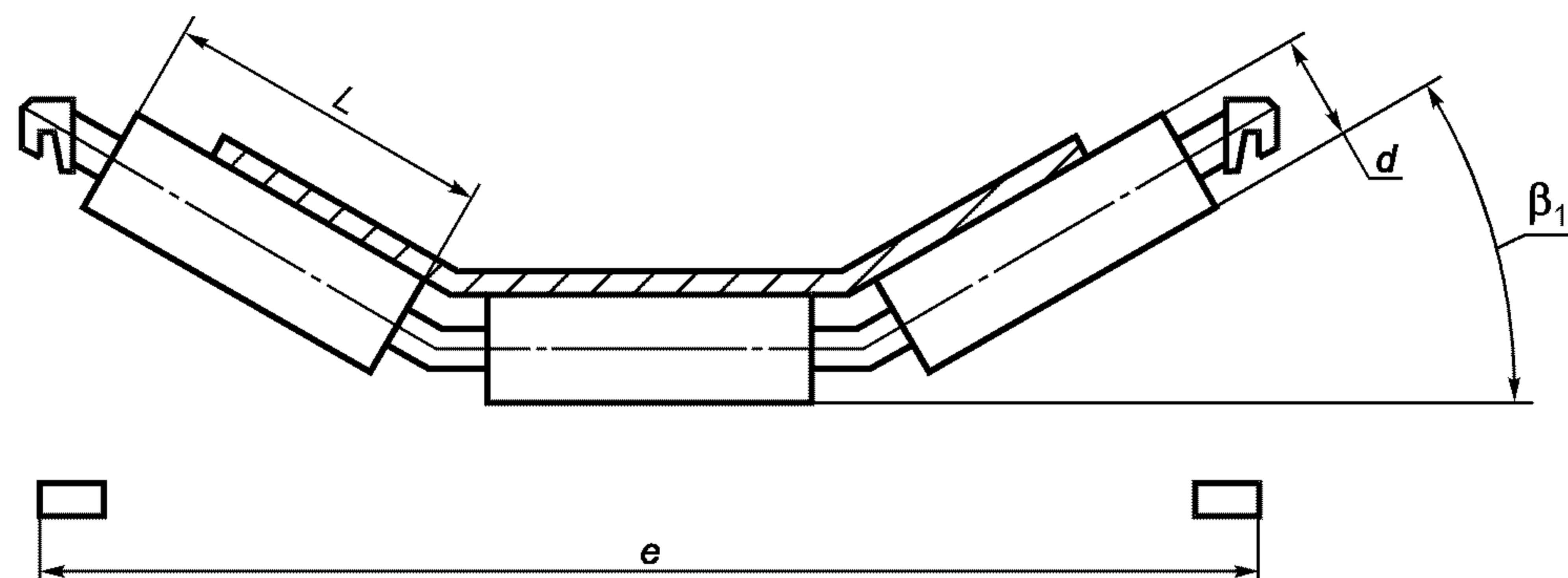
Рисунок 2 — Трехроликовая гирляндная опора
