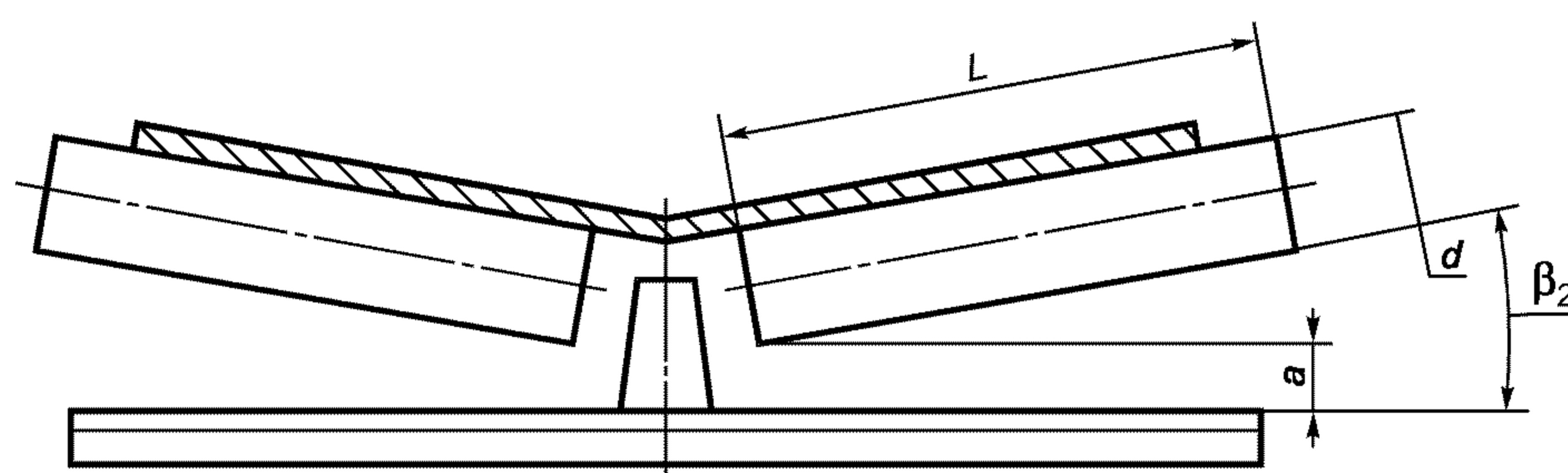
Рисунок 3 — Жесткая двухроликовая опора
