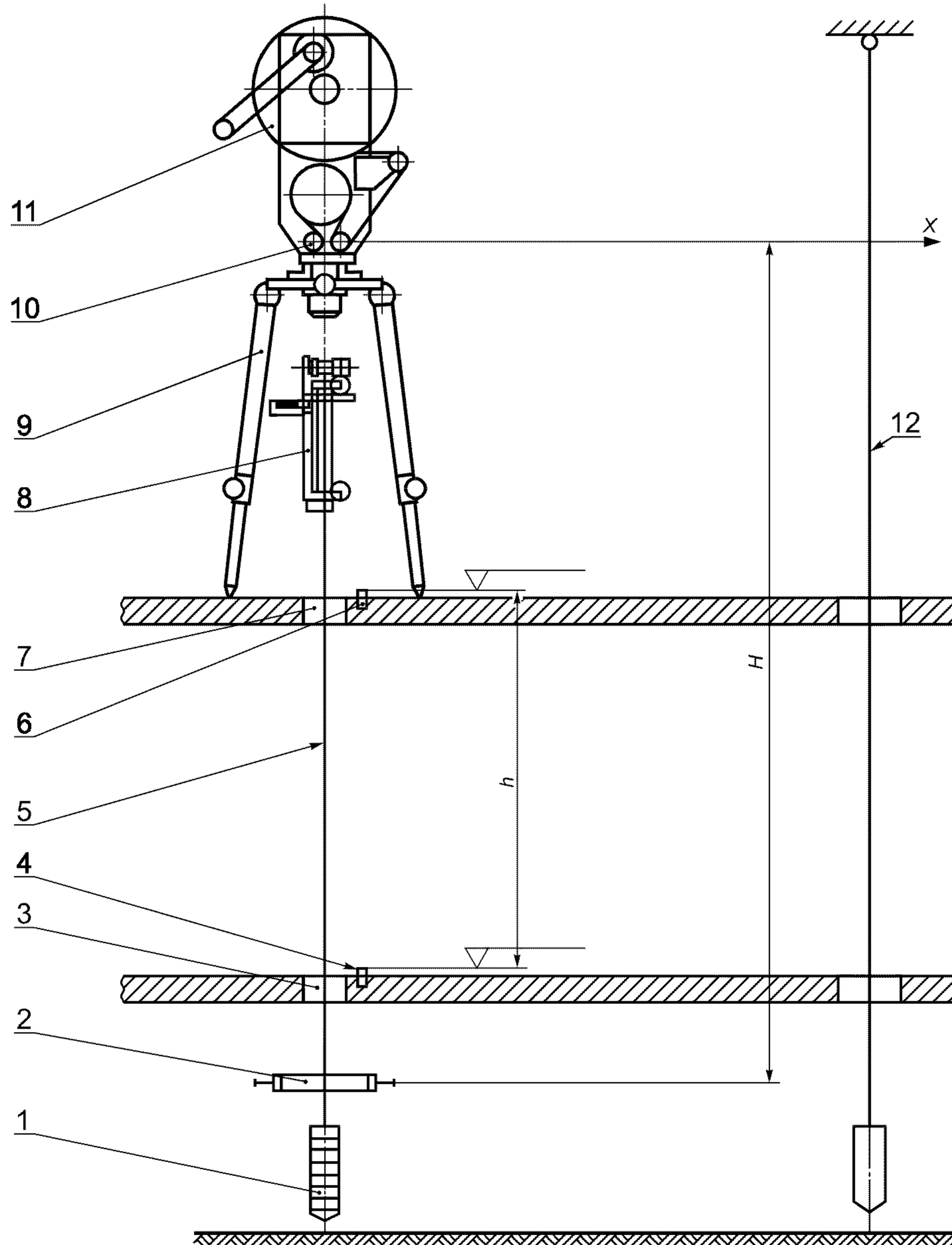
1 — груз-рейка; 2 — устройство для фиксирования и перемещения каната; 3 — отверстие нижнего перекрытия; 4 — нижний репер; 5 — канат проекционетра; 6 — верхний репер; 7 — отверстие верхнего перекрытия; 8 — уровень; 9 — штатив; 10 — точка схода каната с направляющего ролика; 11 — бобина; 12 — канат вспомогательного отвеса
