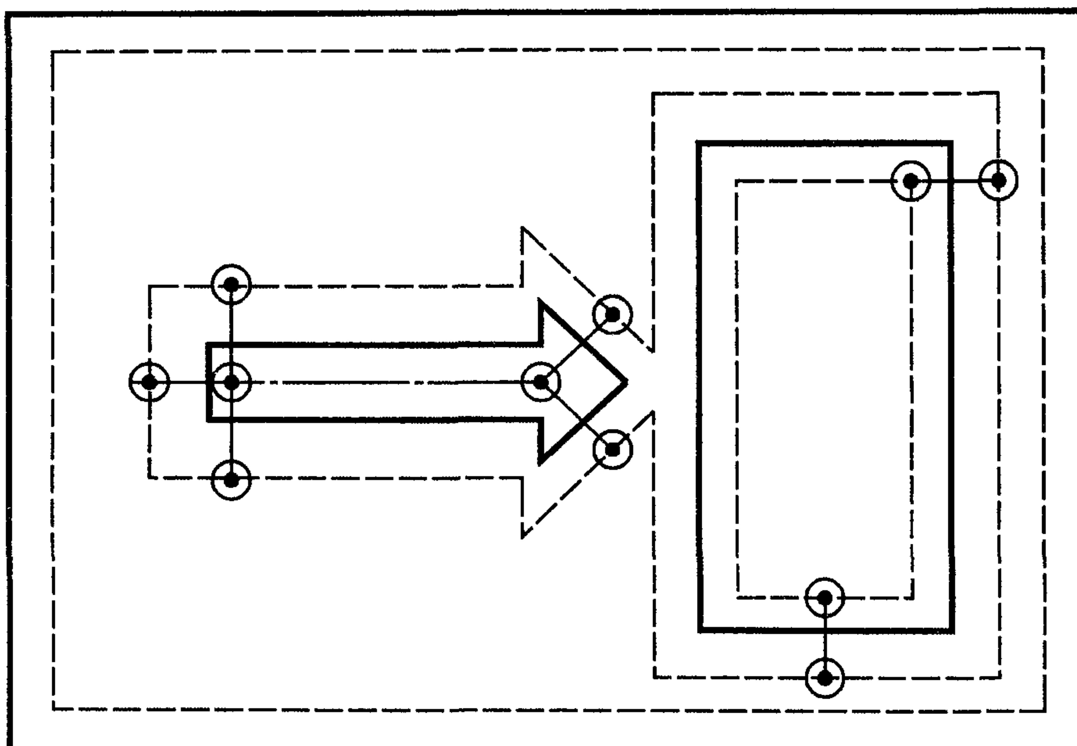
Рисунок С.1 — Типовой пример расположения точек измерения
