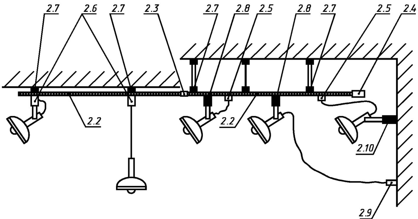
2.2 — секция шинопровода; 2.3 — соединитель; 2.4 — вводное устройство (может включать трансформатор); 2.5 — штепсель (питание только от секции шинопровода); 2.6 — адаптер для механического и электрического присоединения светильника к шинопроводу; 2.7 — подвес шинопровода (к потолку, к подвеске из труб или проволоки); 2.8 — подвес светильника; 2.9 — независимая коробка с розеткой; 2.10 — механическое закрепление светильника к стене.
