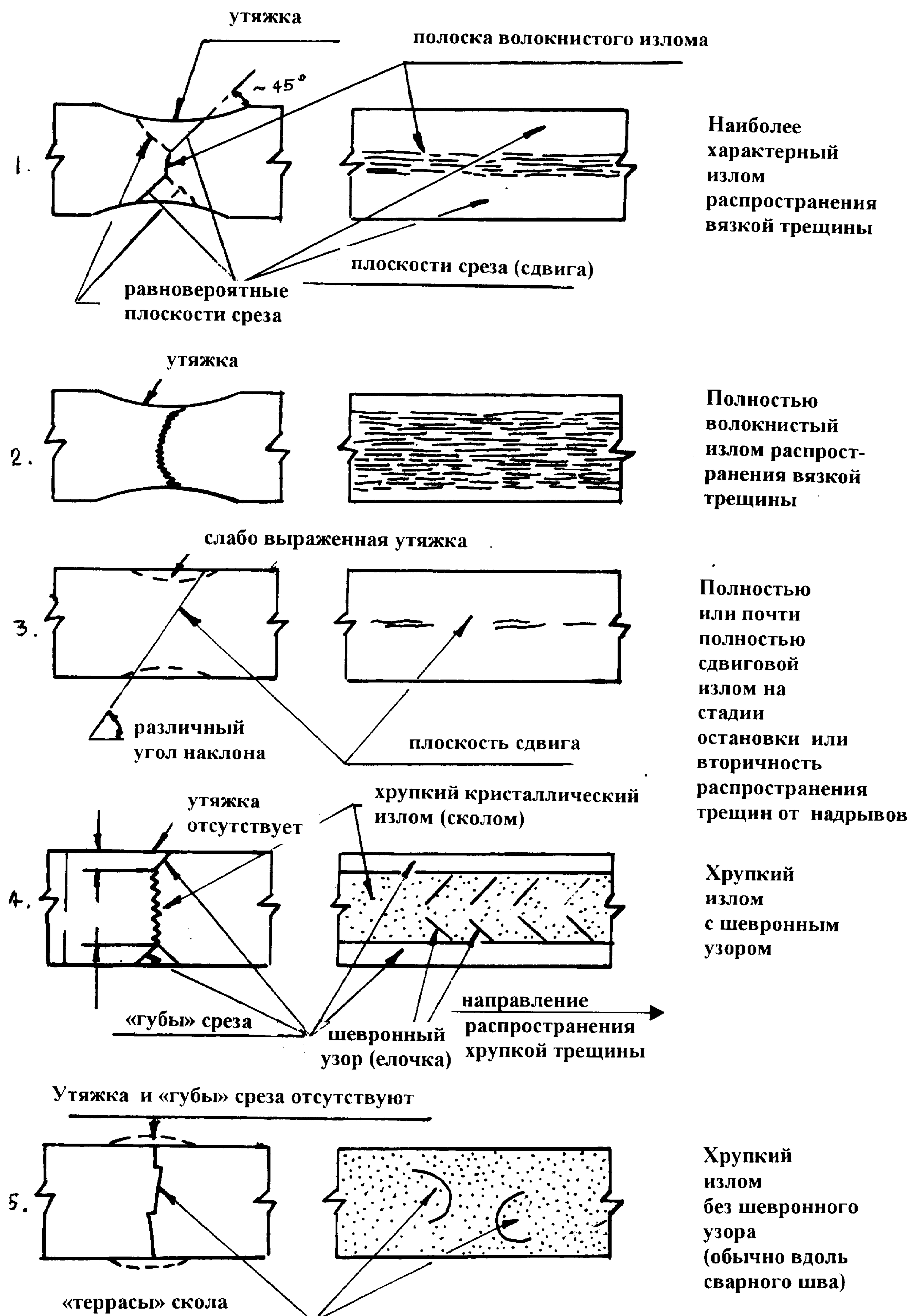
Рис. 1. Типы изломов, образованные распространением трещины
