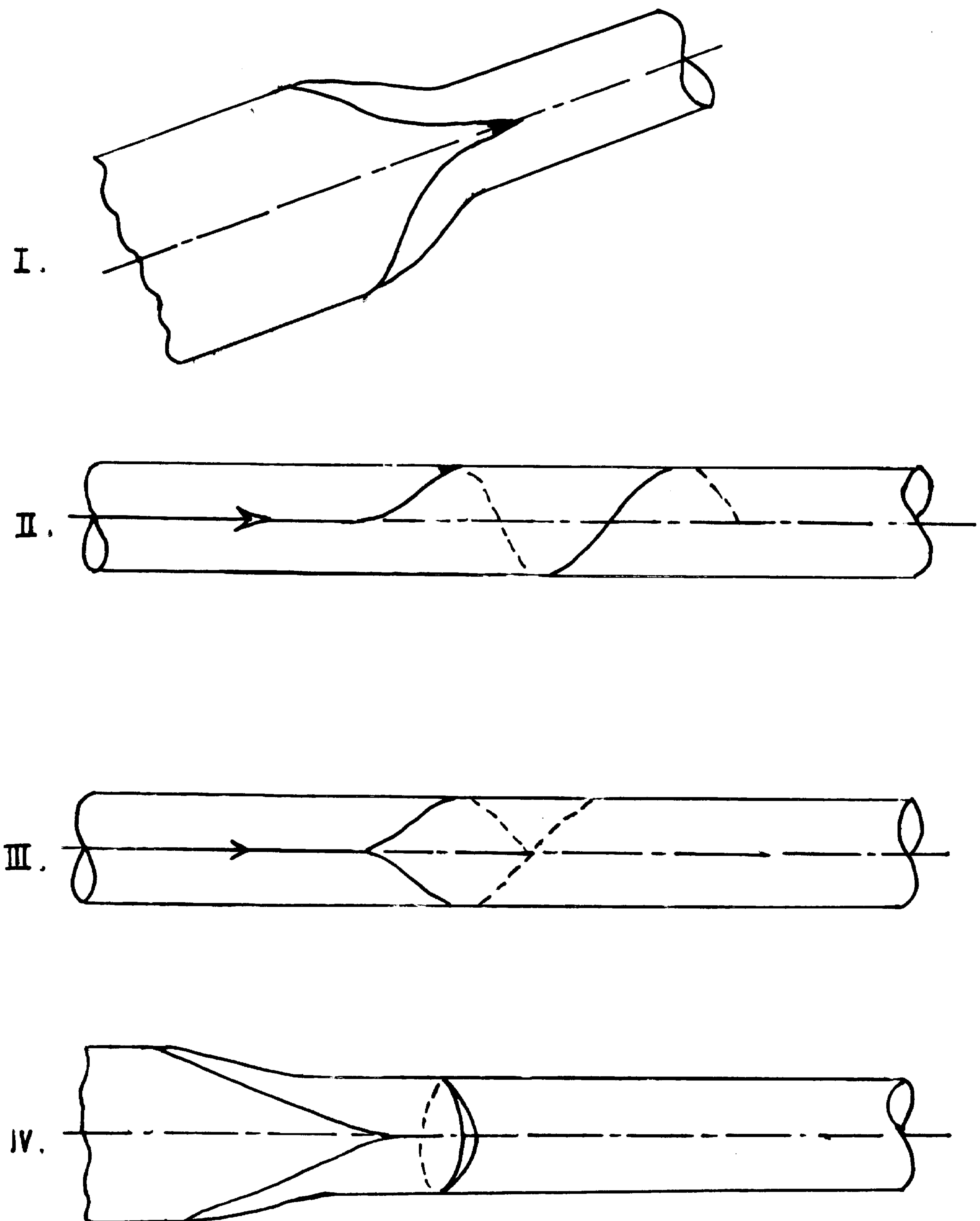
Рис. 2. Типы остановок вязких разрушений:
