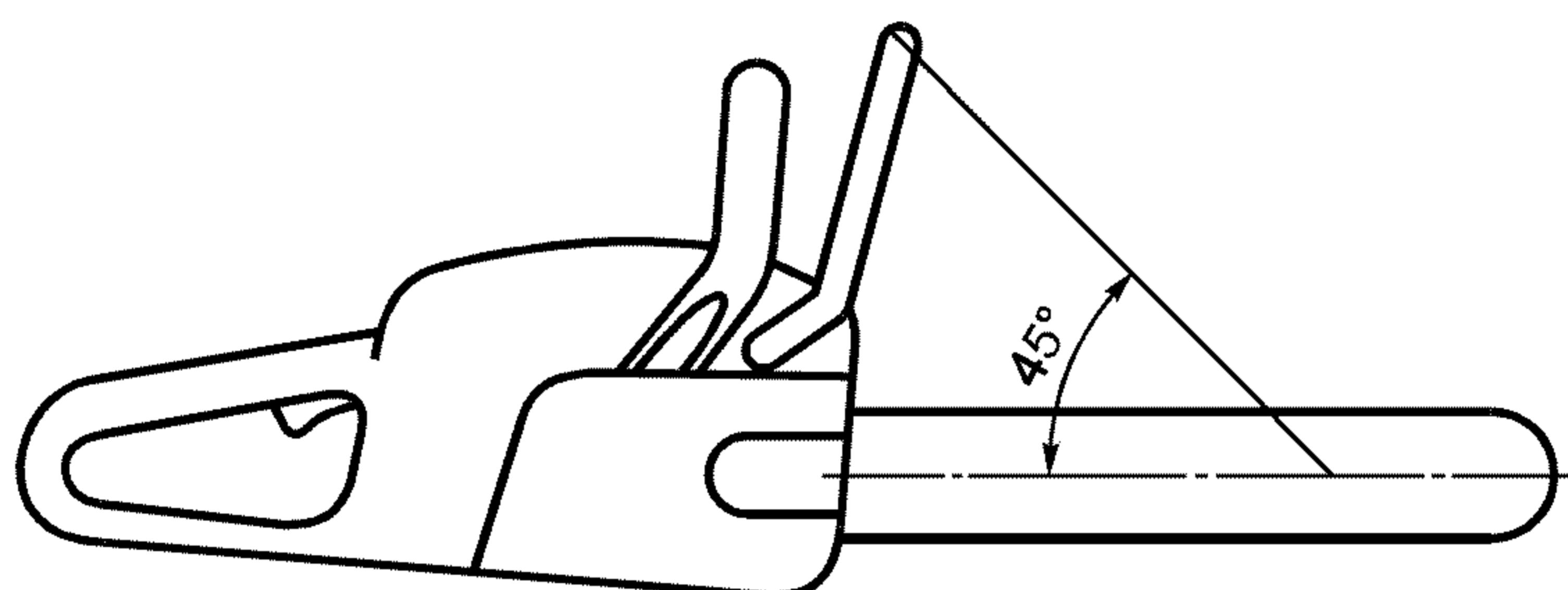
Рисунок 2 — Статическое испытание на усилие срабатывания тормоза
