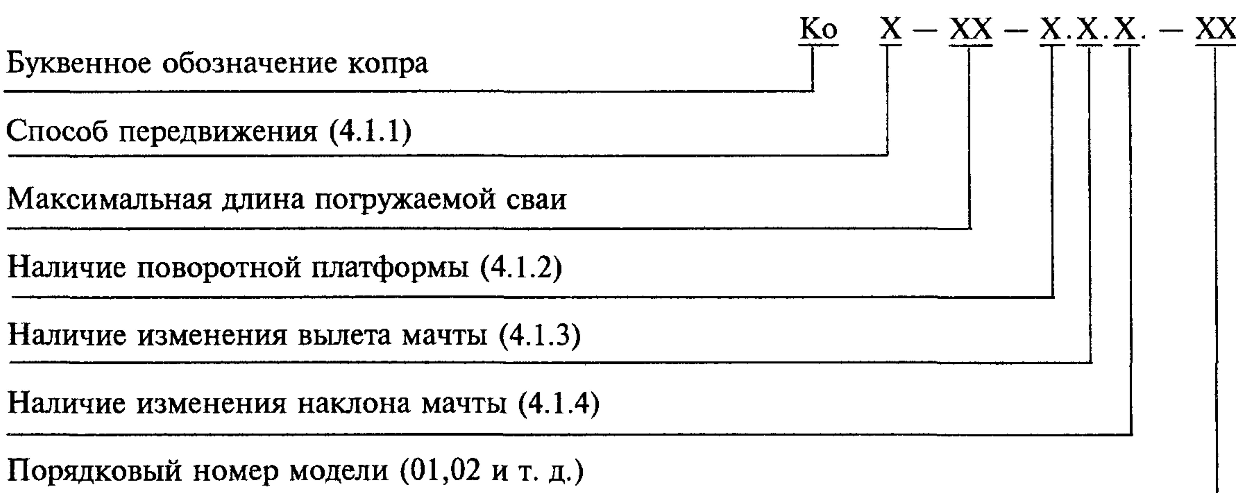
Пример условного обозначения копра на гусеничном ходу для забивки свай длиной до 14 м, с поворотной платформой, без изменения вылета и наклона мачты, второй модели:
