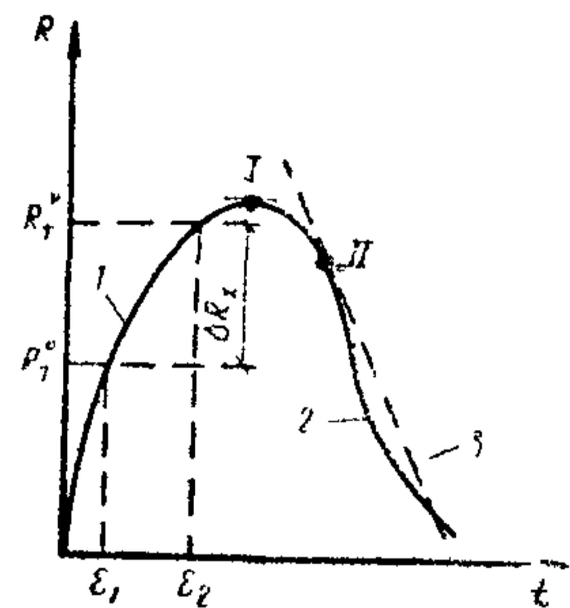
Рис. 5. Диаграмма состояния бетона
