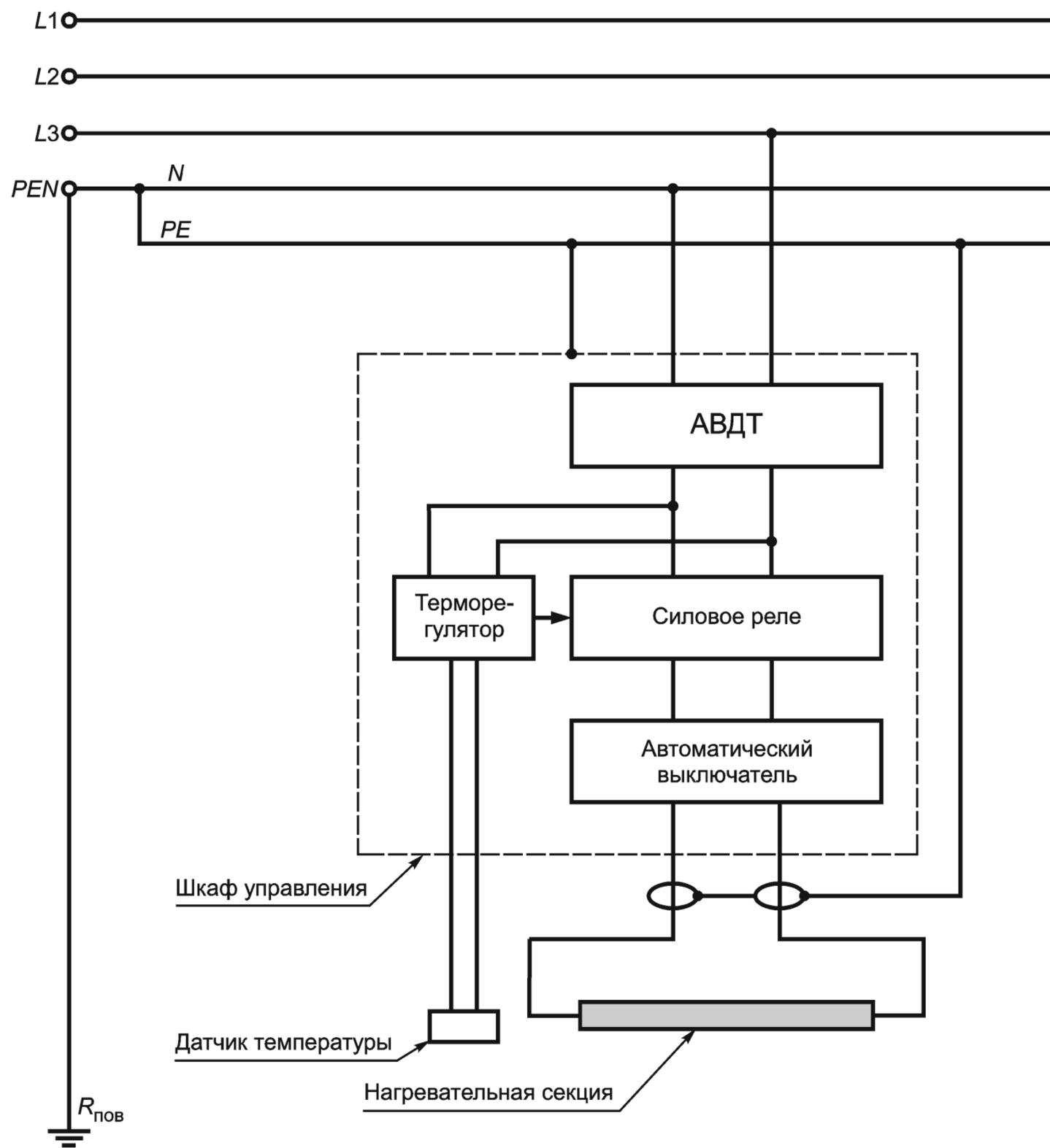
АВДТ — автоматический выключатель дифференциального тока по ГОСТ Р 51327.1;  $R_{пов}$  — заземлитель повторного заземления PEN-проводника
