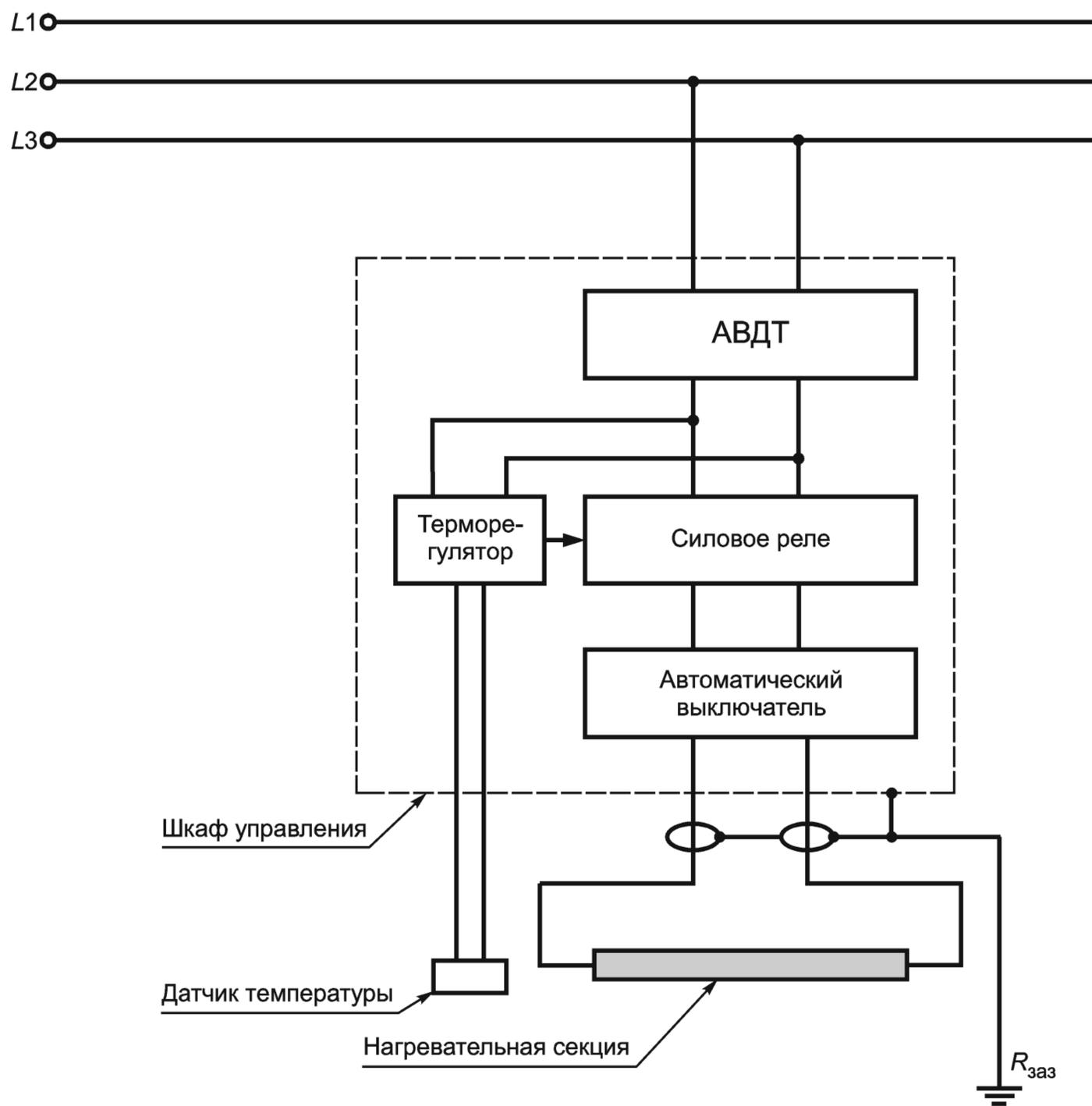
АВДТ — автоматический выключатель дифференциального тока по ГОСТ Р 51327.1;  $R_{\text{заз}}$  — заземлитель установки
