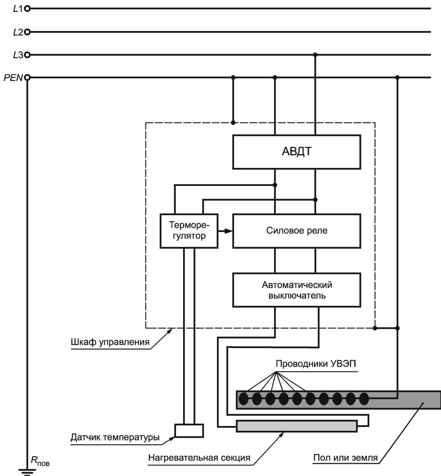
АВДТ — автоматический выключатель дифференциального тока по ГОСТ Р 51327.1;  $R_{пов}$  — заземлитель повторного заземления PEN-проводника; УВЭП — устройство выравнивания электрических потенциалов
