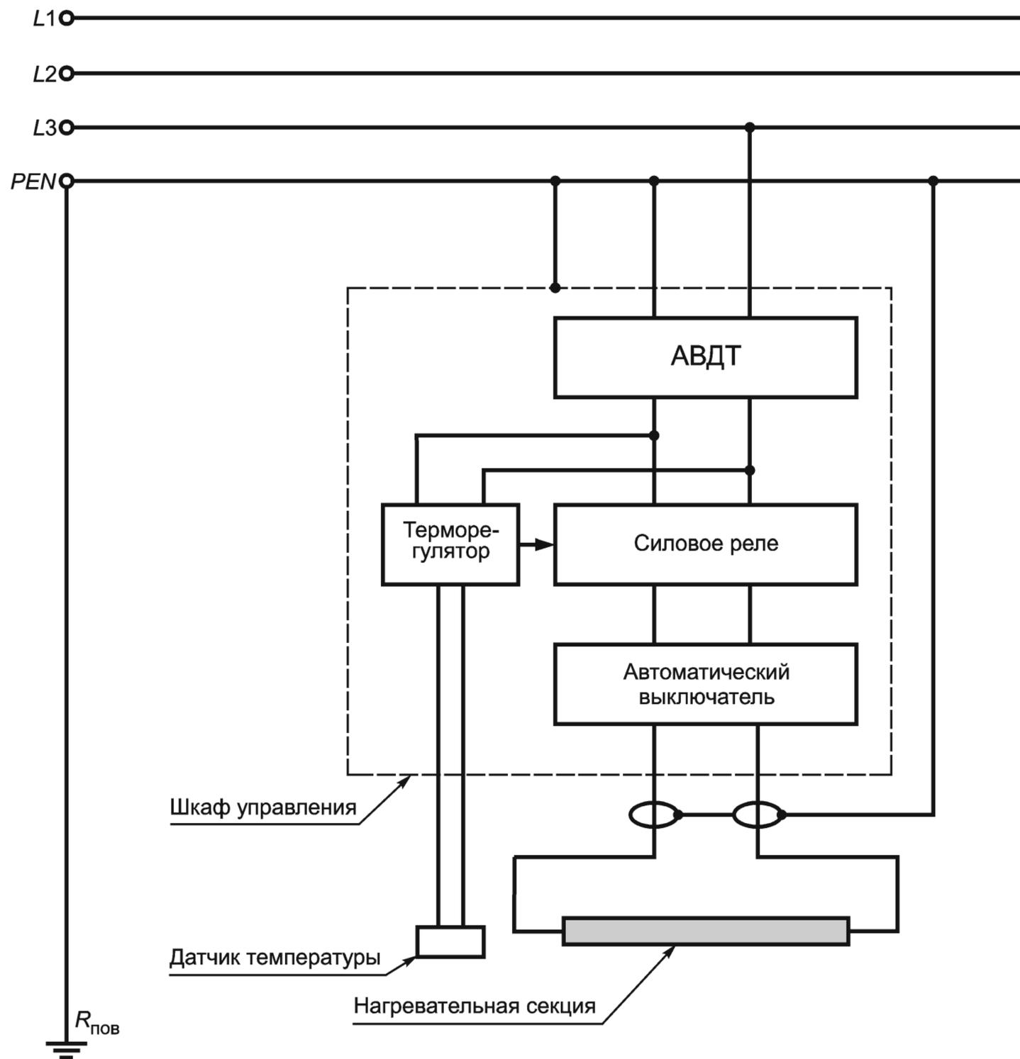
АВДТ — автоматический выключатель дифференциального тока по ГОСТ 51327.1;  $R_{пов}$  — заземлитель повторного заземления PEN-проводника
