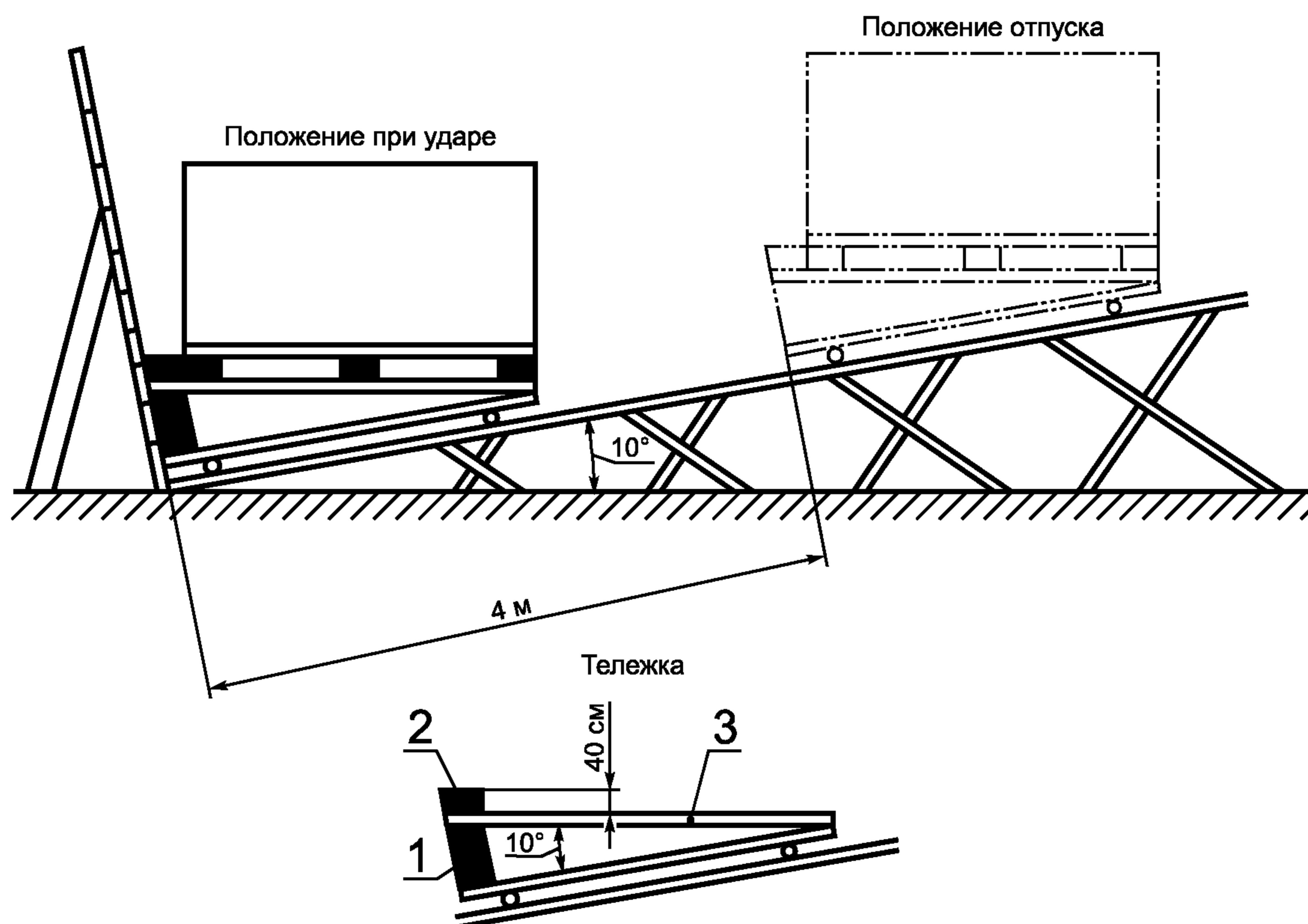
1 — блок для установки платформы; 2 — блок-останов; 3 — платформа
