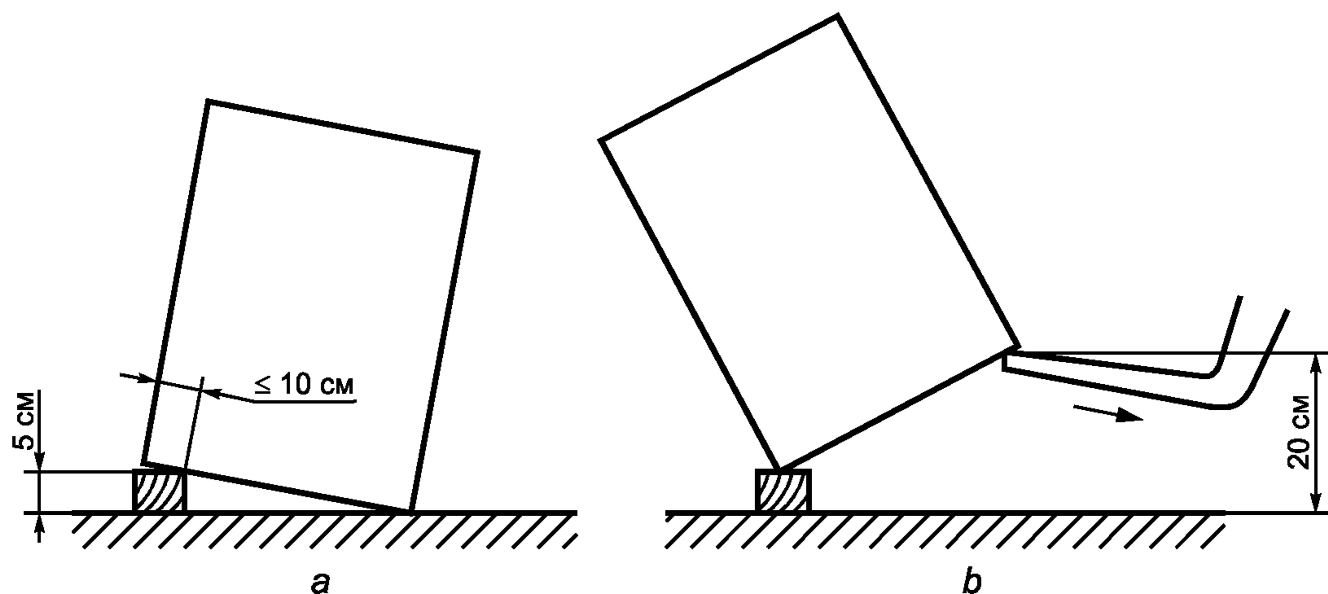
Рисунок 2 — Испытание на сбрасывание плашмя на основание
