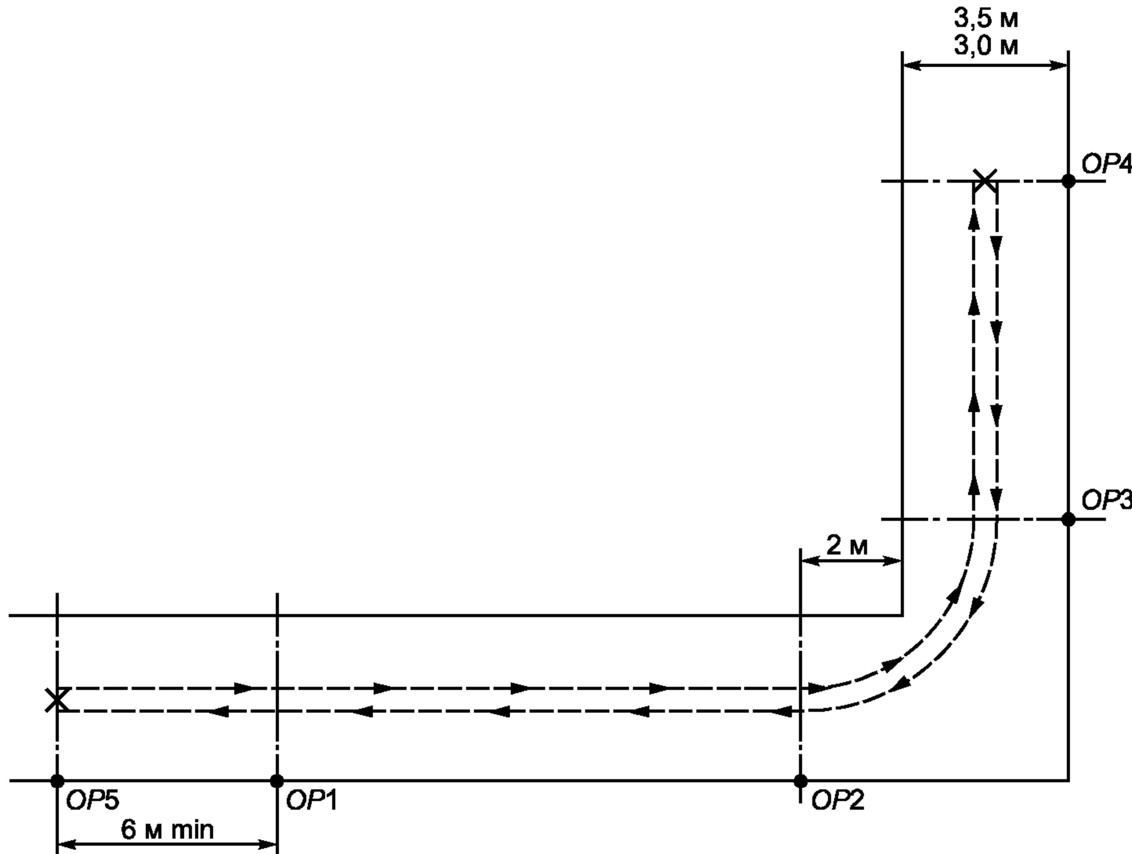
*OP5* — подъем/опускание; *OP5*—*OP1* — зона ускорения/торможения; *OP1*—*OP2* — зона с препятствиями; *OP2*—*OP3* — поворот 90°; *OP4* — подъем/опускание
