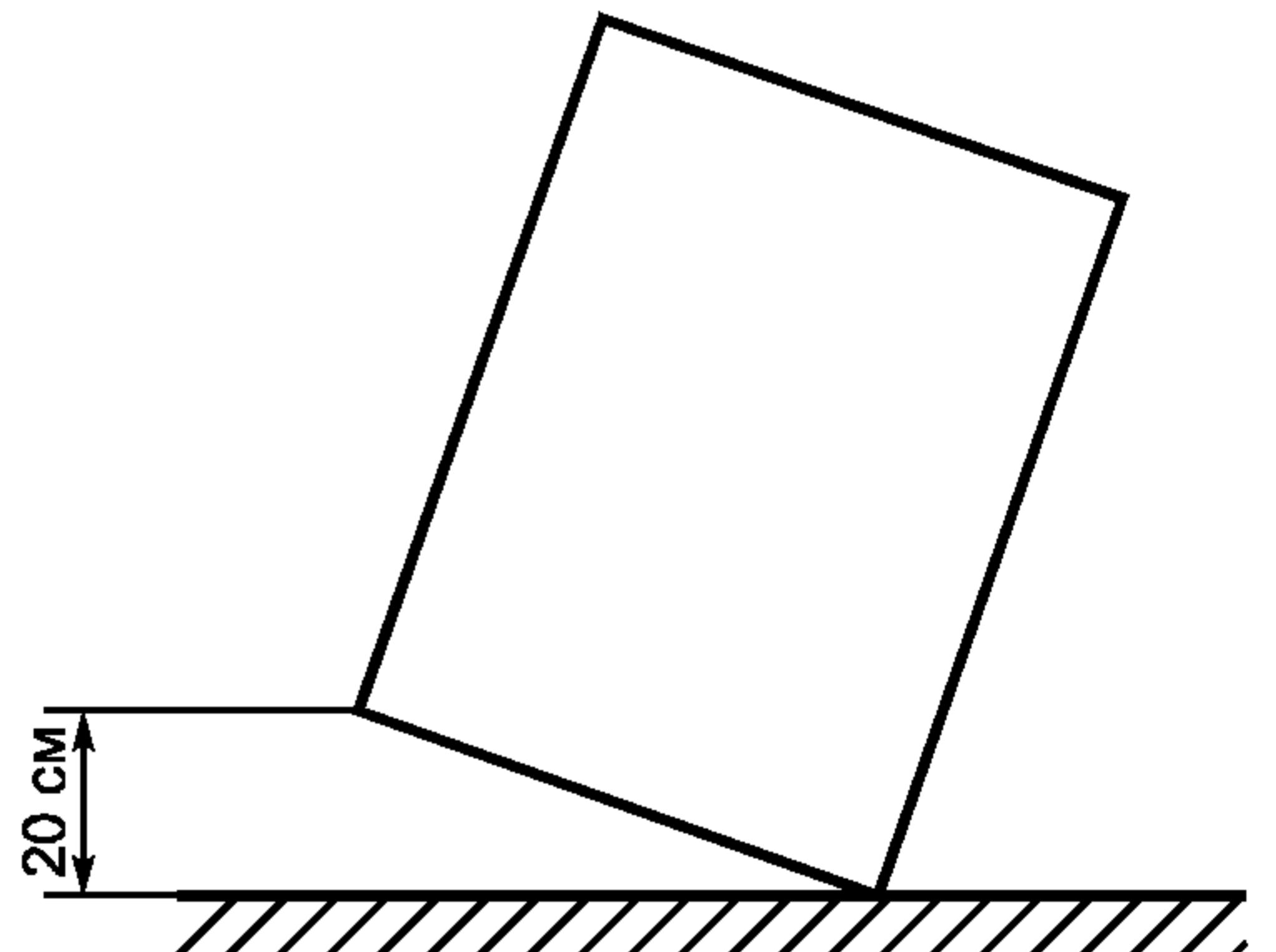
Рисунок 1 — Испытание на удар нижним ребром основания
