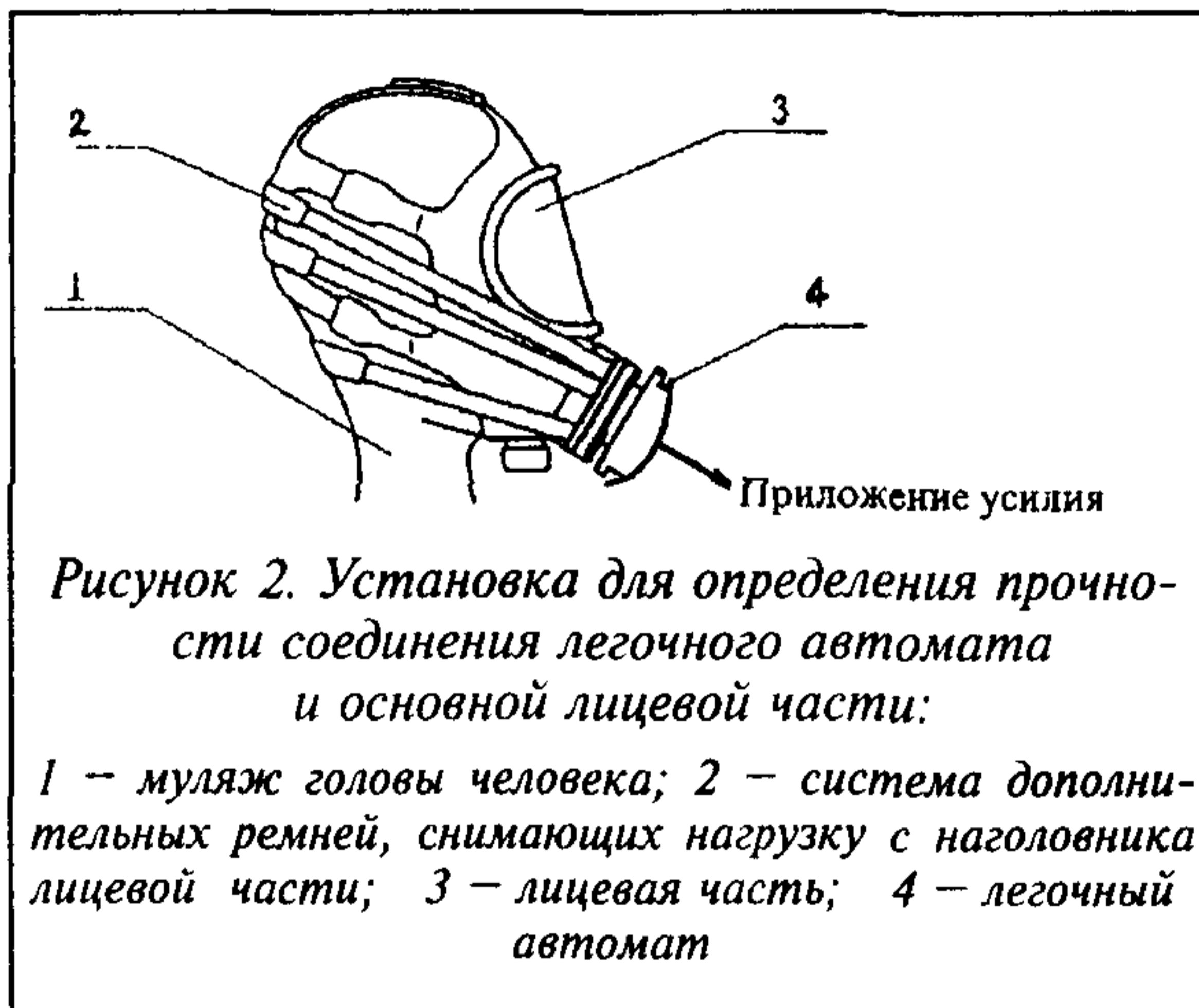
*Рисунок 2. Установка для определения прочности соединения легочного автомата и основной лицевой части:*
