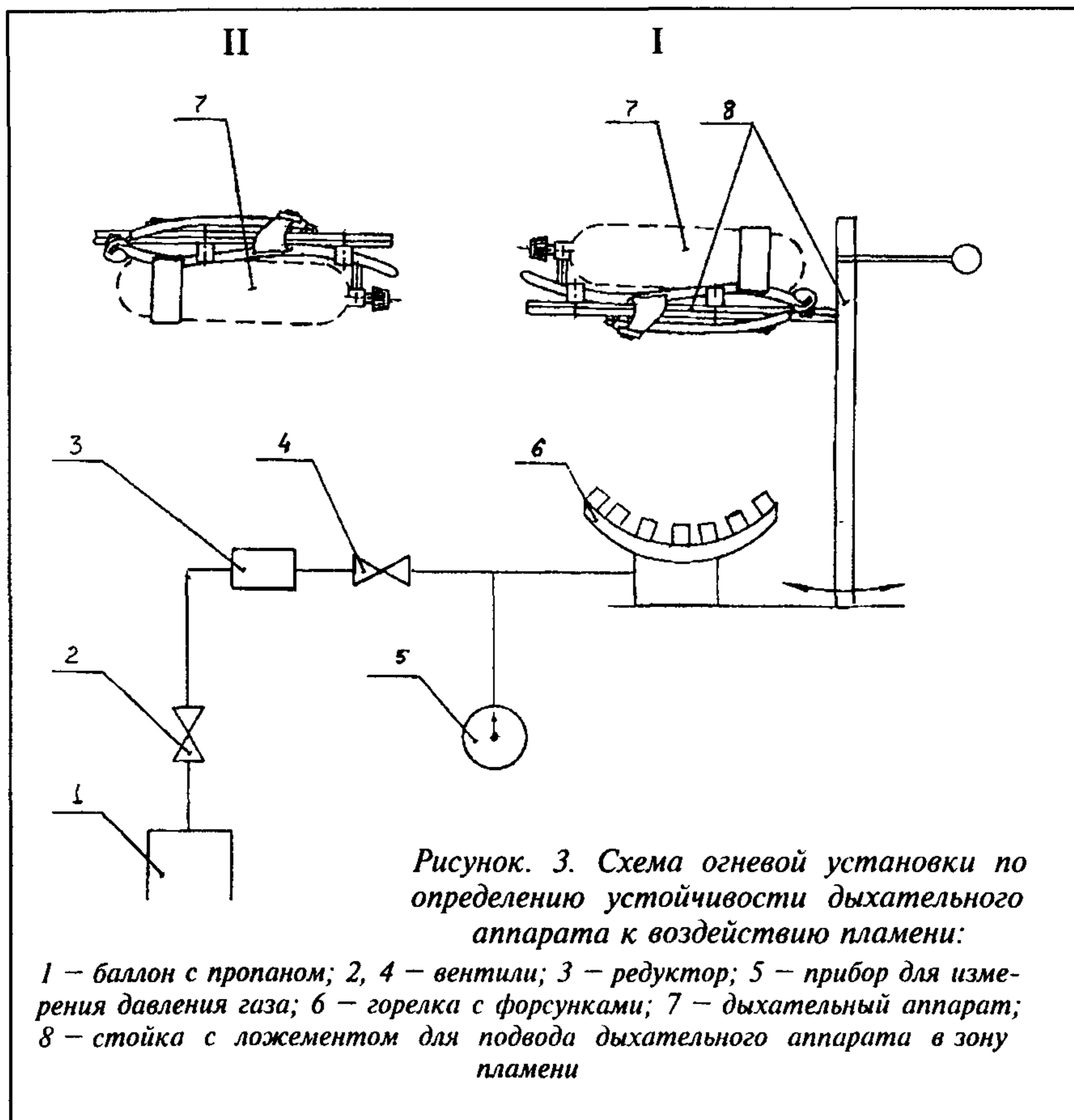
*Рисунок. 3. Схема огневой установки по определению устойчивости дыхательного аппарата к воздействию пламени:*
