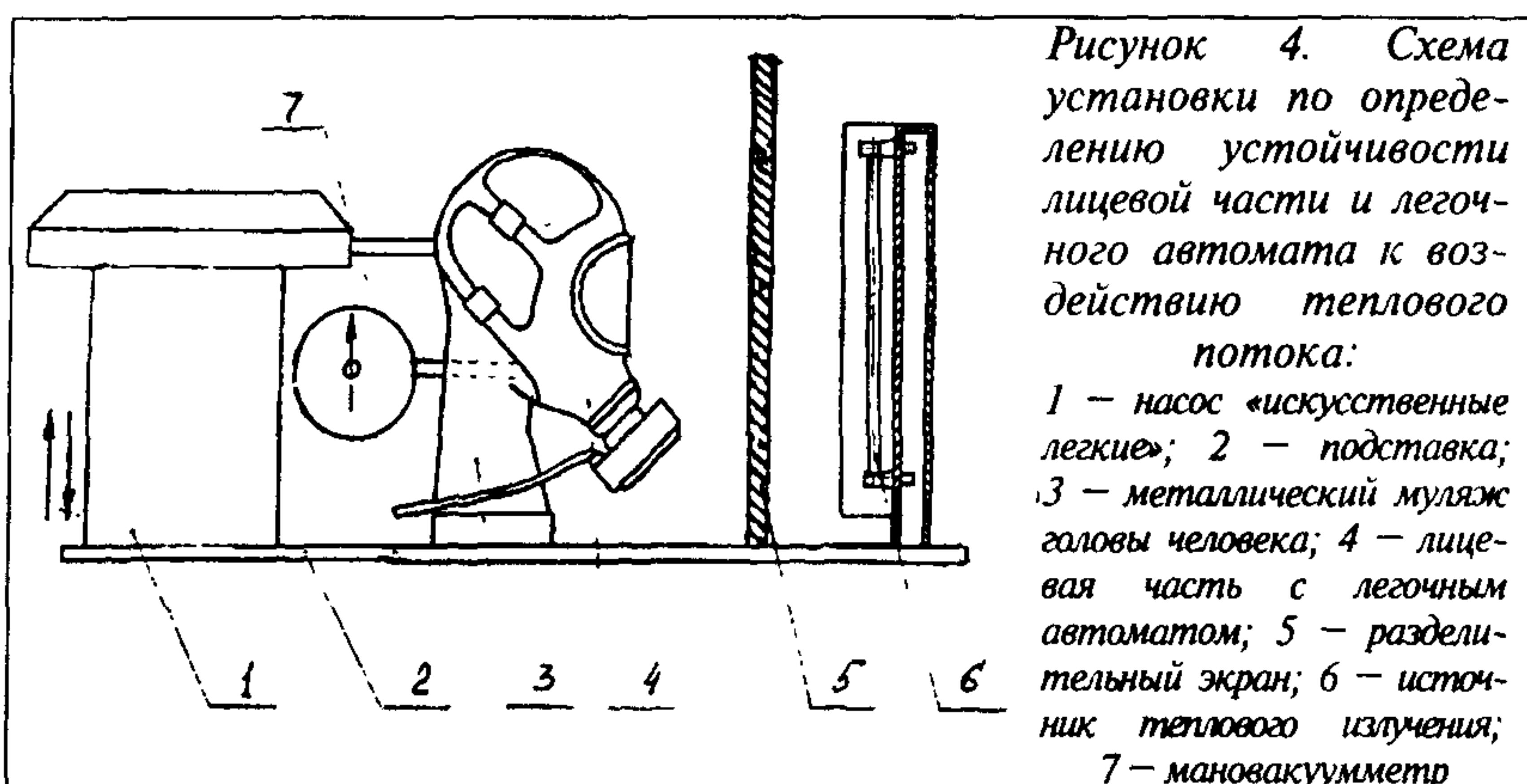
Включают источник теплового потока и с помощью датчика теплового потока определяют место, в котором плотность теплового потока составляет  $(8,5 \pm 0,5)$  кВт/м<sup>2</sup>, и отмечают данное место на подставке. Устанавливают на подставку разделятельный экран. На отмеченное место ставят муляж головы че-
