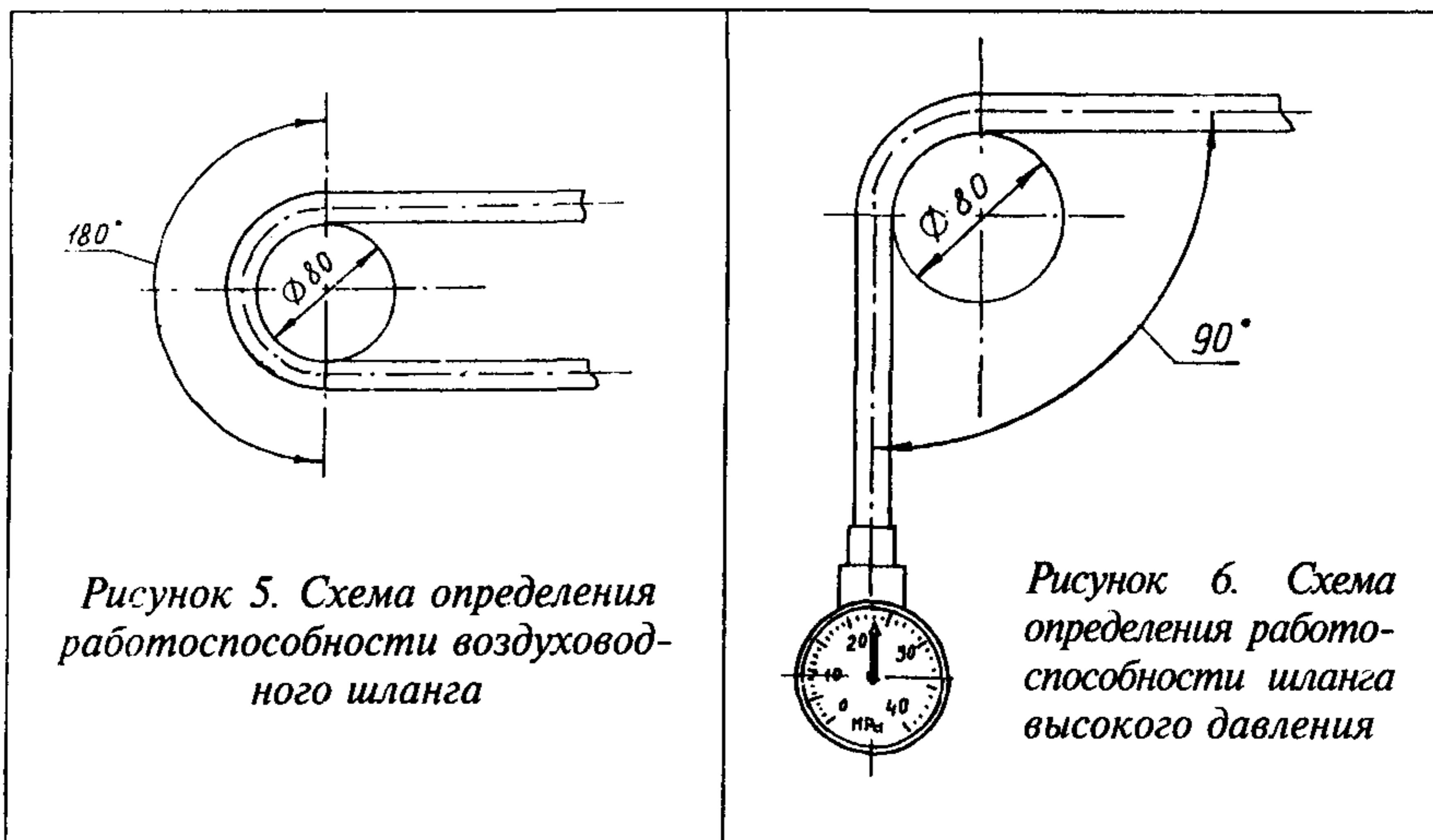
*Рисунок 5. Схема определения работоспособности воздуховодного шланга*
