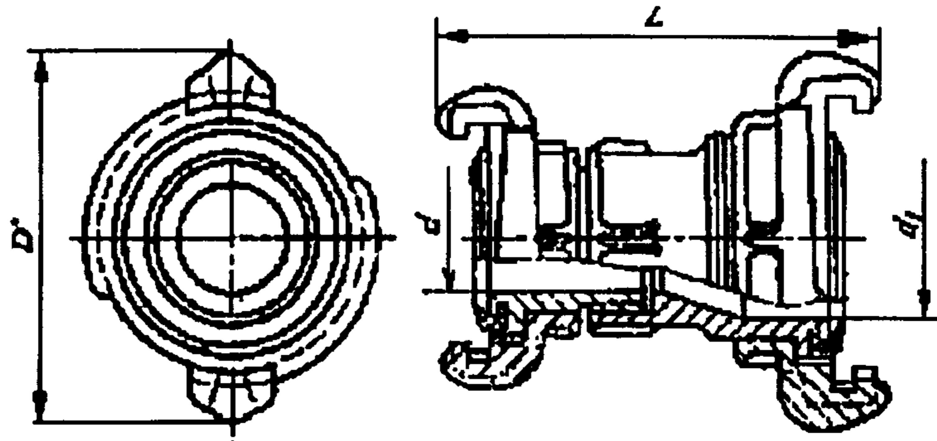
*Рисунок 4. Переходная напорная головка*
