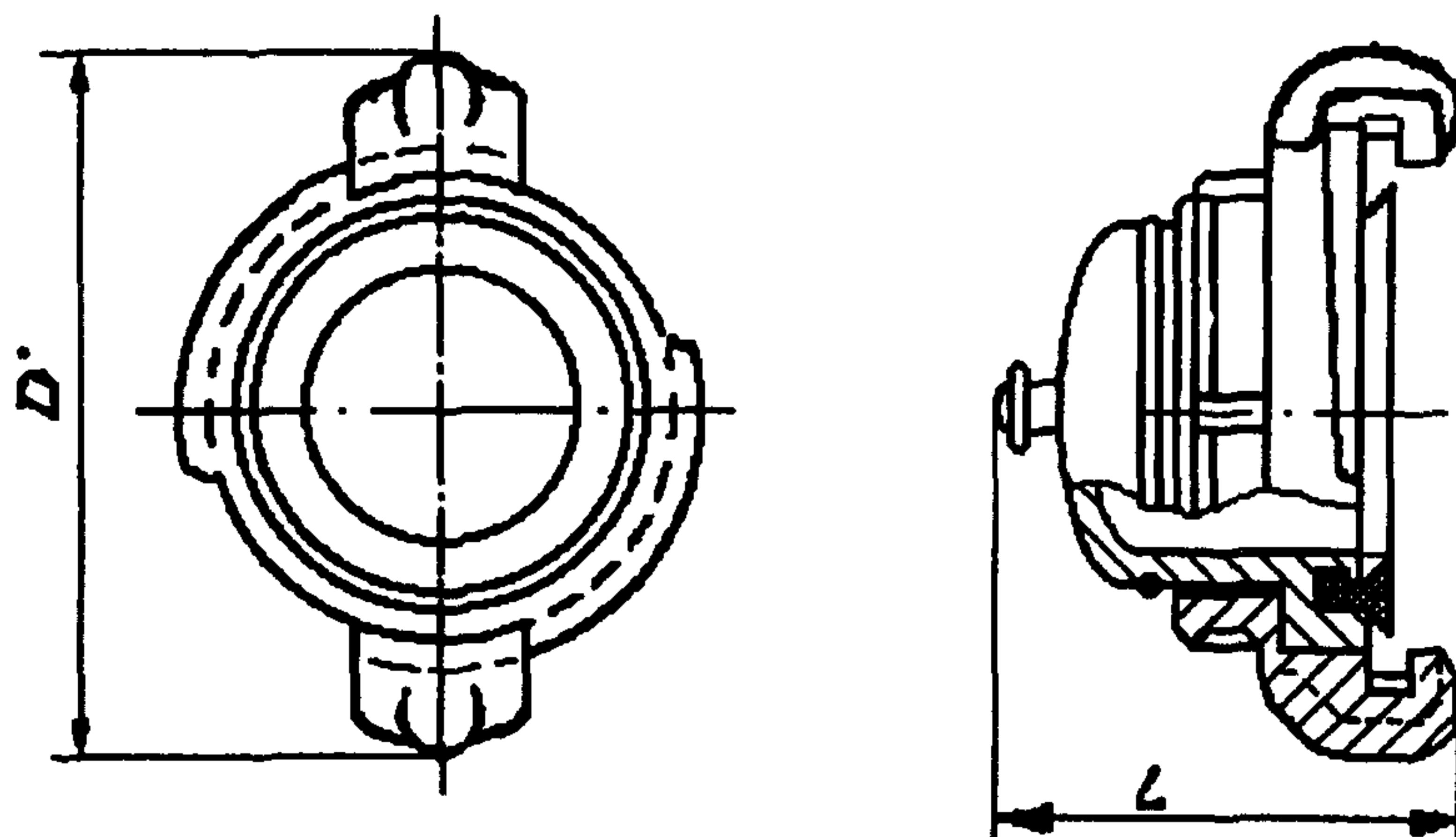
*Рисунок 8. Всасывающая головка-заглушка*
