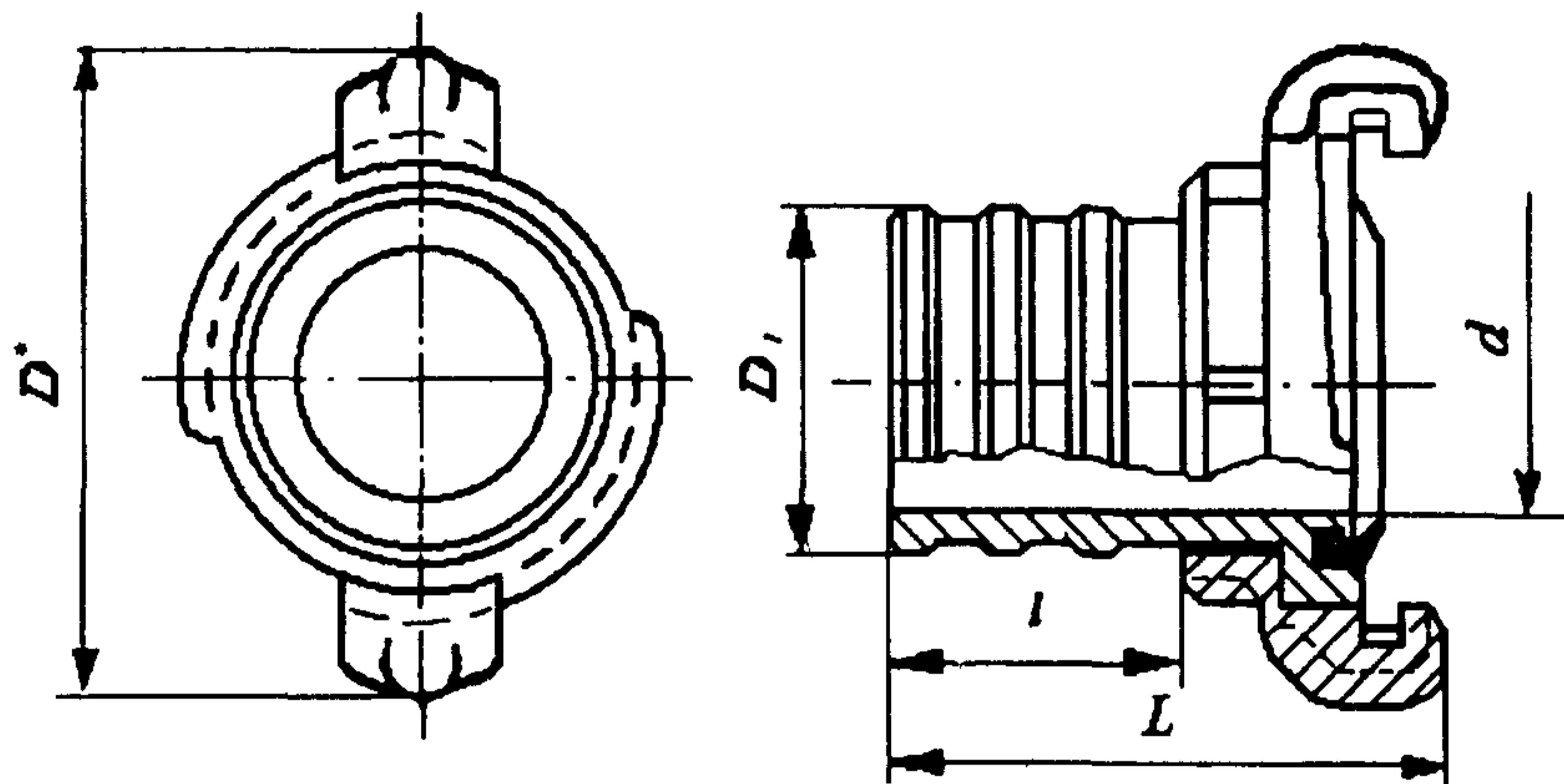
*Рисунок 1. Рукавная напорная головка*
