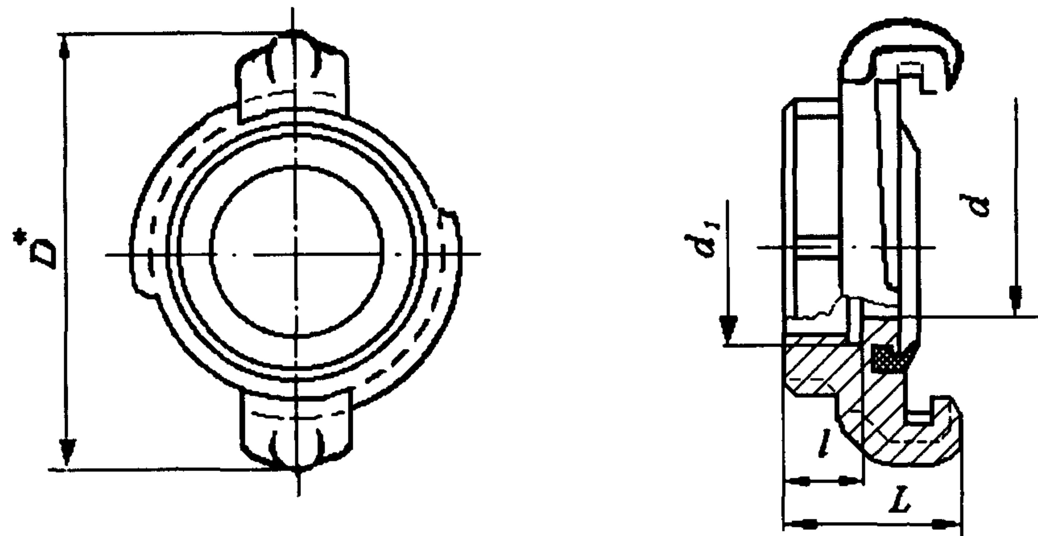
*Рисунок 2. Муфтовая напорная головка*
