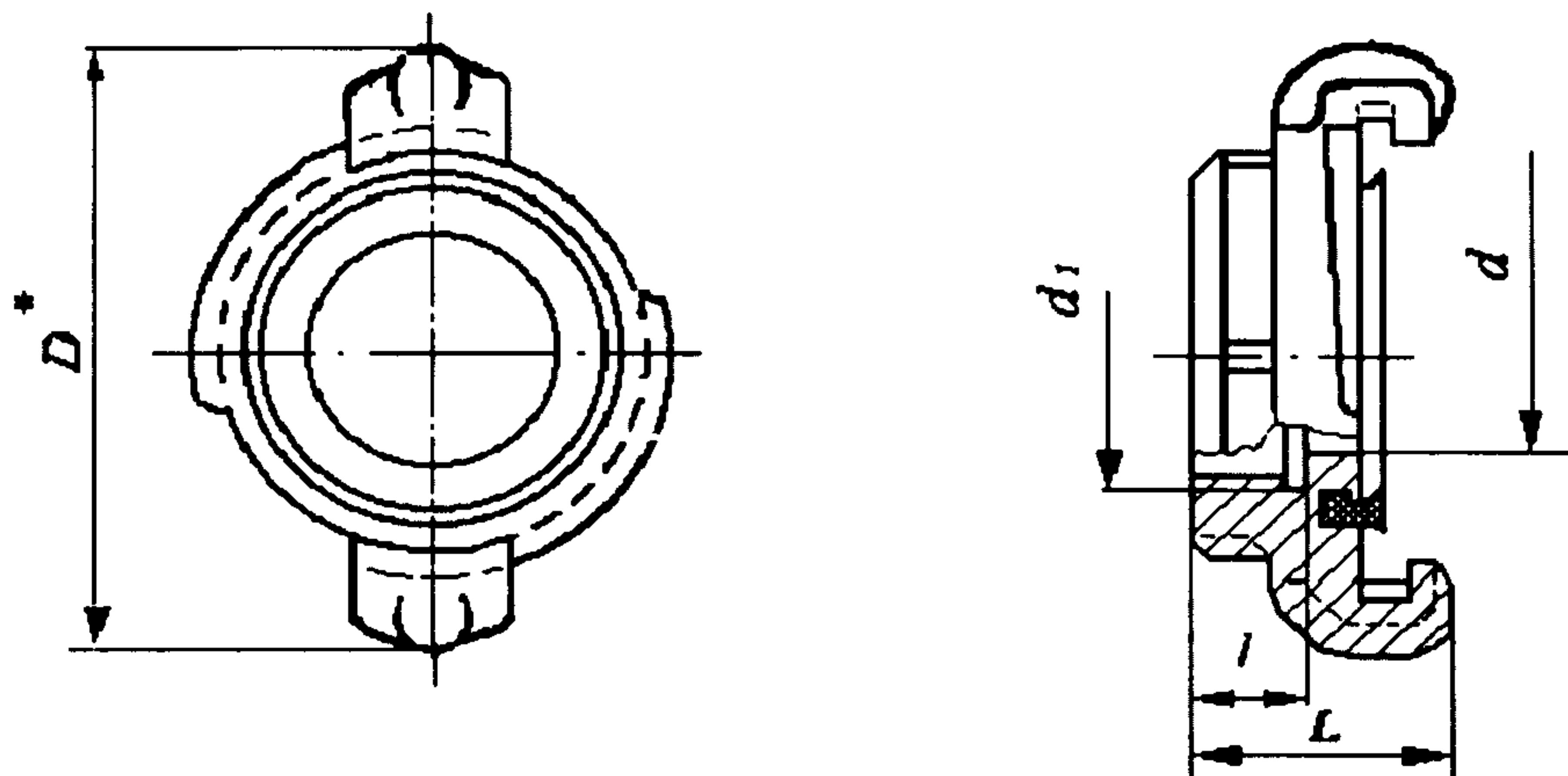
*Рисунок 7. Муфтовая всасывающая головка*
