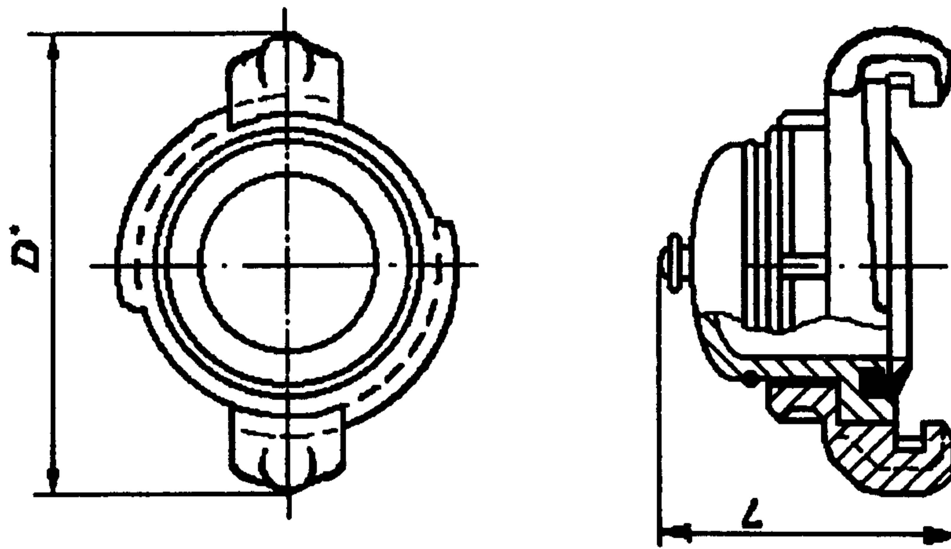
Рисунок 5. Напорная головка-заглушка
