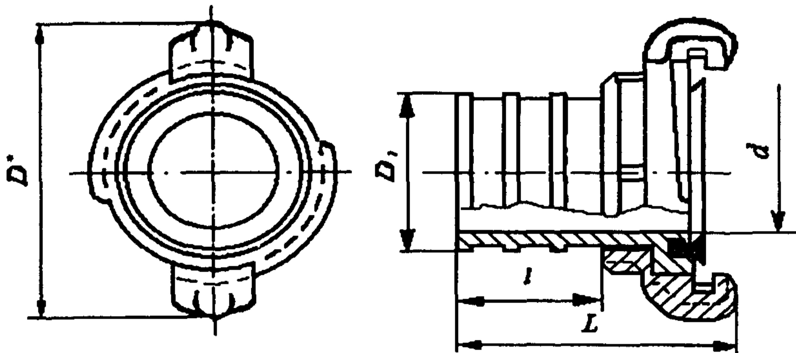
*Рисунок 6. Рукавная всасывающая головка*
