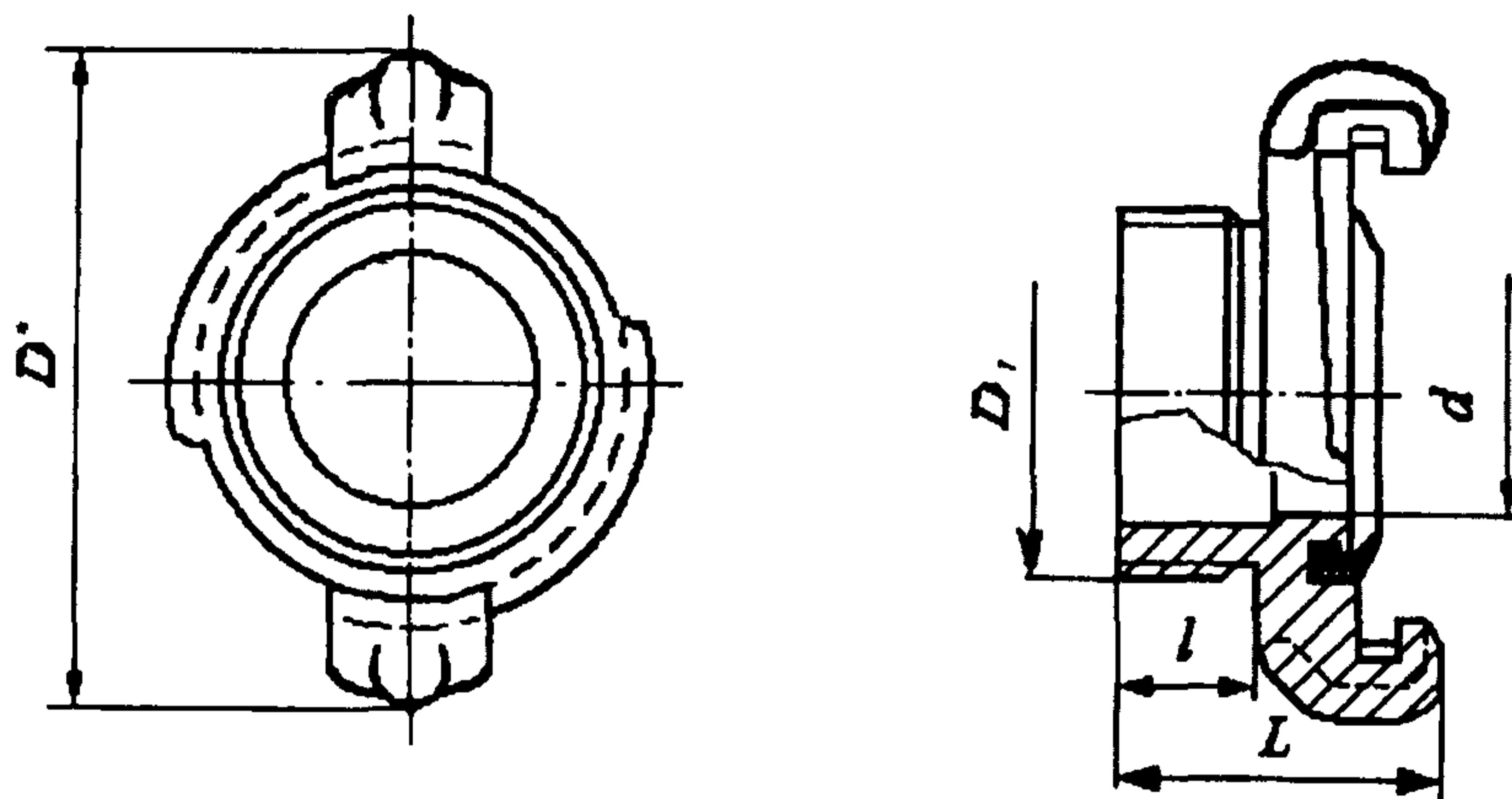
*Рисунок 3. Цапковая напорная головка*
