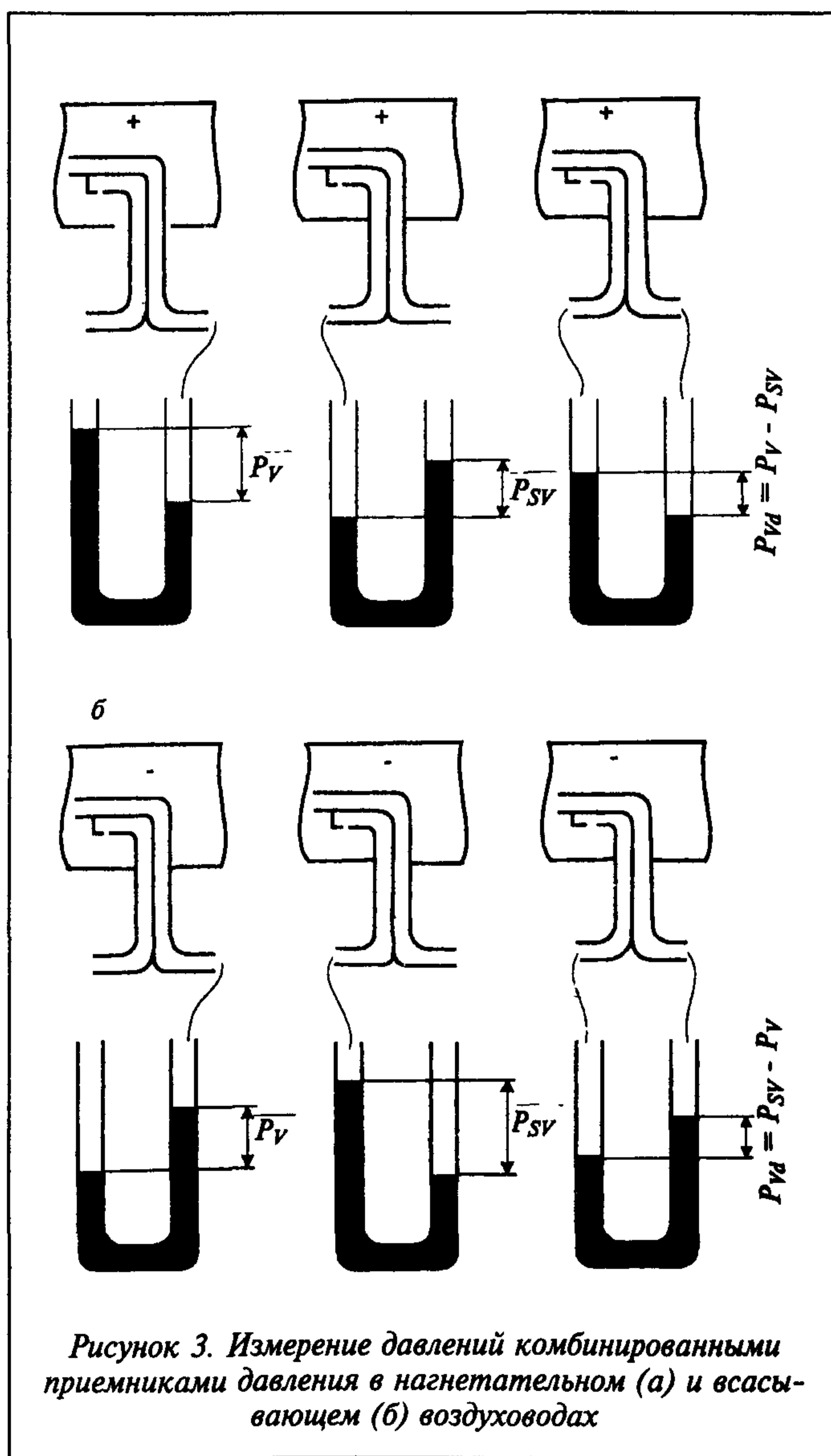
*Рисунок 3. Измерение давлений комбинированными приемниками давления в нагнетательном (а) и всасывающем (б) воздуховодах*
