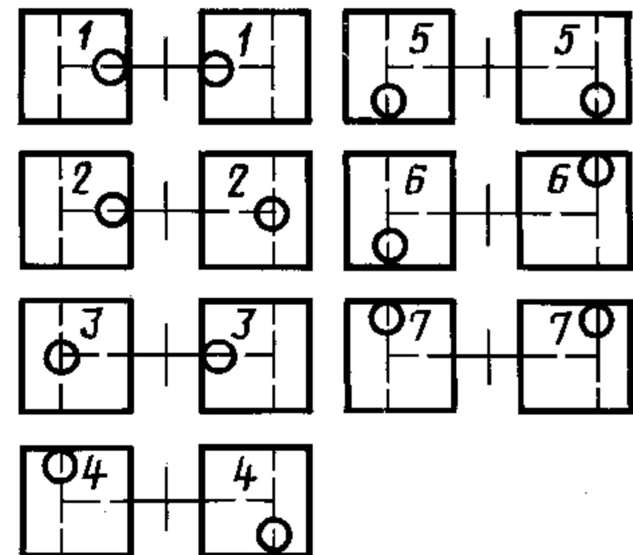
На настольных гирных и циферблатных весах с двумя площадками парные образцовые гири размещают в центре площадок, а затем в положения, указанные на чертеже. Если при каком-либо положении гирь настольные гирные весы не придут в положение равновесия, то при помещении на соответствующую чашку гири-допуска, равной по массе допускаемой погрешности, указатели должны сойтись или перейти положение равновесия.
