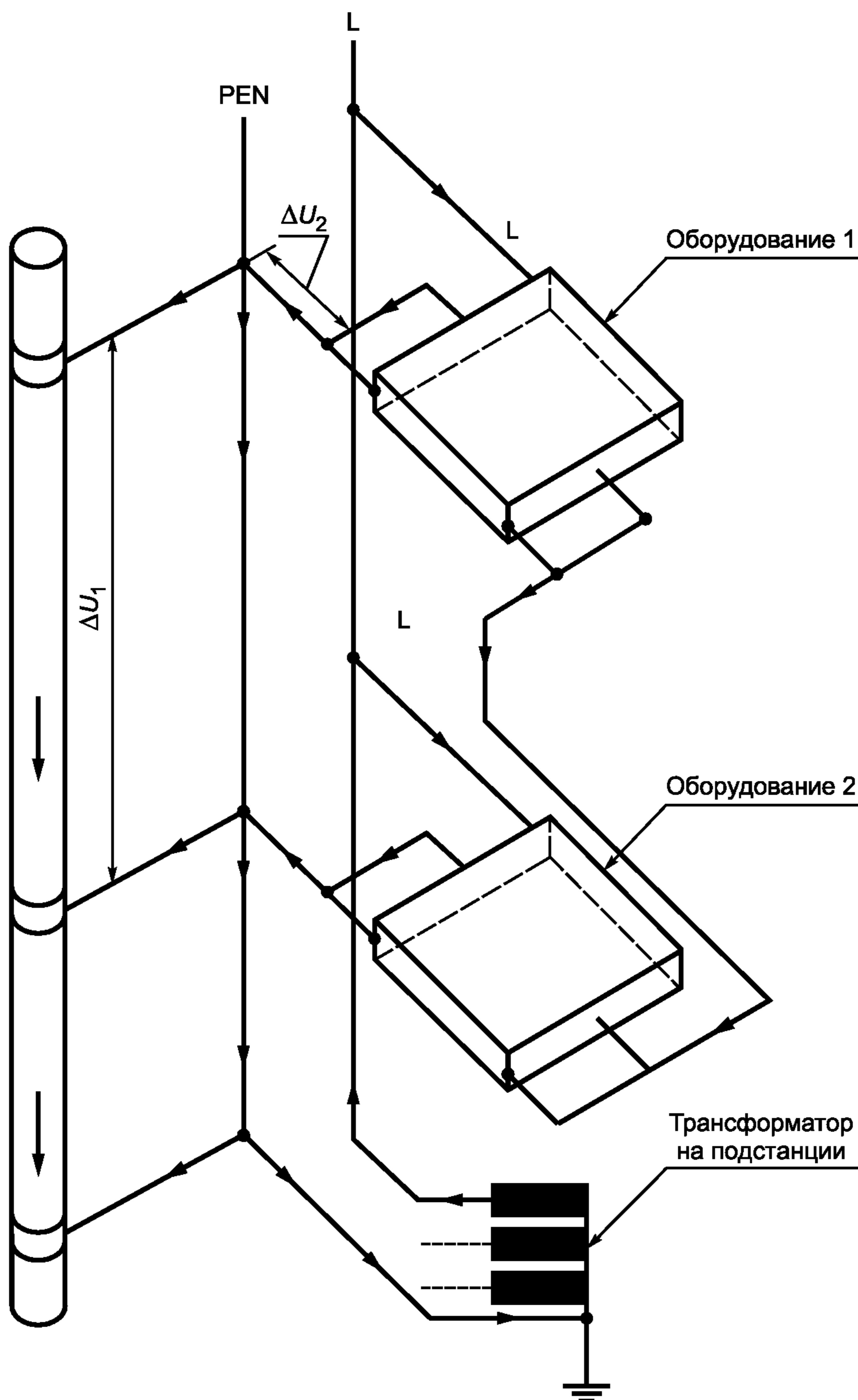
Рисунок 2а — Система заземления типа TN-C
