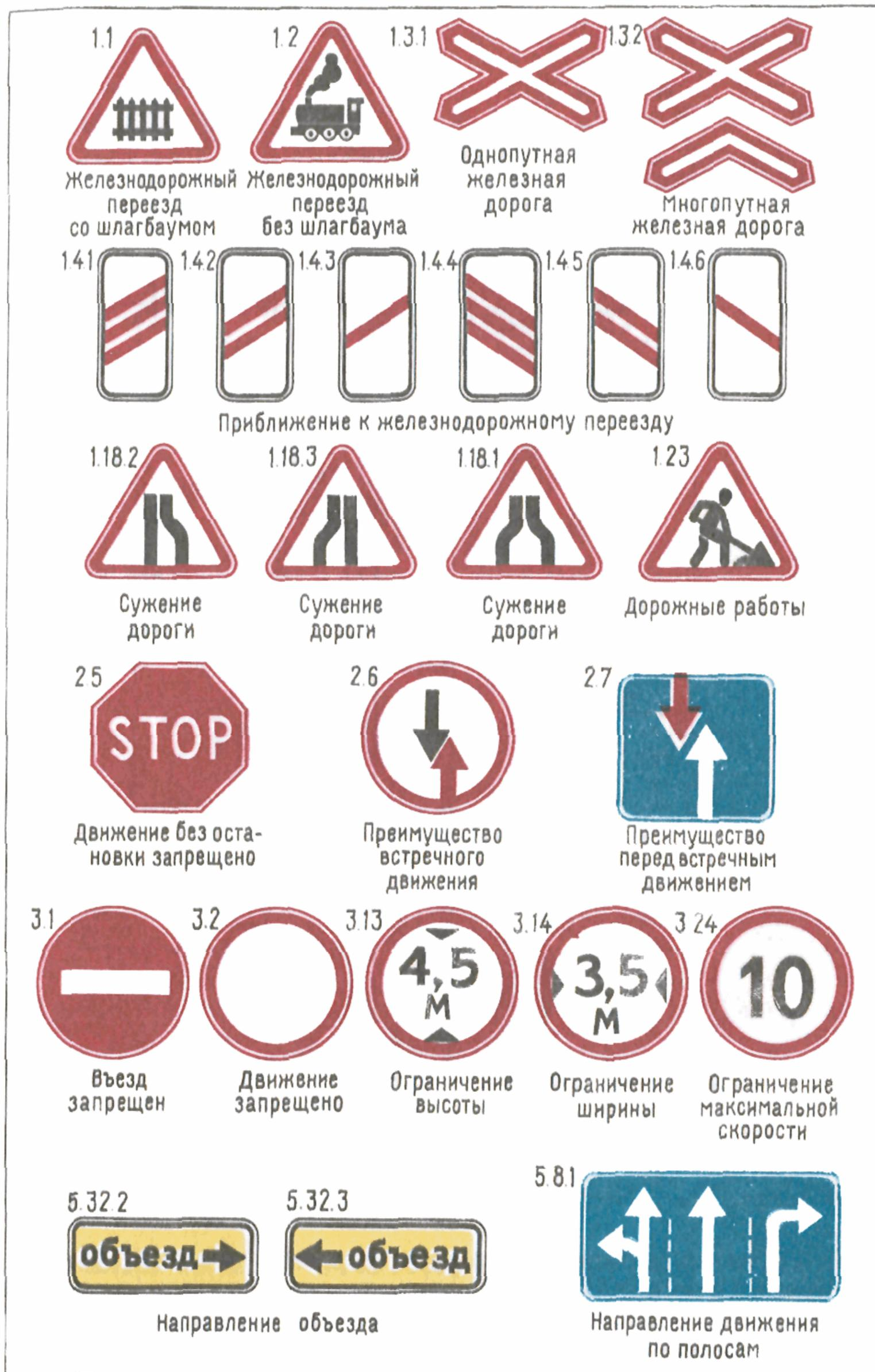
Рис. 1. Дорожные знаки и таблички, устанавливаемые на подходах к переездам, местам прогона скота и искусственным сооружениям (ГОСТ 10807—78 "Знаки дорожные")
