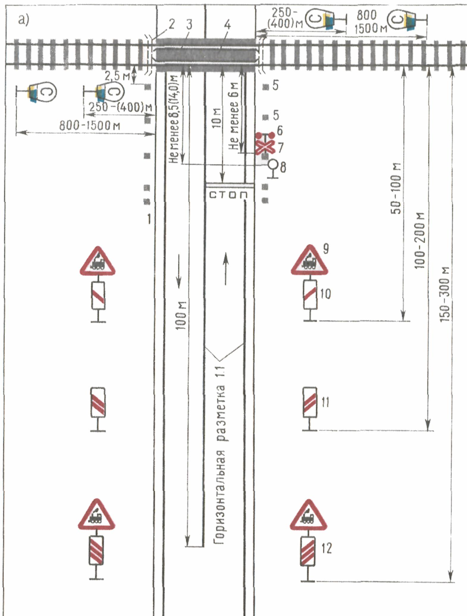
Рис. 3. Расположение обустройств переезда без шлагбаумов:
