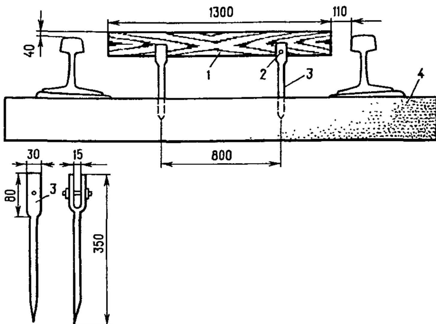
Рис. 1. Приспособление для обнаружения нижней негабаритности в поездах:
