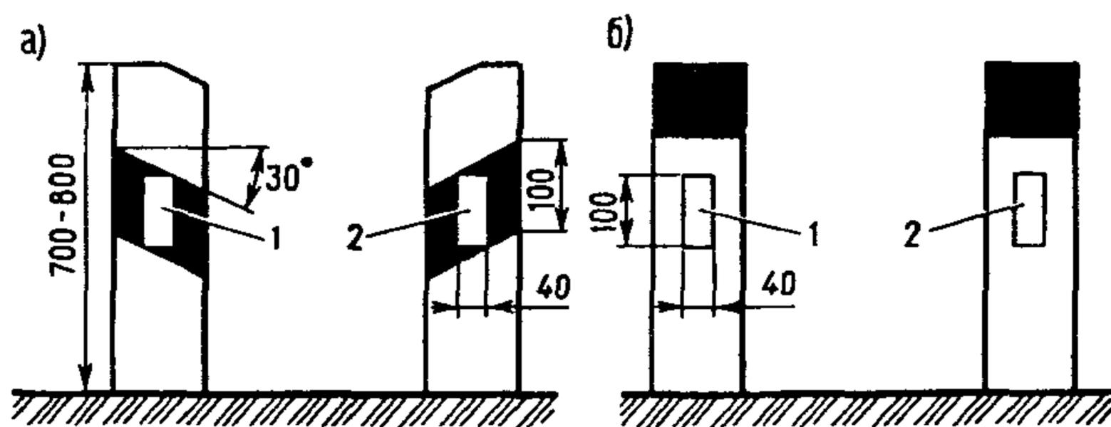
Рис. 2. Направляющие столбики с плоской (а) и цилиндри-
