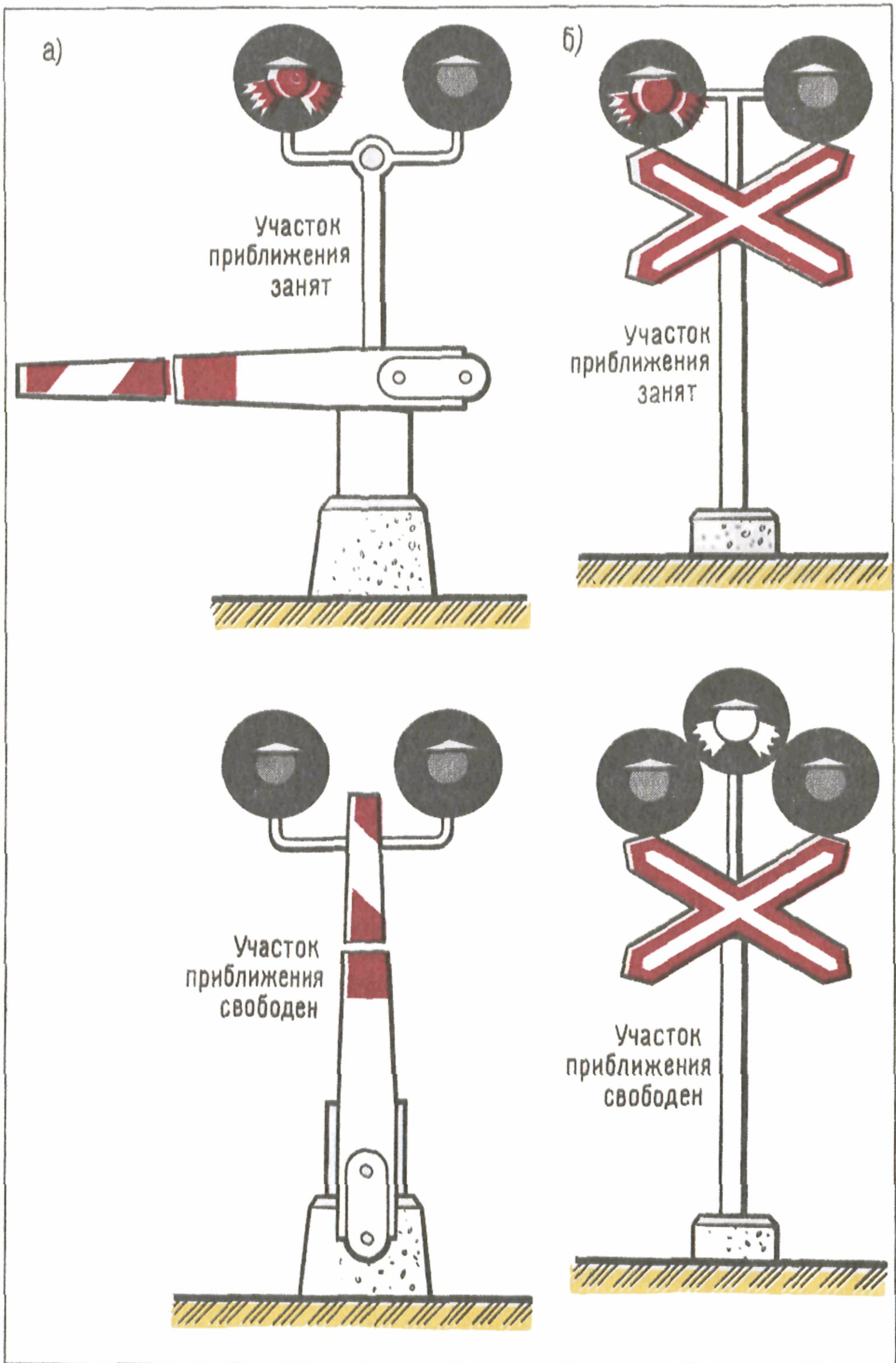
Рис. 5. Переездный светофор на переезде с дежурным (а) и без дежурного (б)
