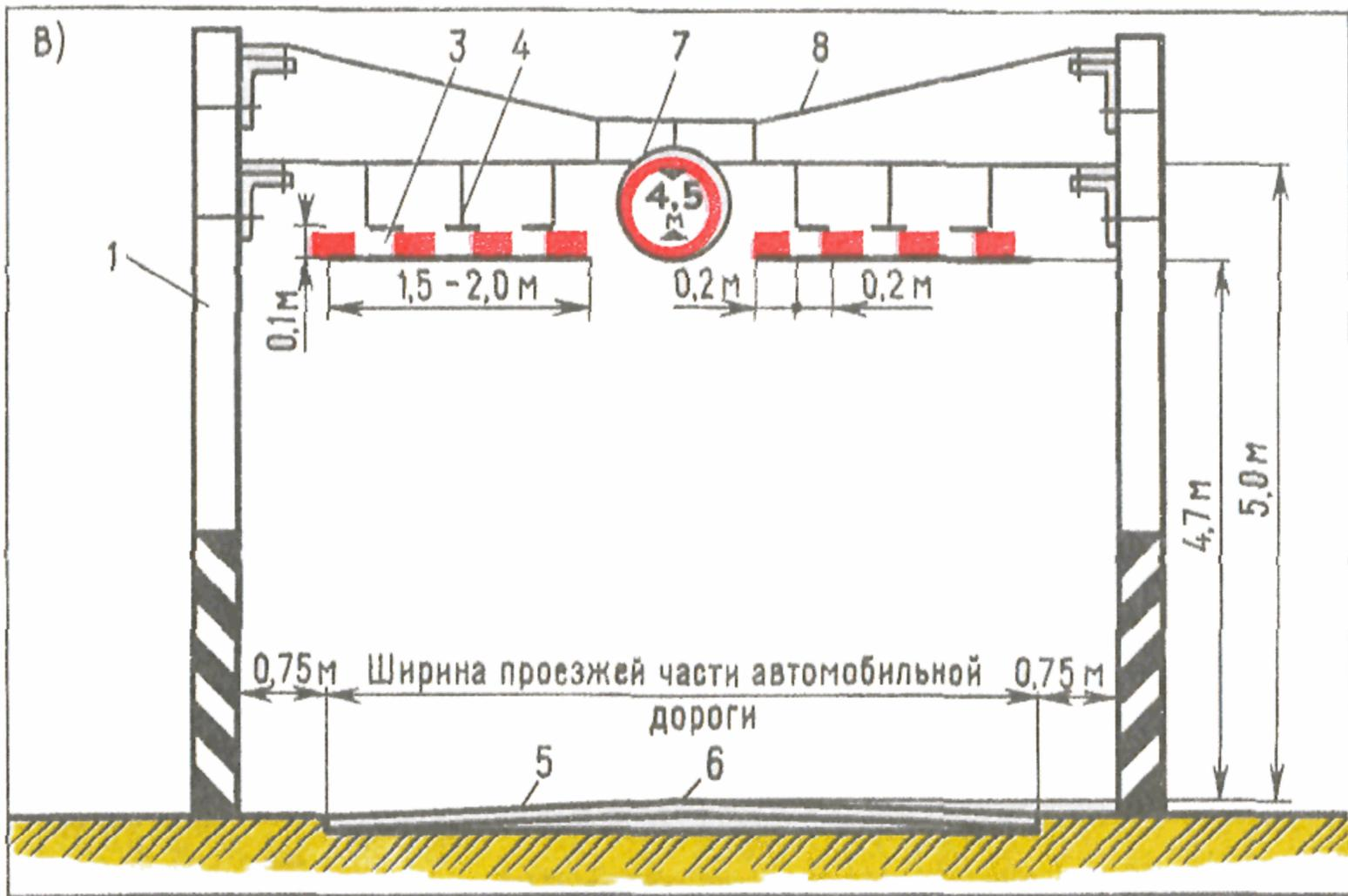
Рис. 4. Габаритные ворота перед искусственными сооружениями:
