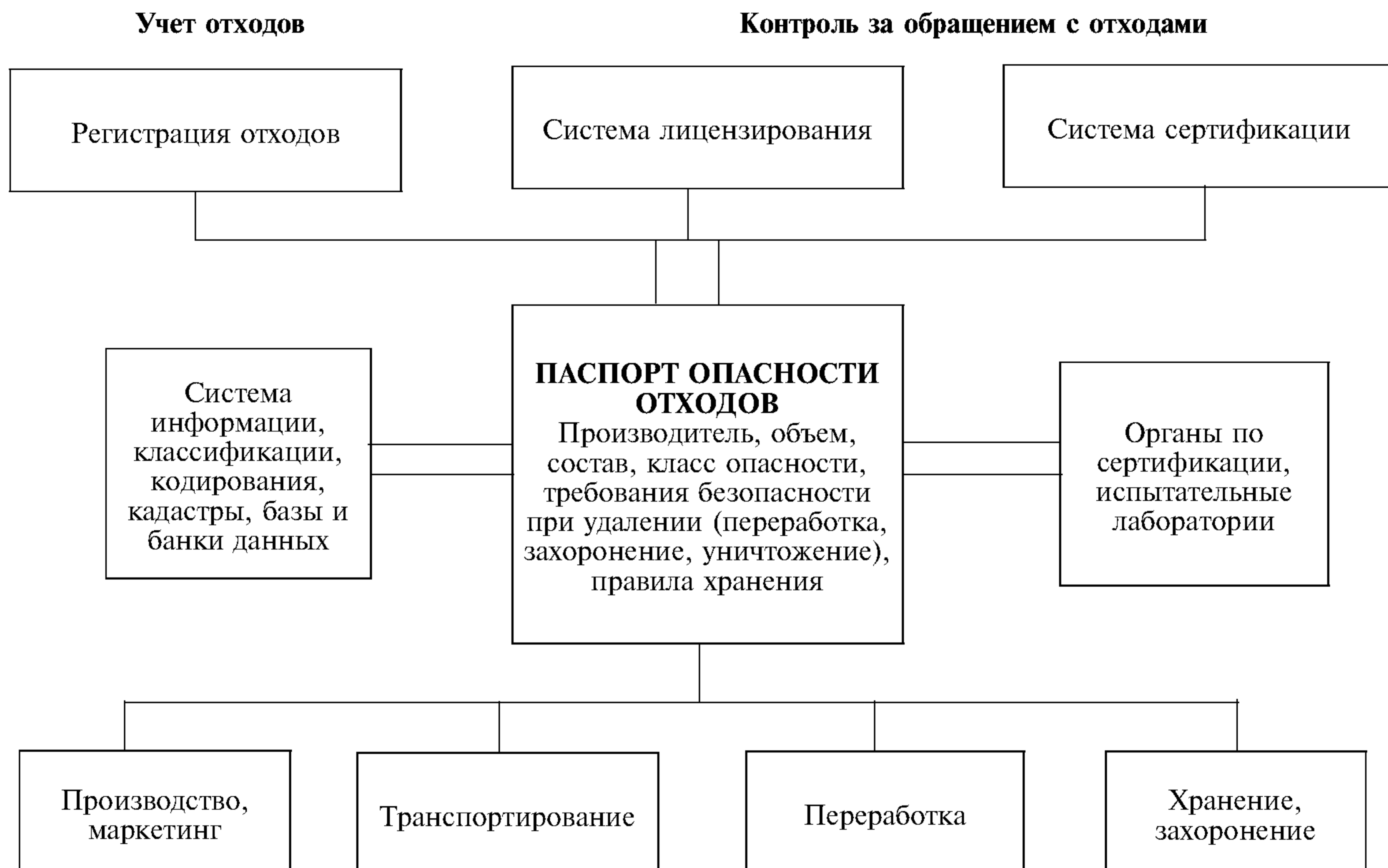
Рисунок 1 — Схема регионального регулирования обращением с отходами на основе их паспортизации и сертификации
