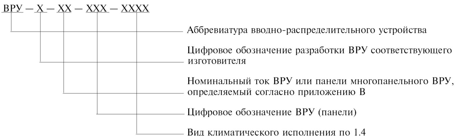
**Примеры обозначений типов панелей многопанельного ВРУ**
