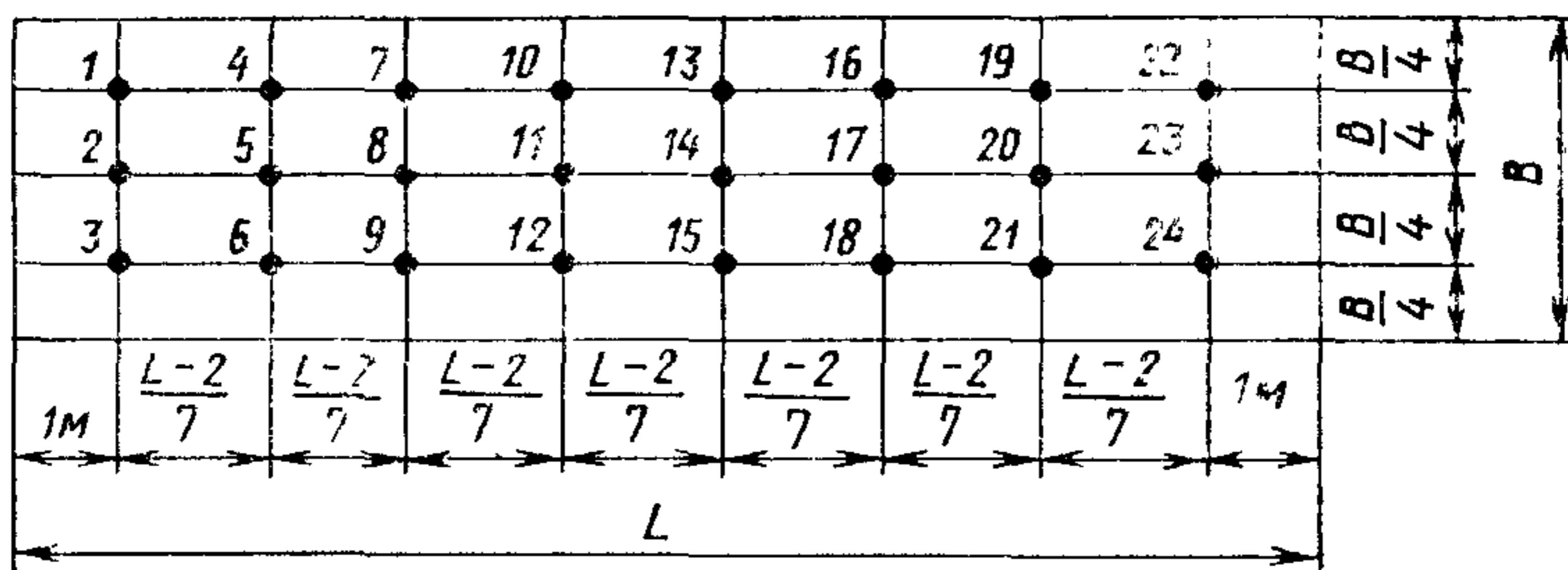
4.1.2. Отобранные точечные пробы объединяют в объединенную пробу, тщательно перемешивают и методом квартования сокращают до средней пробы массой не менее 3 кг.
