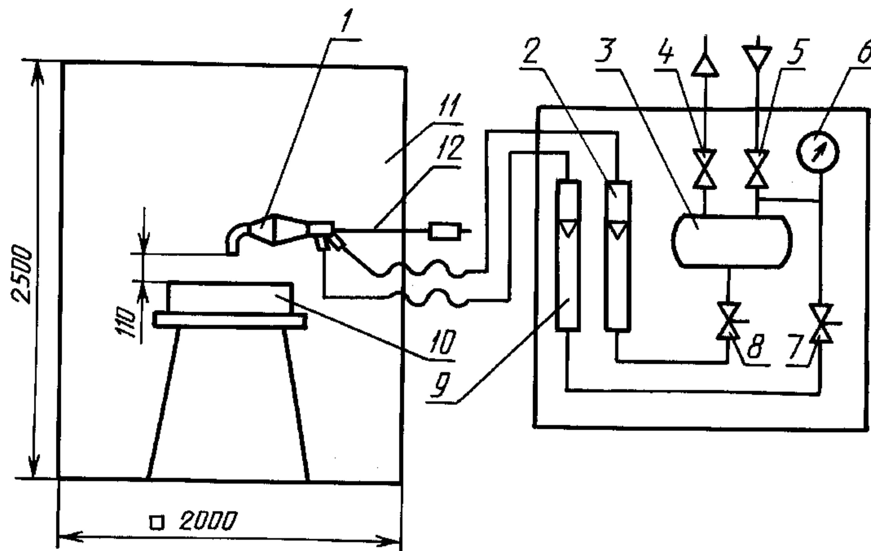
1 — пеногенератор; 2, 9 — ротаметр; 3 — бачок; 4, 5, 7, 8 — клапан; 6 — манометр; 10 — горелка; 11 — ограждение;
