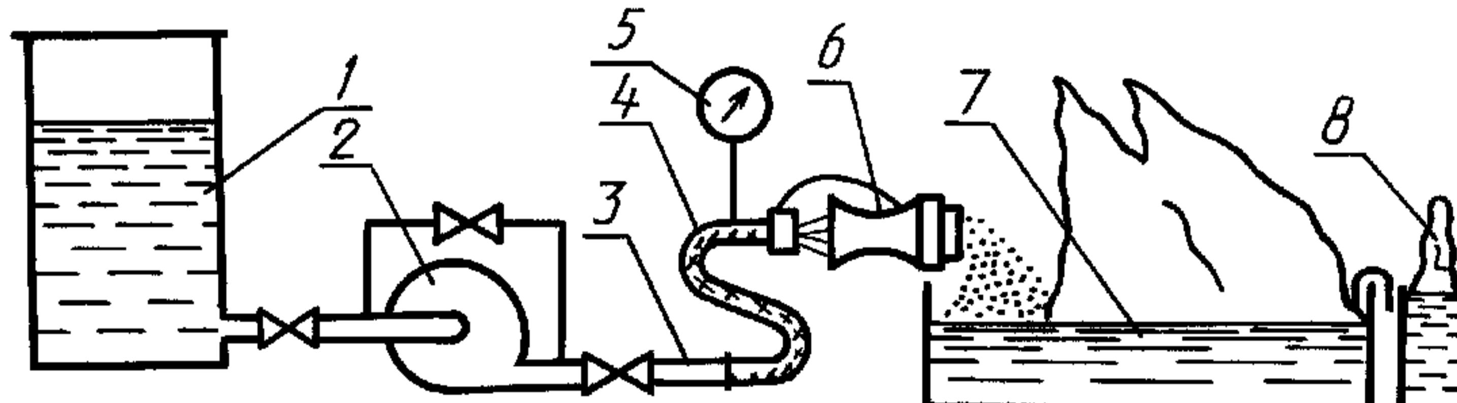
1 — емкость; 2 — насос; 3 — трубопровод; 4 — рукав; 5 — манометр; 6 — пеногенератор; 7 — противень; 8 — тигель
