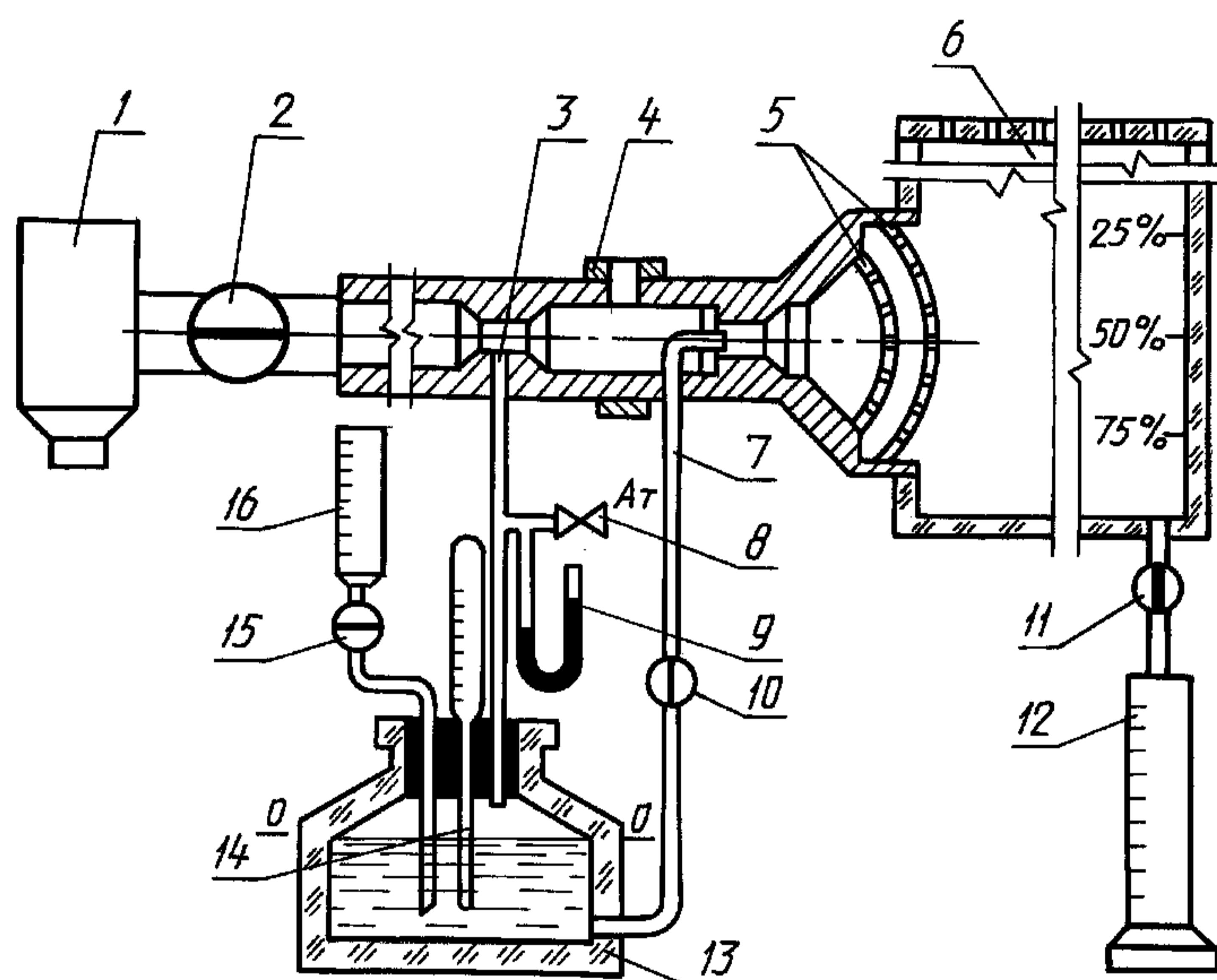
1 — источник воздуха; 2, 10, 11, 15 — кран; 3, 7 — трубка; 4 — заслонка; 5 — сетка; 6 — емкость; 8 — клапан;
