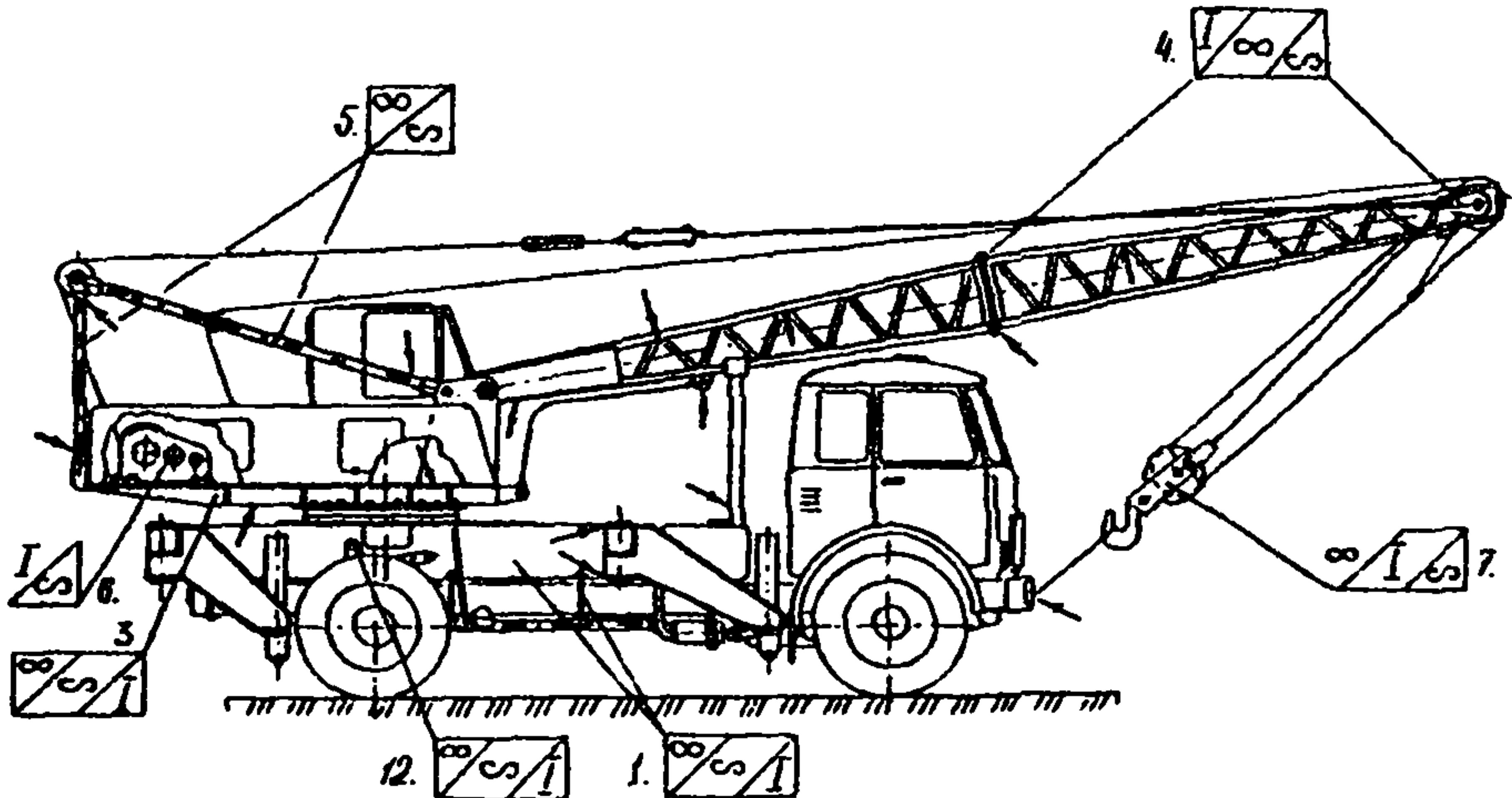
Рис. П 13.5. Схема осмотра автомобильного крана с решетчатой стрелой в транспортной положении
