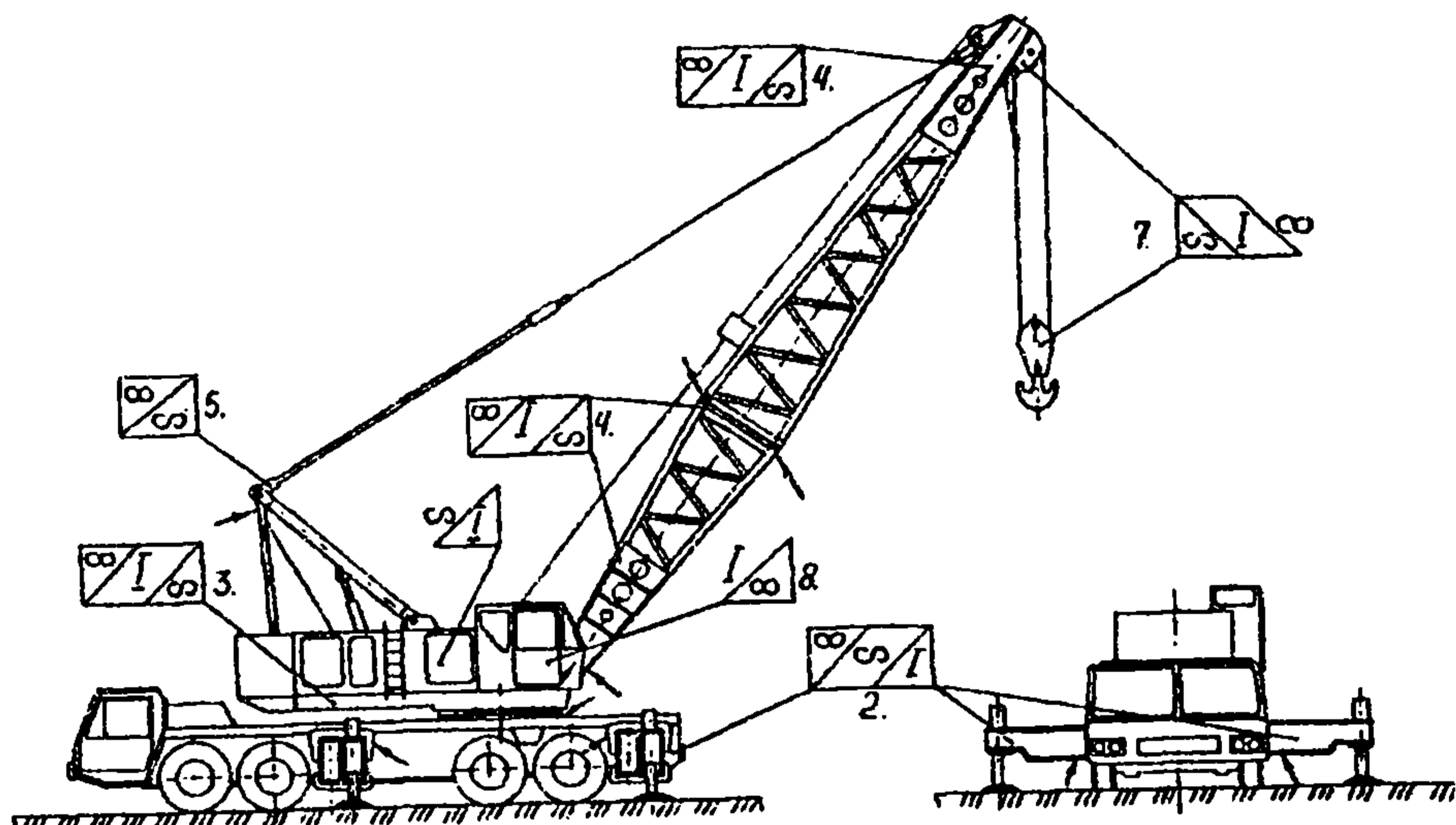
Рис. П 13.6. Схема осмотра крана на спецшасси в рабочем положении
