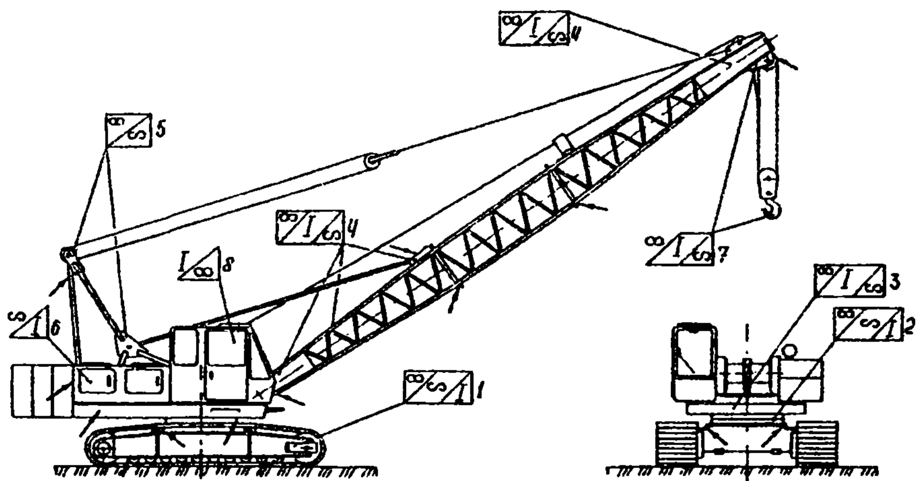
Рис П 13.3. Схема осмотра гусеничного крана
