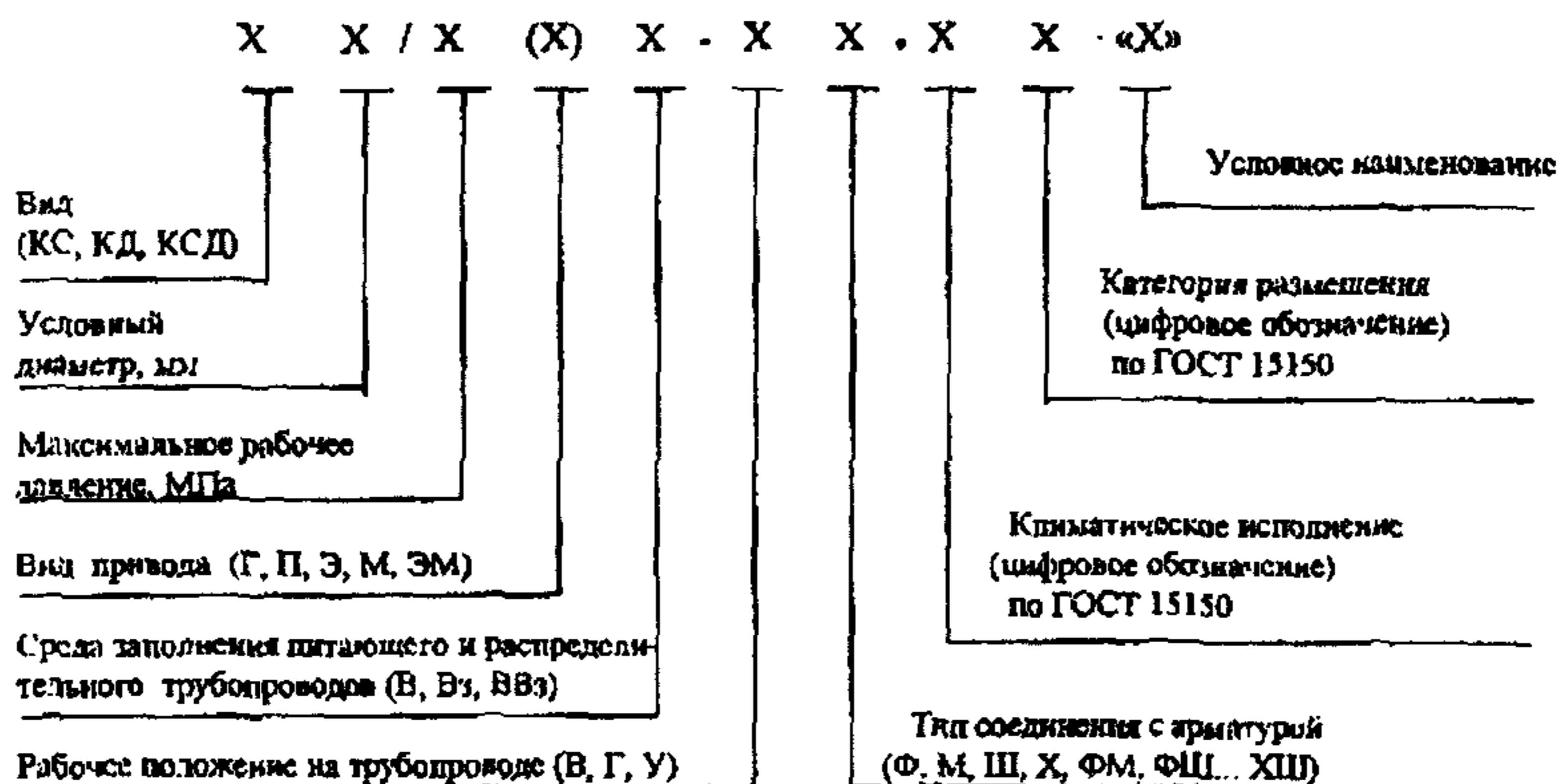
П р и м е ч а н и я. 1. В обозначении спринклерных клапанов тип привода не проставляют.
