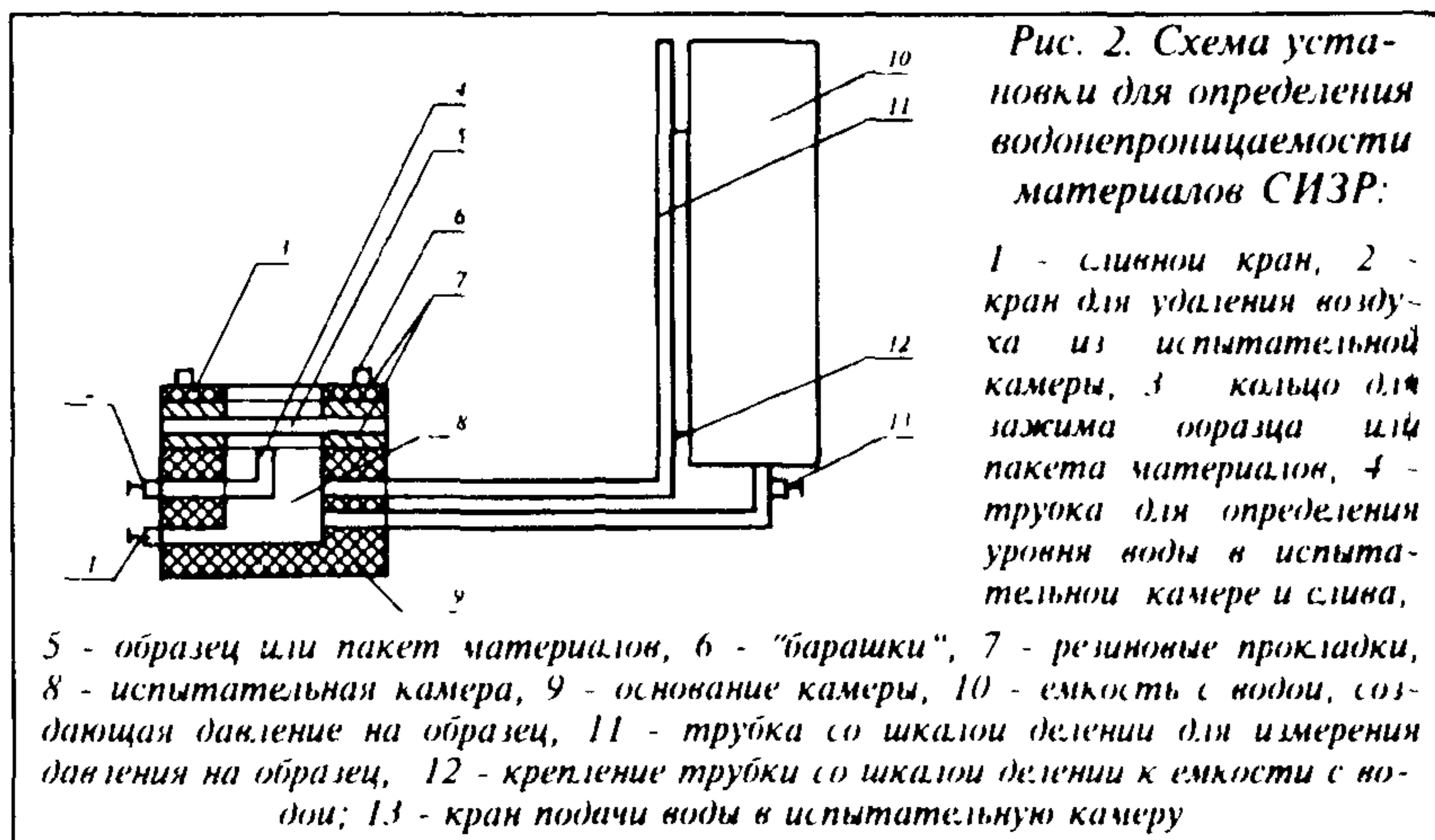
Рис. 2. Схема установки для определения водонепроницаемости материалов СИЗР:
